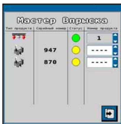
РИС. 5. Назначение значения «Serial Number» (Серийный номер) в окне «Injection Wizard» (Мастер впрыскивания)
