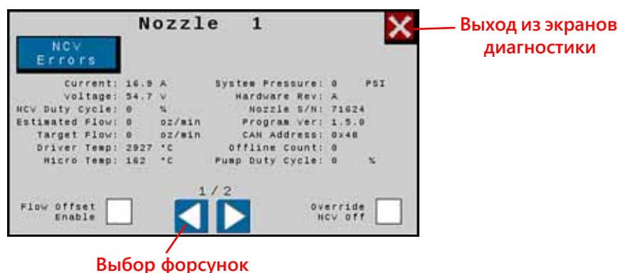
Рис. 2. Расширенная диагностика форсунок
