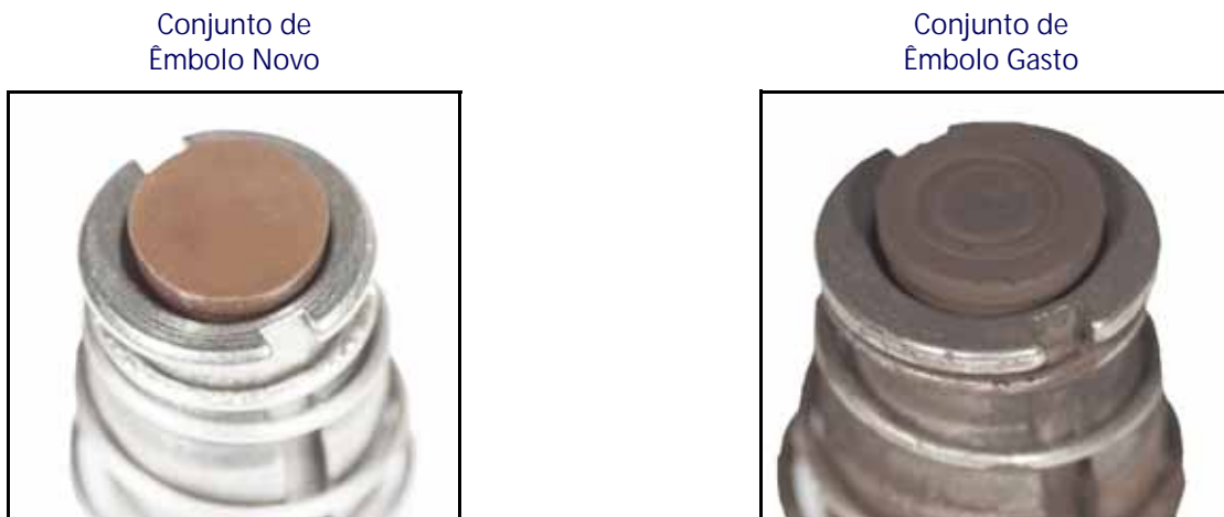
FIGURA 4. Detalhe de Inspeção do Atuador
