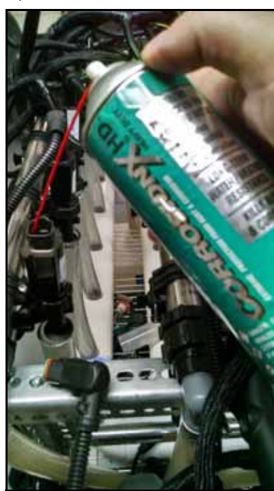
Aplicação de Inibidor de Corrosão
