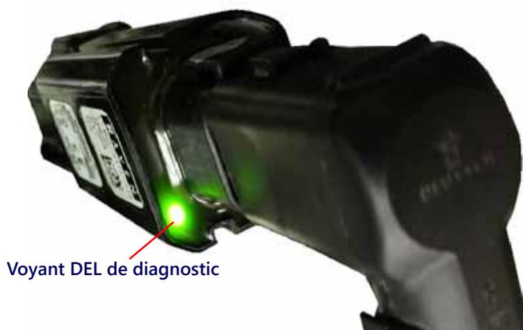
TABLEAU 1. Indicateur DEL de statut de vanne de commande de buse
