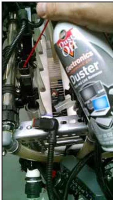
7. Si ce n'est déjà fait, appliquez une seule courte bouffée d'inhibiteur de corrosion (Corrosion X HD (Raven N/P 222-0000-020 ou disponible de <http://www.corrosionx.com/corrosionx-heavy-duty.html>)) dans la connexion
