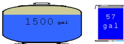
**REMARQUE :** La contenance du réservoir doit être saisie pour permettre à l'indicateur de volume de cuve d'afficher le niveau de la cuve.
