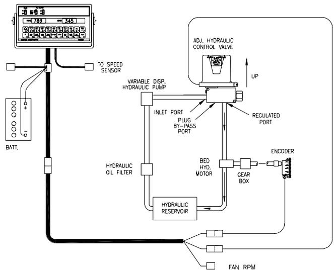
CLOSED HYDRAULIC SYSTEM (VARIABLE DISP. PUMP)
