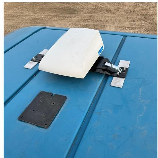
7. Установите круглую клейкую пластину для антенны сотовой связи LAIRD (номер детали 121-0000-042) на расстоянии не более 50 см [20 дюймов] от кронштейна антенного приемника (если применимо).
