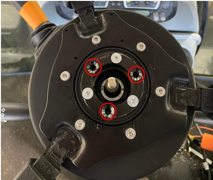
4. Прикрепите съемник рулевого колеса OTC 7403 с помощью болтов M5 x 0,8 x 100+ мм к узлу DirecSteer. Используйте прилагаемую приставку (номер детали 305-1001-011) для защиты телескопического штока (где применимо).
