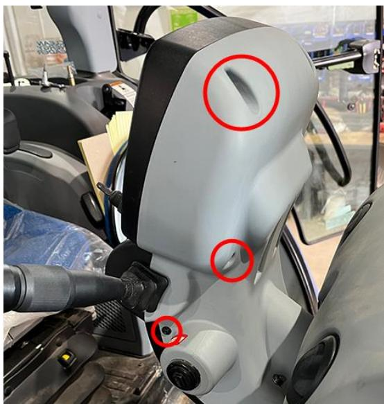
25. Удалите на место два винта в нижней части передней панели.
