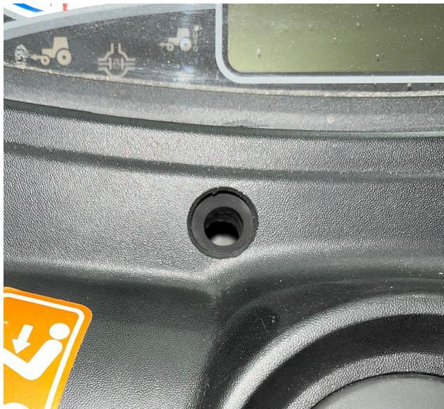
20. Если втулка правильно совмещена с отверстием, снимите передний кожух и затяните болты, удерживающие хомут блокировки вращения.
