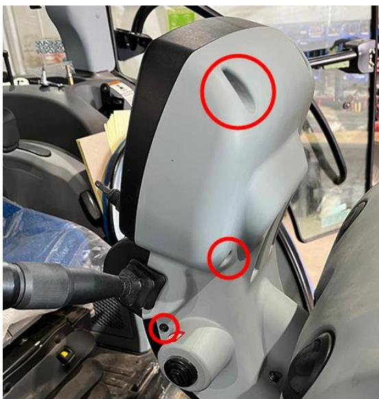
3. Удалите два винта, расположенные в нижней части передней панели.
