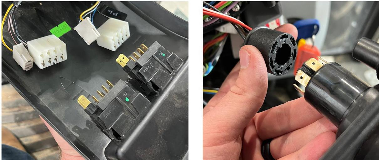
6. Снимите пылезащитный уплотнитель (если применимо).
