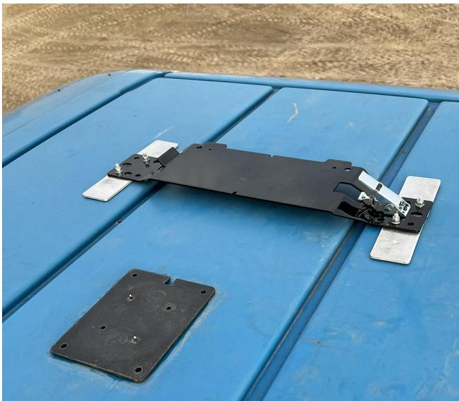
6. Закрепите антенный приемник на кронштейне приемника так, чтобы антенный приемник был обращен к передней части машины.
