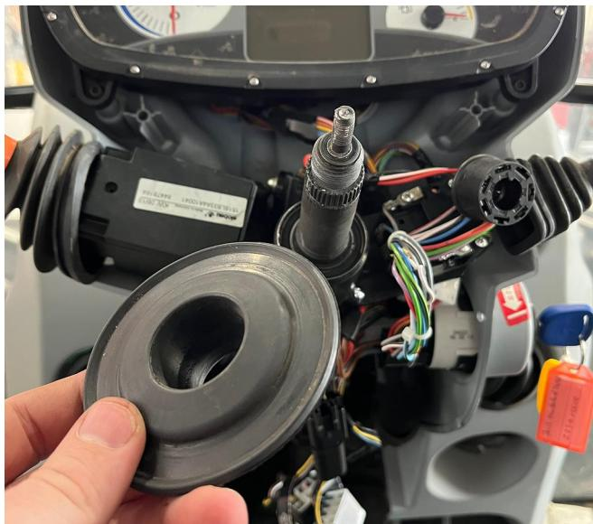
22. Подсоедините три соединения между передней панелью и жгутом проводов.
