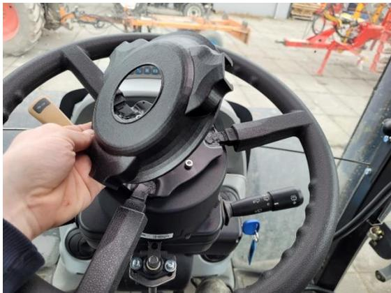
7. Установите ручку фиксации телескопического механизма и, далее, шайбу M8 на резьбовой стержень.
