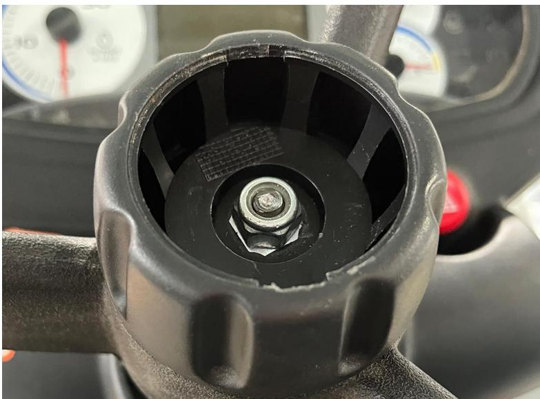
3. Снимите стопорную ручку и проставку.
