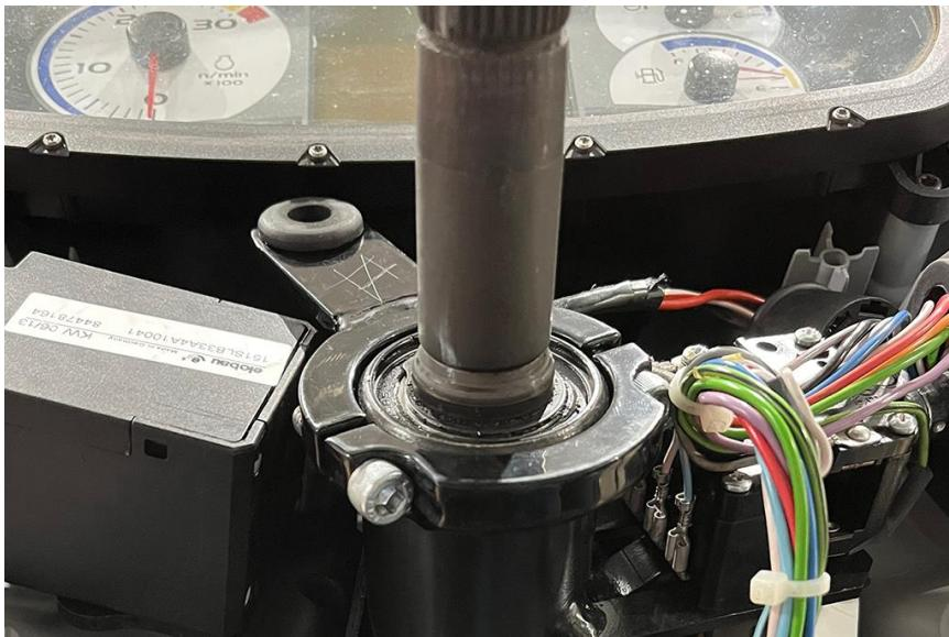
**Примечание:** Для машин с механическими переключателями передач, возможно, потребуется, чтобы фланец располагался вплотную к приборной панели.
