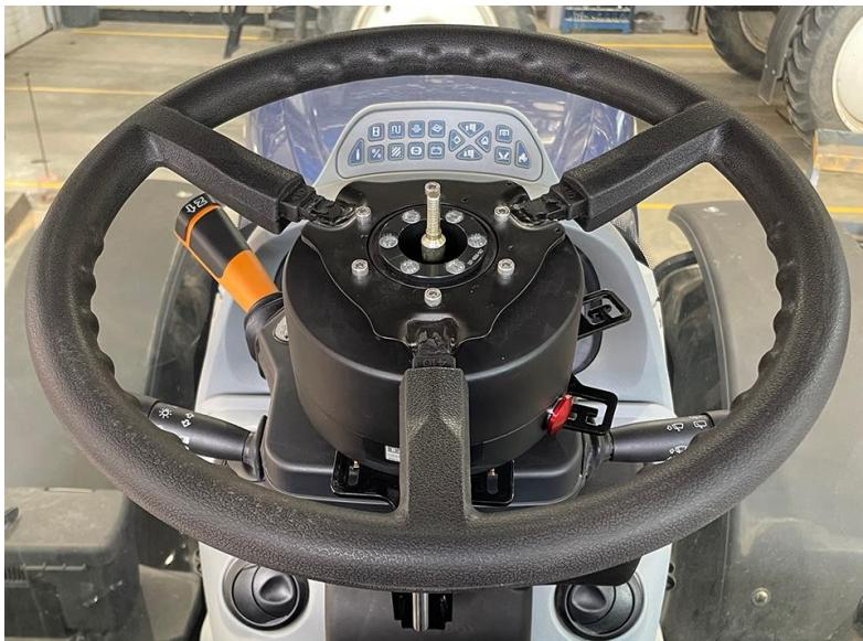
2. Снимите гайку и шайбу рулевой колонки.
