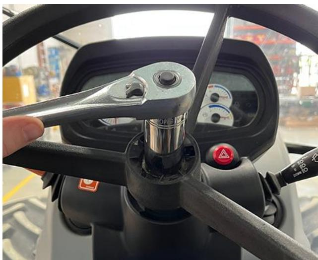
5. Снимите рулевое колесо, используя съемник рулевого колеса и болты M6x1,0. Используйте прилагаемую проставку (номер детали 305-1001-011) для защиты телескопического штока во время снятия.
