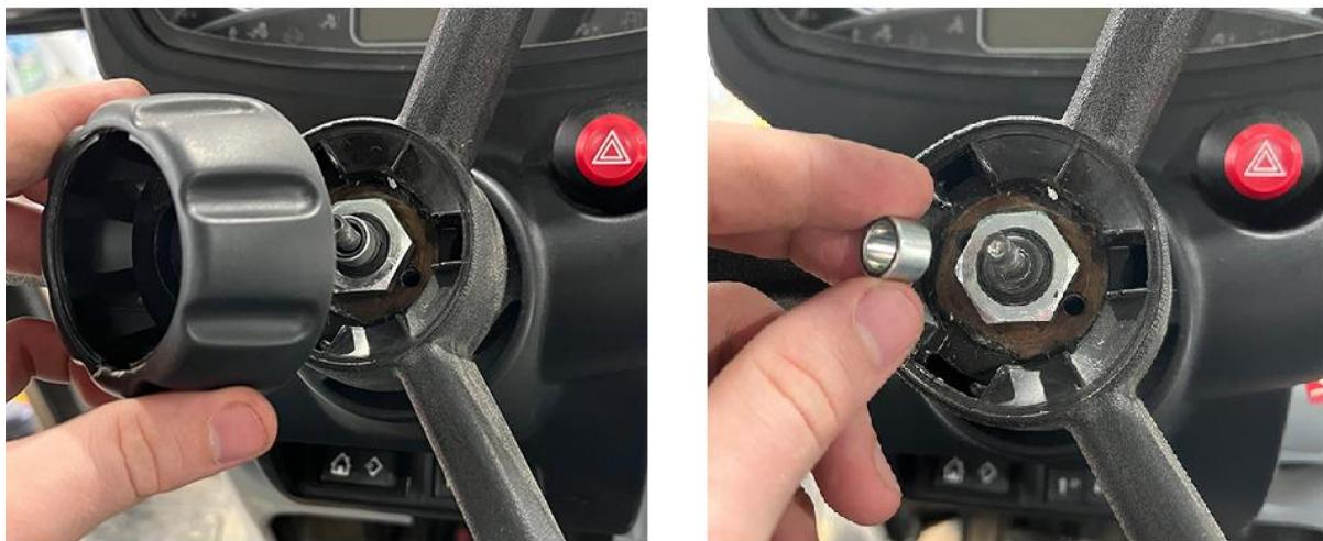
4. Снимите большую шестигранную гайку с помощью торцевой головки на 27 мм.
