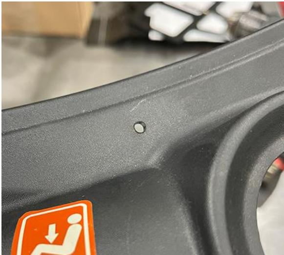
18. Увеличьте диаметр отверстия до 14,5 мм или 9/16 дюйма с помощью ступенчатого сверла.
