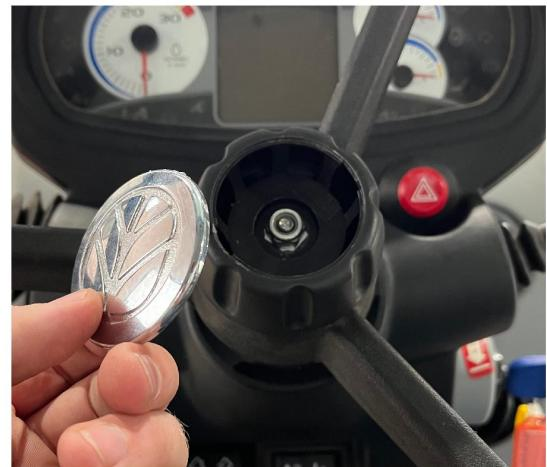
2. Если машина оснащена механизмом телескопической регулировки рулевого колеса, для откручивания шестигранной гайки используйте торцевую головку на 13 мм.
