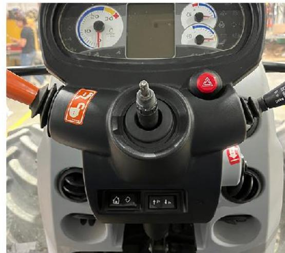
**Примечание:** С системой DirecSteer не используются рулевое колесо заводской комплектации и его компоненты. Рекомендуется сохранить эти компоненты на тот случай, если система DirecSteer будет снята или перенесена на другую машину..
