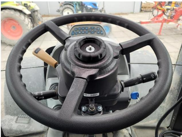
8. Закрепите ручку на адаптере телескопического механизма с помощью стопорной гайки M8 и торцевой головки на 13 мм.
