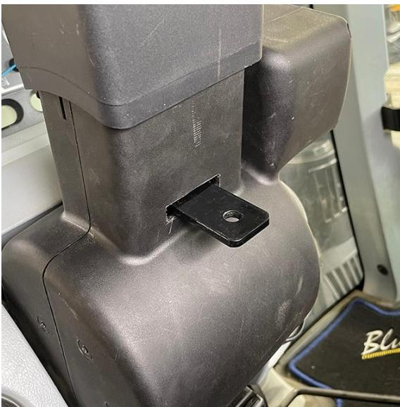
10. Возьмите кронштейн втулки (номер детали 116-4050-061), втулку (номер детали 315-0000-034), болт (номер детали 311-4035-055K) и гайку (номер детали 312-4003-016K).
