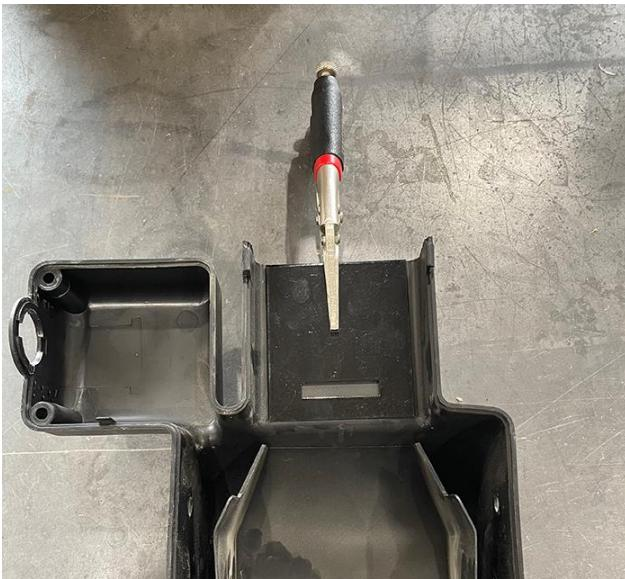
9. Поместите защитные панели на хомут блокировки вращения и закрепите их с помощью заводского крепежа.
