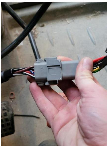
15. Подсоедините 18-контактный разъем жгута полевого компьютера (номер детали 115-7325-051/052) к ответному разъему на тройнике приемника (номер детали 115-7325-021).
