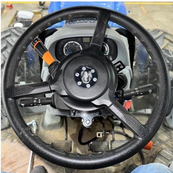
8. Установите ручку фиксации телескопического механизма на резьбовой стержень удлинителя телескопического штока.
