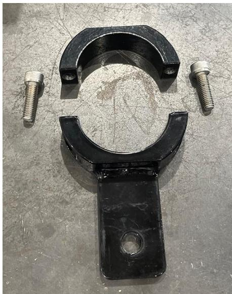
6. Расположите фланцевый хомут рулевой колонки (номер детали 063-4001-046) вокруг круглого участка рулевой колонки.
