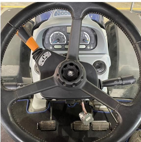
3. Снимите гайку, удерживающую рулевое колесо на рулевой колонке.
