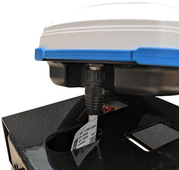
**Примечание:** Разъем проще подсоединить до того, как антенна будет прикреплена к кронштейну на крыше.
