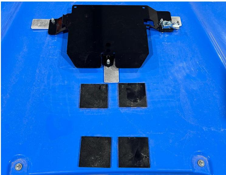
6. Закрепите антенный приемник на кронштейне приемника так, чтобы антенный приемник был обращен к передней части машины.
