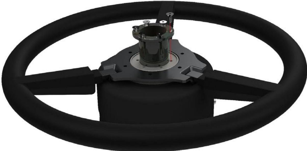
2. Установите синюю кнопку отключения вспомогательного двигателя (номер детали 107-0172-837), плотно вставив ее в отверстие на боковой стороне узла DirecSteer.
