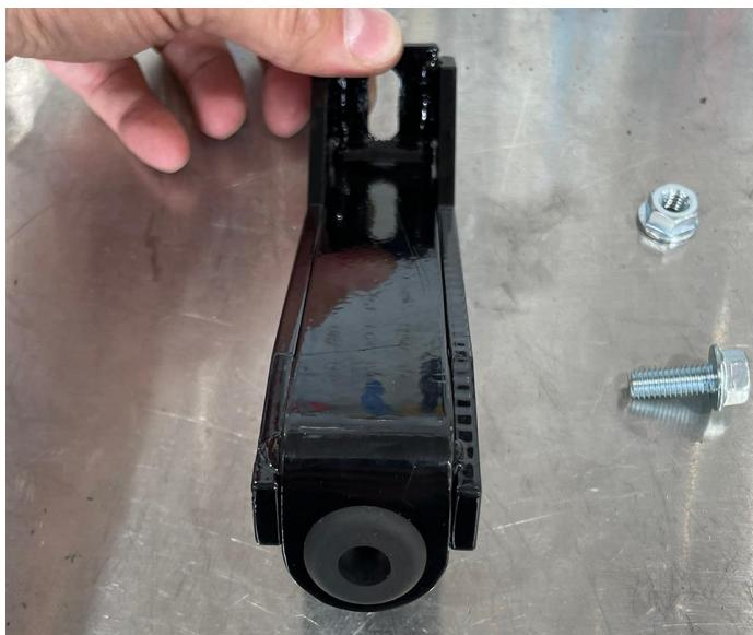
12. Установите кронштейн втулки (номер детали 116-4050-061) на фланцевый хомут рулевой колонки, используя болт M8 (номер детали 311-4035-055) и гайки (номер детали 312-4003-016K).
