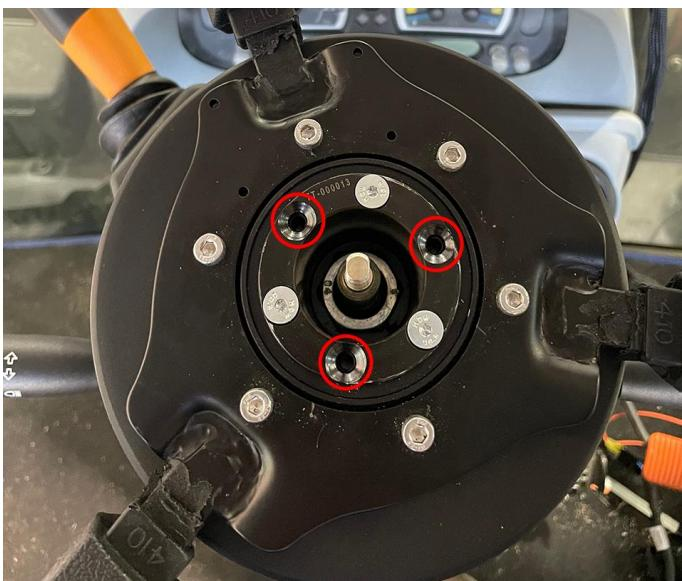
4. Прикрепите съемник рулевого колеса OTC 7403 с помощью болтов M5 x 0,8 x 100+ мм к узлу DirecSteer. Используйте прилагаемую проставку (номер детали 305-1001-011) для защиты телескопического штока (где применимо).
