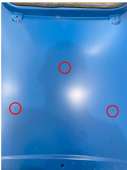
3. Просверлите отверстия диаметром 9 мм в полученных метках.
