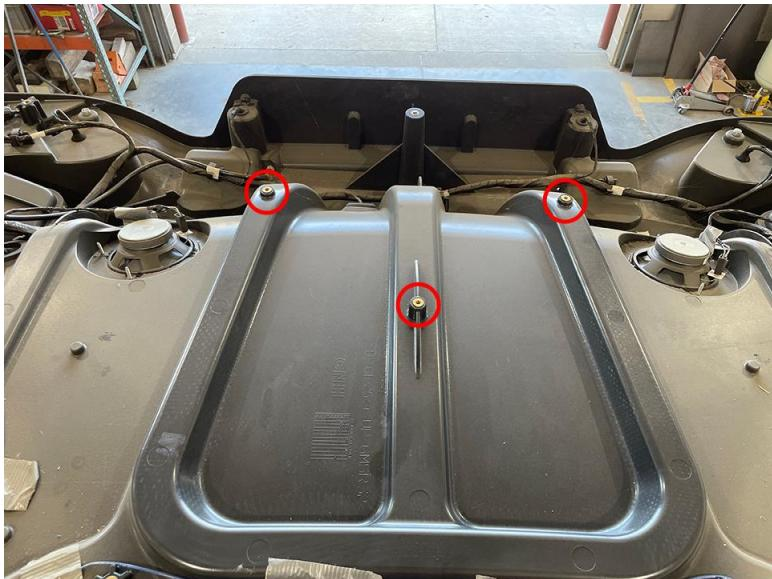
**Примечание:** Если под панелью крыши нет закладных гаек, необходимо установить заклепки на машину. См. "Крепление с добавлением заклепочных гаек на крышу" на странице 59 для получения дополнительной информации.
