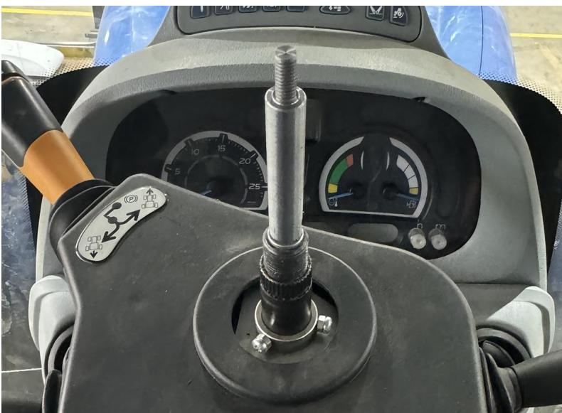
2. Присоедините узел DirecSteer к рулевой колонке, одновременно вставив шток блокировки вращения (номер детали 063-4001-045) во втулку, установленную в кронштейне втулки (номер детали 116-4050-061).
