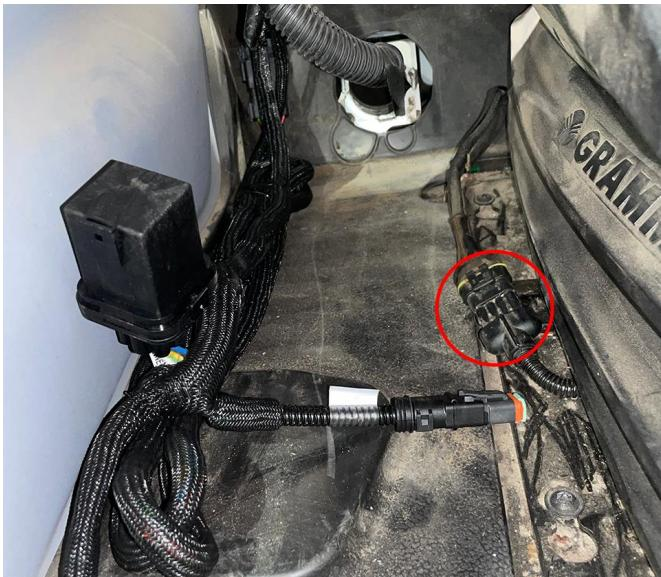
12. Подсоедините жгут двигателя (номер детали 115-4001-258) к электрическому гнезду на узле DirecSteer.
