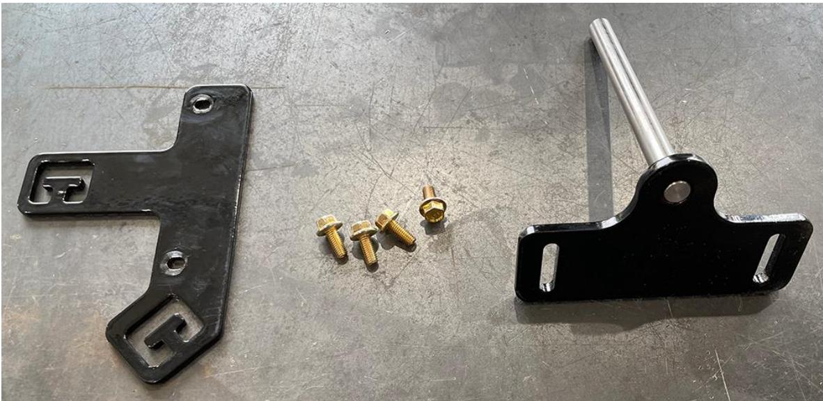
2. Разместите кронштейн для проводки (номер детали 107-4001-093) на узле DirecSteer в положении «10 часов» и закрепите его двумя прилагаемыми болтами M5 x 12 (номер детали 311-4035-002K).
