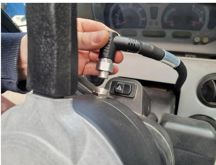
13. Проложите жгут двигателя DirecSteer (номер детали 115-4001-258) по кронштейну для проводки. Скрепите проводку кабельными стяжками согласно необходимости.
