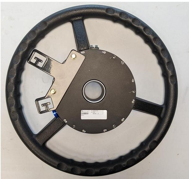
3. Зафиксируйте, не затягивая, шток блокировки вращения (номер детали 063-4001-045) на узле DirecSteer в положении «6 часов» с помощью двух прилагаемых болтов (номер детали 311-4035-002K).
