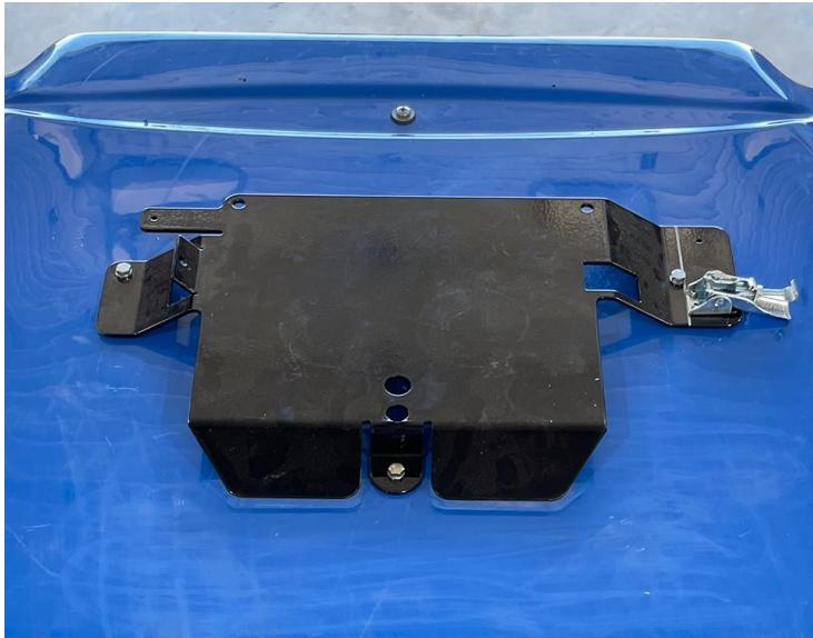
6. Закрепите запорную пластину на монтажном кронштейне.
