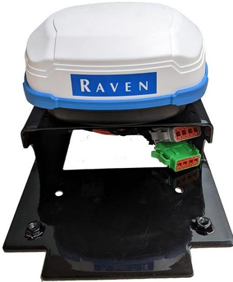
5. Подсоедините 12-контактные разъемы DTM жгута проводов 500S™/SC1™ к ответным разъемам на блоке SC1™/TC1™.
