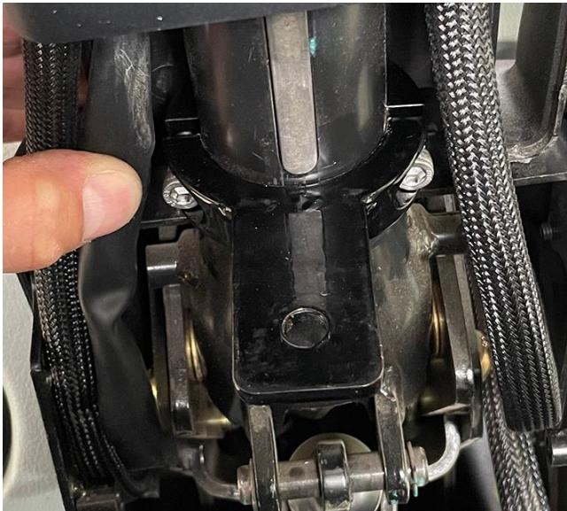
**Примечание:** Хомут рулевой колонки должен быть обращен фланцем к рулевому колесу, как показано на рисунке выше.
