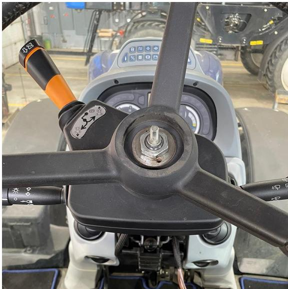
4. Используйте съемник рулевого колеса OTC 7403 с болтами M6 x 1,0 x 100+ мм для снятия рулевого колеса. Используйте прилагаемую проставку (номер детали 305-1001-011) для защиты телескопического штока во время снятия.
