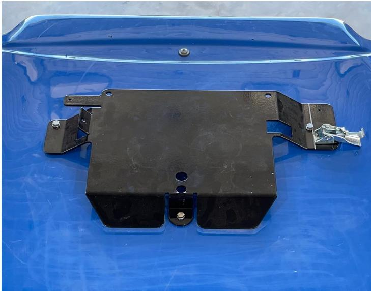
7. Закрепите запорную пластину на монтажном кронштейне.
