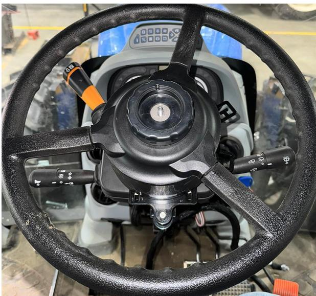
9. Затяните ручку адаптера телескопического механизма с помощью шайбы M8 и контргайки M8.
