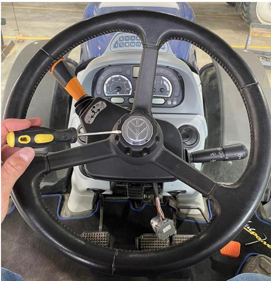
2. Снимите гайку, удерживающую ручку телескопического механизма, и снимите ручку телескопического механизма.
