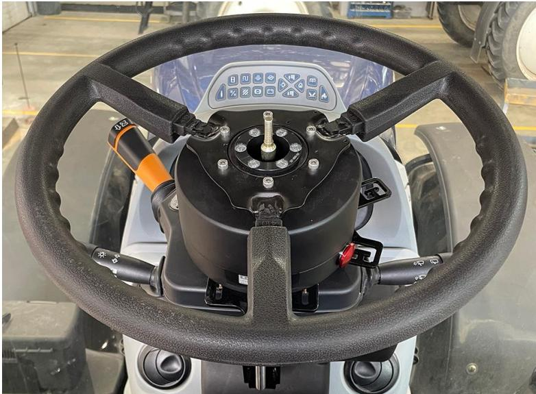
2. Снимите гайку и шайбу рулевой колонки.
