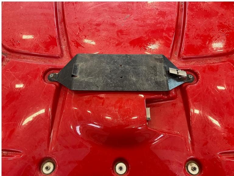
2. Прикрепите антенный приемник к монтажному кронштейну так, чтобы передняя часть антенны была обращена к передней стороне машины. Закрепите antennu на кронштейне защелкой.
