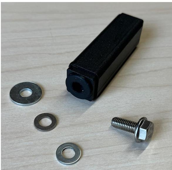
7. Используя болт M8 и шайбы, закрепите держатель втулки на фланцевом хомуте рулевой колонки.
