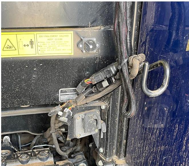
3. Подсоедините тройник приемника (номер детали 115-7325-041) к ранее проложенному 18-контактному разъему на проводе аккумулятора (номер детали 115-7325-001/012).
