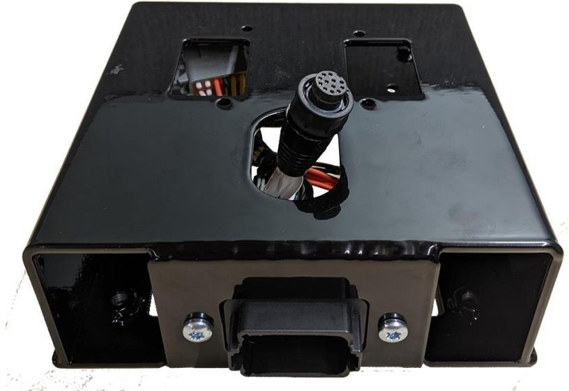
3. Подсоедините круглый 12-контактный разъем к приемнику 500S™ (номер детали 063-2000-006/-013).
