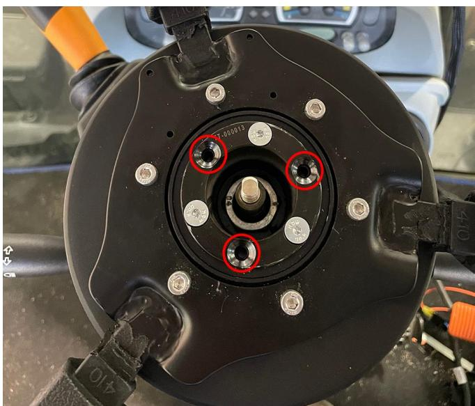
4. Прикрепите съемник рулевого колеса OTC 7403 с помощью болтов M5 x 0,8 x 100+ мм к узлу DirecSteer. Используйте прилагаемую прокладку (номер детали 305-1001-011) для защиты телескопического штока (где применимо).
