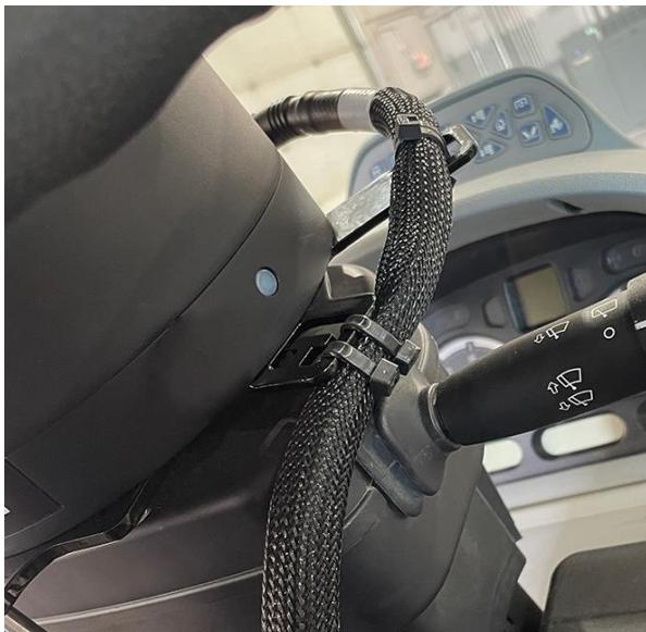
14. Проложите 8-контактный разъем жгута двигателя DirecSteer (номер детали 115-4001-258) к ответному разъему с маркировкой «DirecSteer Motor Cable» на основном жгуте DirecSteer (номер детали 115-7325-021).
