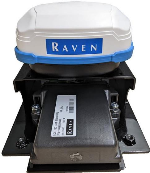
7. Прикрепите кронштейн для крыши (номер по детали 116-4001-001) к кронштейну стационарного крепления RS1™ (номер детали 107-0172-498) с помощью четырех прилагаемых винтов с потайной головкой M6 x 16 (номер детали 311-4073-134), используя ключ-шестигранник на 4 мм.
