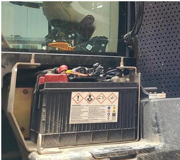
**Примечание:** Обычно аккумуляторный отсек расположен с правой стороны трактора, перед задним колесом, под кабиной трактора или рядом с ней.
