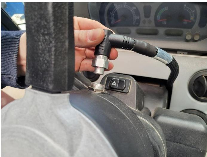
13. Проложите жгут двигателя DirecSteer (номер детали 115-4001-258) по кронштейну для проводки. Скрепите проводку кабельными стяжками согласно необходимости.
