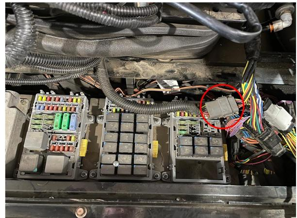
12. Подсоедините жгут двигателя (номер детали 115-4001-258) к электрическому гнезду на узле DirecSteer.
