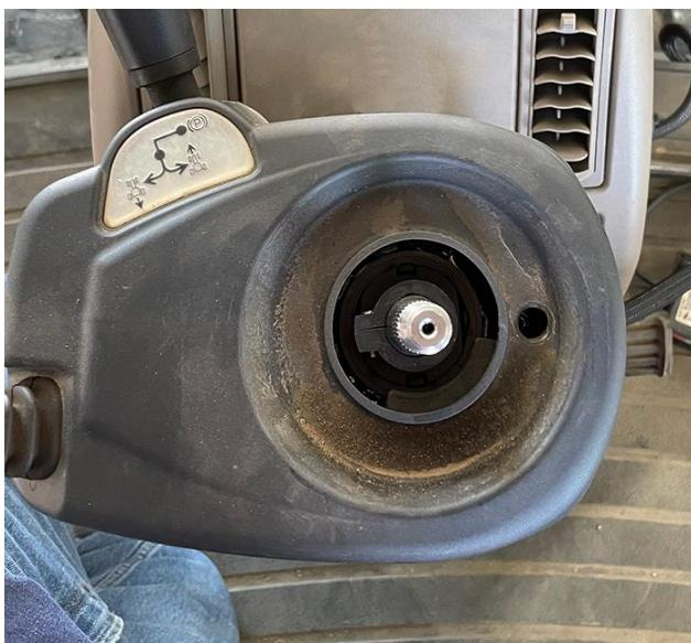
**Примечание:** С системой DirecSteer не используются рулевое колесо заводской комплектации и его компоненты. Рекомендуется сохранить эти компоненты на тот случай, если система DirecSteer будет снята или перенесена на другую машину..
