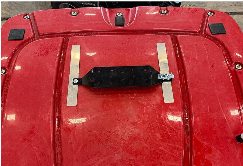
6. Закрепите антенный приемник на кронштейне приемника так, чтобы антенный приемник был обращен к передней части машины.
