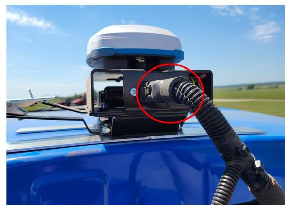
6. В кабине соедините 18-контактный разъем тройника приемника (номер детали 115-7325-041) с ответным разъемом кабинного жгута DirecSteer (номер детали 115-7325-021).
