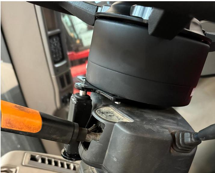
2. Установите ранее снятую гайку, использовавшуюся для крепления заводского рулевого колеса, и три прилагаемые шайбы (номер детали 313-6000-025K) на резьбовой конец рулевой колонки. Затяните гайку моментом 50 Н·м.
