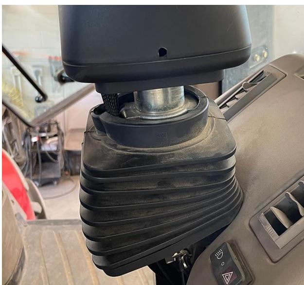
5. Закрепите, не затягивая, хомут рулевой колонки (номер детали 116-4050-051) на внутренней части рулевой колонки так, чтобы фланец был обращен вверх. Закрепите элемент с помощью прилагаемого крепежа, не затягивая.
