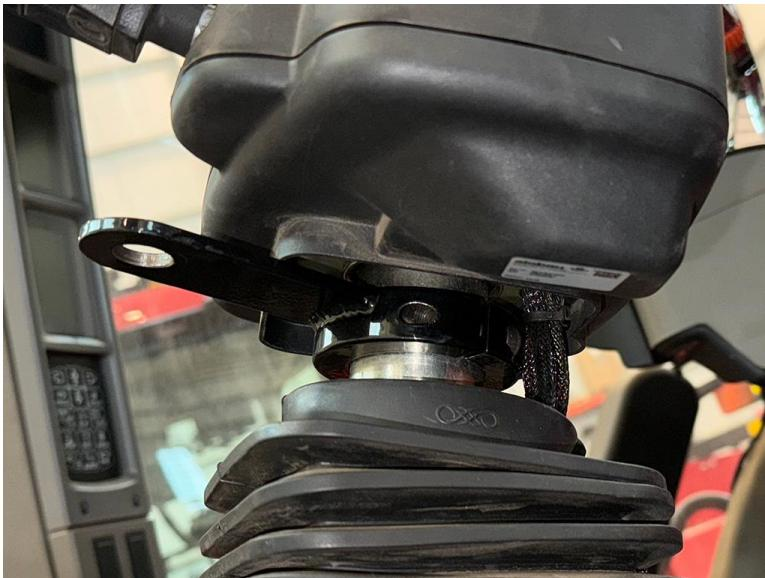
**Примечание:** Хомут рулевой колонки можно дополнительно выровнять во время установки. Рекомендуется **не** затягивать крепеж на этом этапе.
