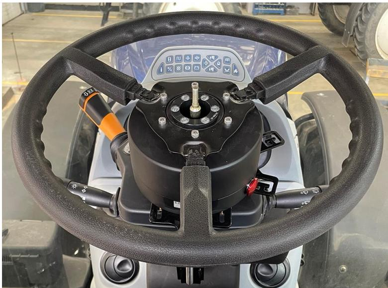
2. Снимите гайку и шайбу рулевой колонки.
