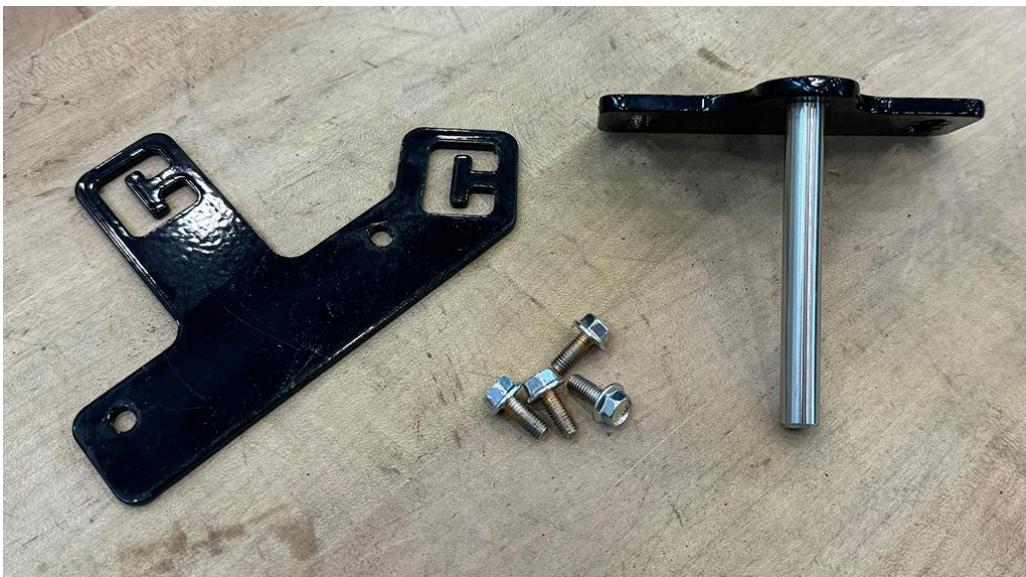
2. Разместите кронштейн для проводки (номер детали 107-4001-093) на узле DirecSteer в положении «10 часов» и закрепите его двумя прилагаемыми болтами M5 x 12 (номер детали 311-4035-002K).
