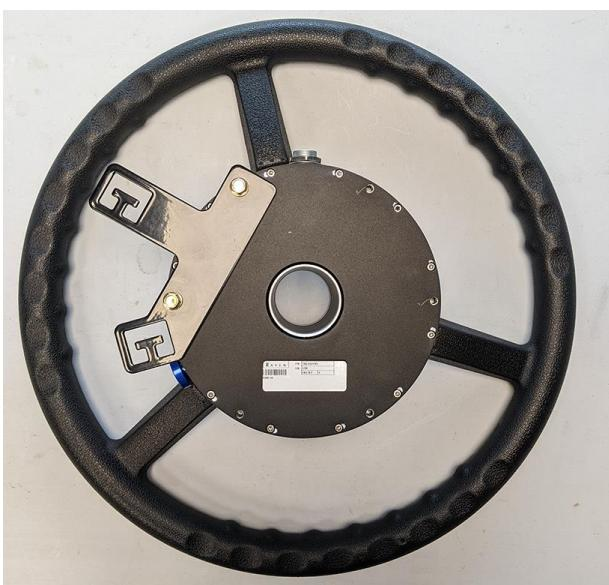
3. Зафиксируйте, не затягивая, шток блокировки вращения (номер детали 063-4001-098) на узле DirecSteer в положении «2 часа» с помощью двух прилагаемых болтов (номер детали 311-4035-002K).
