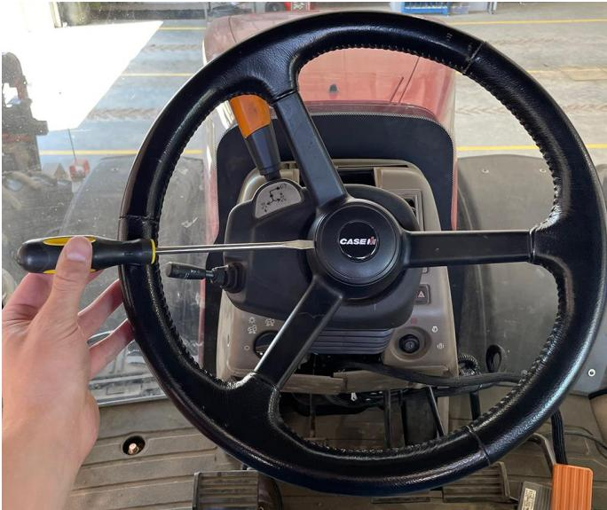
2. Снимите гайку крепления рулевого колеса к рулевой колонке, используя торцевую головку на 22 мм.
