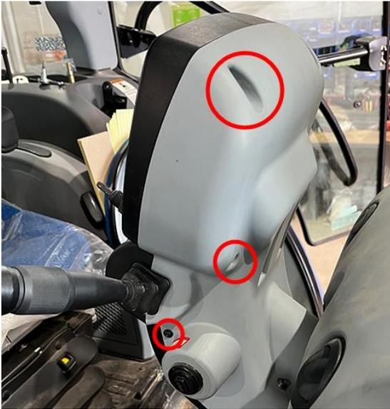
3. Remova os dois parafusos localizados na parte inferior do painel frontal.
