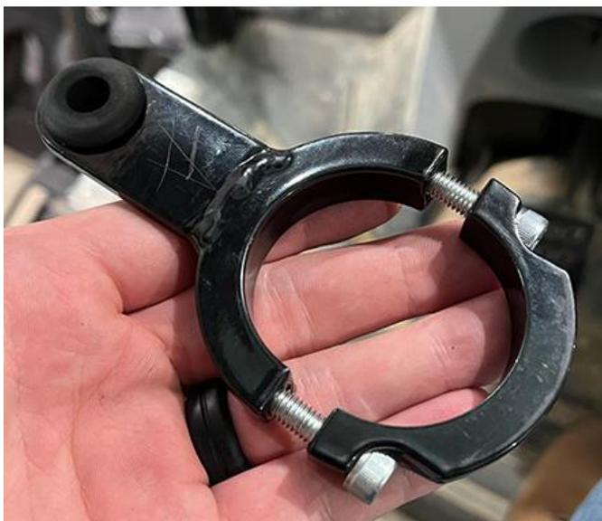
9. Com o lado chanfrado voltado para baixo, coloque o grampo antirrotação ao redor da coluna de direção.
