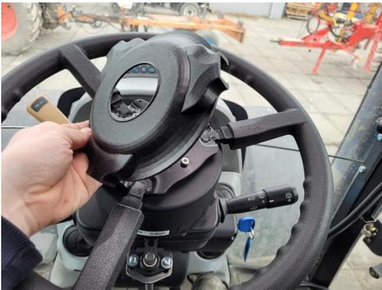
7. Coloque o botão de travamento do telescópio seguido da arruela M8 na haste rosqueada.
