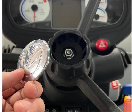
2. Se a máquina estiver equipada com um volante telescópico, use um soquete de 13 mm para remover a porca sextavada.
