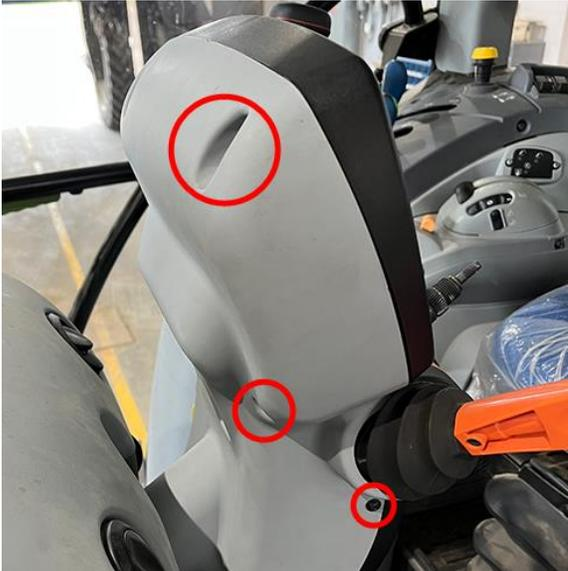
24. Reinstale os três parafusos localizados no lado direito e na parte traseira do console.
