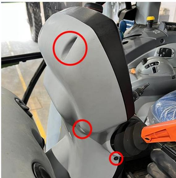
2. Remova os três parafusos localizados no lado direito e na parte traseira do console.
