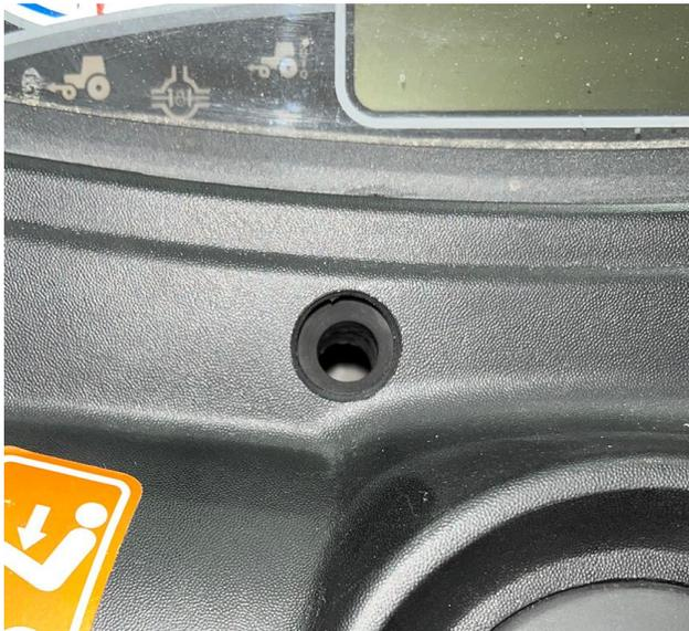
20. Se o anel isolante estiver alinhado corretamente com o furo, remova a tampa frontal e aperte os parafusos que prendem o grampo antirrotação.
