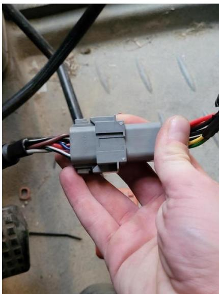
15. Acople o conector de 18 pinos do chicote do computador de campo (código de peça 115-7325-051/052) ao conector correspondente do cabo T do receptor (código de peça 115-7325-021).
