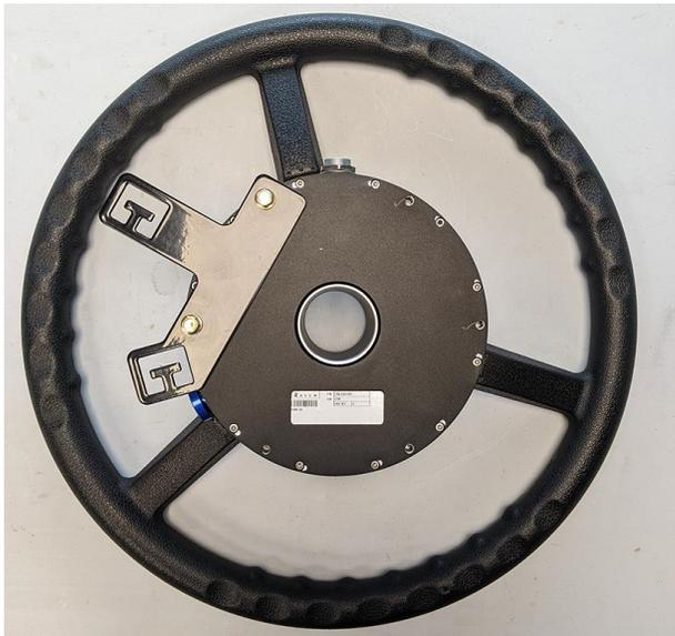
2. Abaixe cuidadosamente o conjunto da DirecSteer sobre o eixo de direção. Certifique-se de que os dentes do adaptador estriado e o eixo de direção estejam alinhados corretamente.
