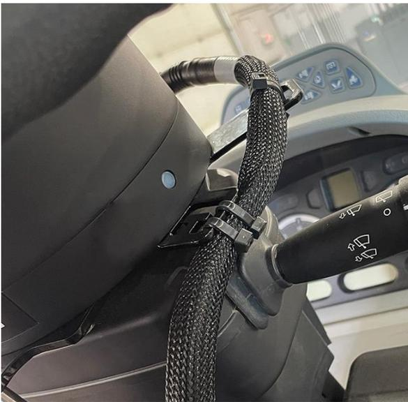
14. Passe o conector de 8 pinos do cabo do motor da DirecSteer (código de peça 115-4001-258) até o conector correspondente identificado como "Cabo do motor da DirecSteer" no cabo principal da DirecSteer (código de peça 115-7325-021).
