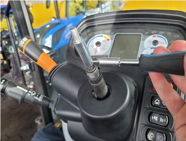
30. Certifique-se de que a coluna de direção esteja totalmente estendida para facilitar a instalação do conjunto DirecSteer.
