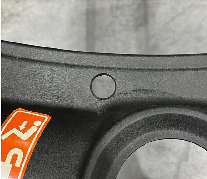
19. Recoloque o painel frontal e verifique se o anel isolante está alinhado corretamente com o furo feito.
