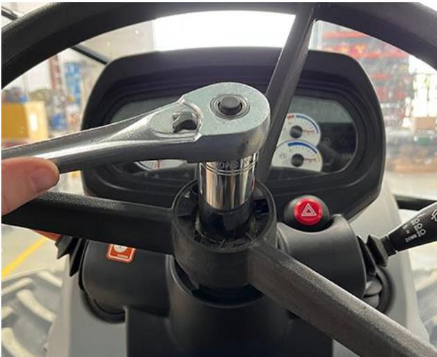
5. Remova o volante usando um extrator de volante e parafusos M6x1,0. Use o espaçador fornecido (código de peça 305-1001-011) para proteger a haste telescópica durante a remoção.
