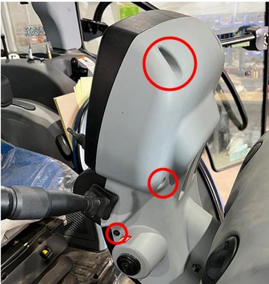
25. Reinstale os dois parafusos localizados na parte inferior do painel frontal.
