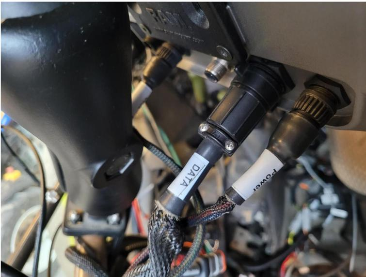
17. Depois que tudo estiver instalado e conectado, esconda o cabeamento atrás do forro sempre que possível e amarre o cabeamento onde for apropriado para evitar que ele fique solto.
