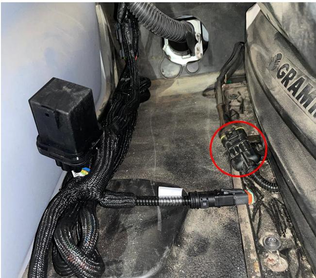
12. Conecte o cabo do motor (código de peça 115-4001-258) à porta elétrica no conjunto da DirecSteer.
