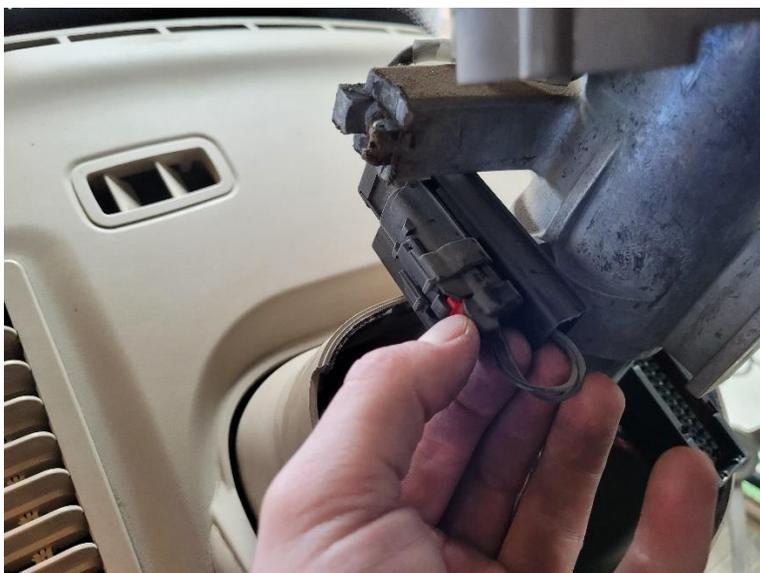
10. Pressione a trava preta e separe os conectores. Depois de separar os conectores, deslize o conector restante para trás para removê-lo.
