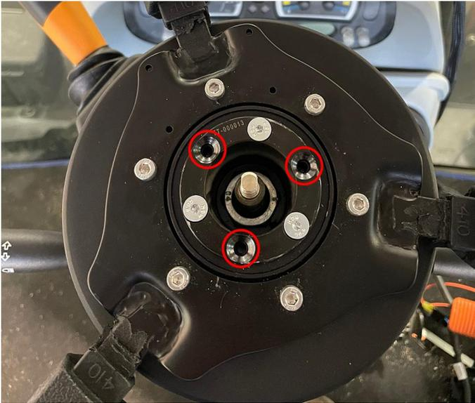
4. Prenda um extrator de volante OTC 7403 com parafusos M5 x 0,8 x 100+ mm ao conjunto DirecSteer. Use o espaçador fornecido (código de peça 305-1001-011) para proteger a haste telescópica, quando aplicável.
