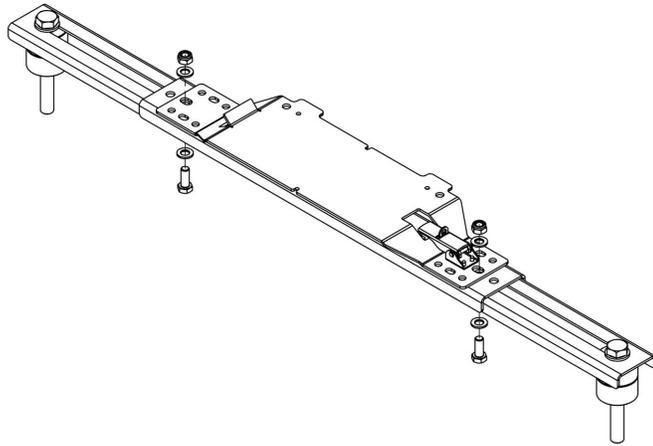
4. Instale o suporte no teto da cabine usando os dois M16 x 130 parafusos fornecidos no kit de acabamento da máquina.
