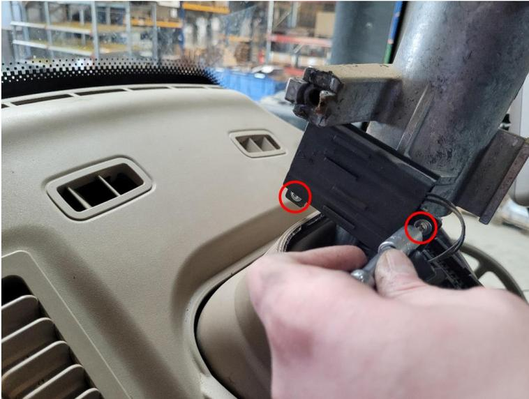
13. Remova o parafuso M8 do lado esquerdo da coluna de direção com um soquete de 13 mm.
