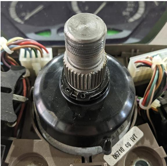
6. Levante o painel de instrumentos completo e apoie-o na parte superior da coluna, dentro do alojamento de plástico, para revelar os conectores.
