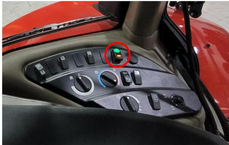
**Observação:** Se necessário, use o adaptador de interruptor fornecido (código de peça 412-8000-037) ao instalar em uma cavidade de tamanho maior.
