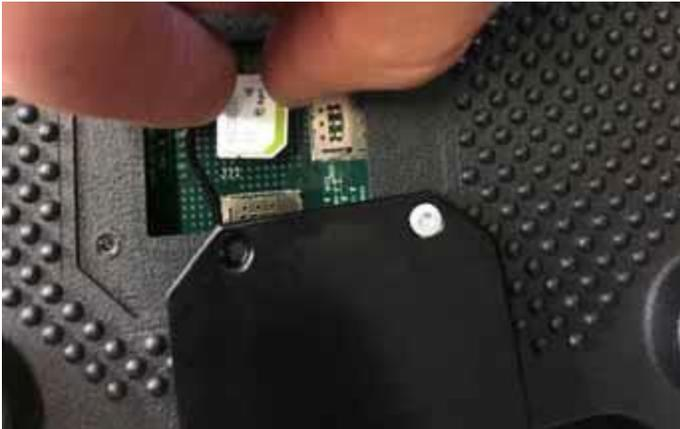
**Observação:** O cartão SIM deve ser inserido no slot J11 ou o RS1™ não se conectará à rede sem fio ou a uma rede CORS.
