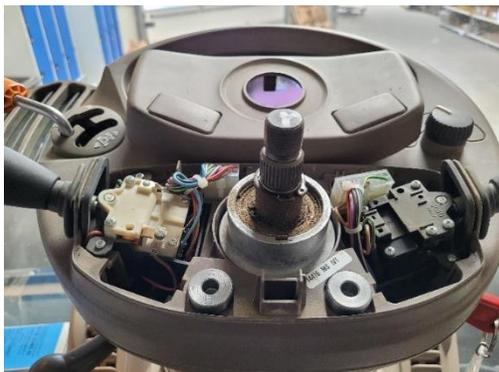
29. Instale o anel isolante (código de peça 315-0000-034) no suporte antirrotação (código de peça 107-4050-164).
