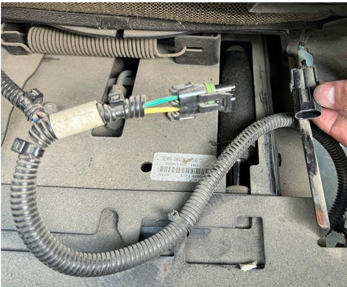
12. Conecte o cabo do motor (código de peça 115-4001-258) à porta elétrica no conjunto da DirecSteer.
