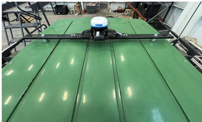
6. Se aplicável, monte a placa adesiva redonda para a antena de celular LAIRD (código de peça 121-0000-042) a 50 cm [20 pol.] do suporte do receptor da antena.
