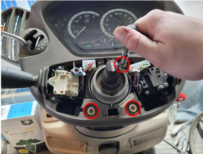
3. Remova a alavanca de travamento do telescópio usando uma chave sextavada de 5 mm.
