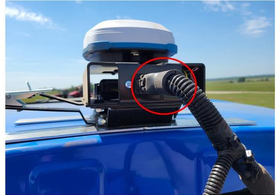
6. Na cabine, acople o conector de 18 pinos do T do receptor (código de peça 115-7325-041) ao conector correspondente do chicote da cabine da DirecSteer (código de peça 115-7325-021).
