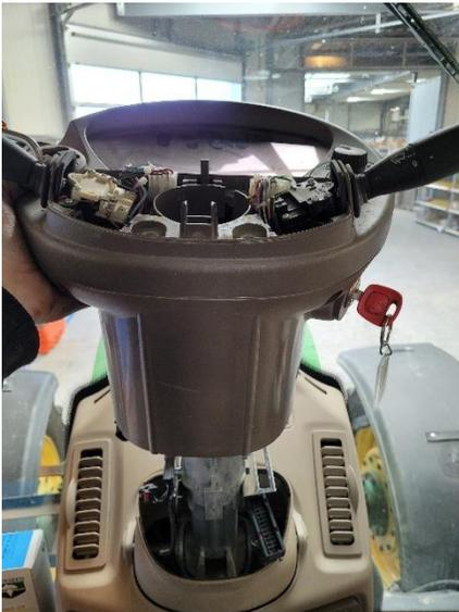
22. Deslize os conectores macho de volta para os suportes de montagem.
