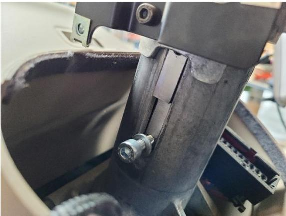
17. Pressione a coluna de direção para baixo e alinhe o furo superior do bloco com o furo na lateral da coluna de direção.
