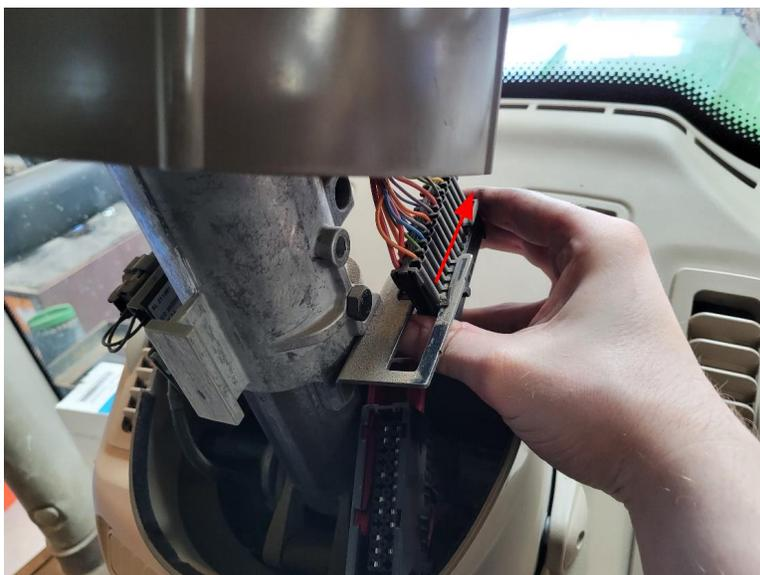
**Observação:** Algumas máquinas John Deere podem ter esse mesmo tipo de conector no lado esquerdo da coluna de direção. Remova aquele conector da mesma forma que este conector.
