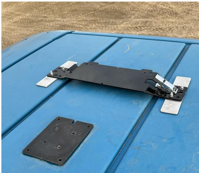
6. Prenda e fixe o receptor da antena no suporte do receptor de modo que o receptor da antena fique voltado para a frente da máquina.
