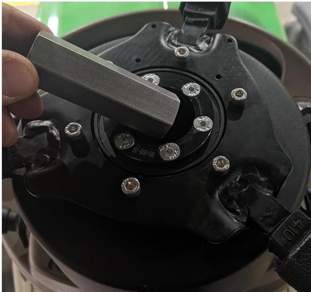
3. Coloque a tampa do volante na parte superior do conjunto da DirecSteer.
