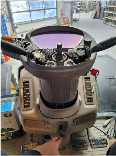
5. Se aplicável, use um alicate de anel elástico para remover o anel elástico e a tampa plástica preta.
