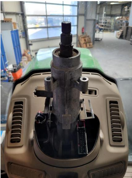
12. Se aplicável, remova o suporte plástico do conector da coluna de direção, retirando os dois parafusos com uma chave Philips pequena.
