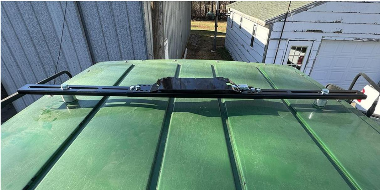
5. Prenda e fixe o receptor da antena no suporte do receptor de modo que o receptor da antena fique voltado para a frente da máquina.
