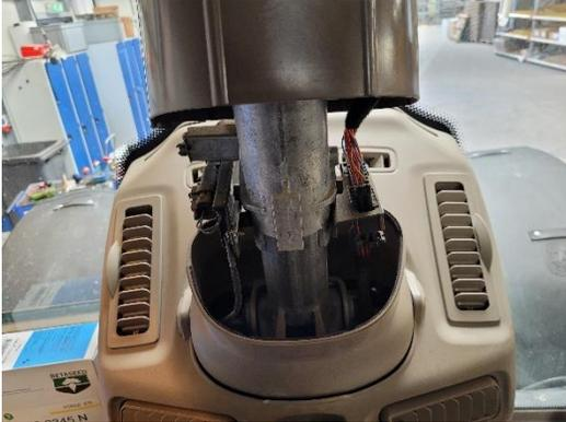
7. Solte o conector com o mecanismo de travamento roxo puxando a cunha para fora. Se a cunha for difícil de remover, tente abri-la com uma chave de fenda.
