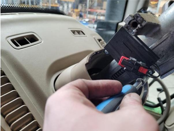
21. Certifique-se de que a coluna de direção esteja totalmente estendida novamente para facilitar a instalação. Coloque o painel de instrumentos de volta sobre a coluna e deixe-o apoiado na parte superior da coluna de direção para que os suportes do conector não fiquem cobertos.
