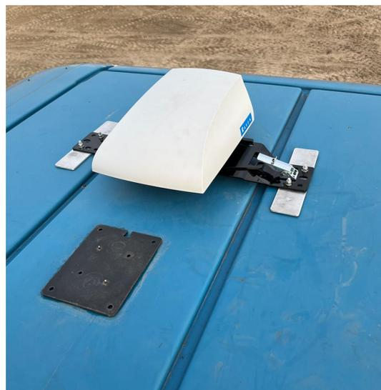
7. Se aplicável, monte a placa adesiva redonda para a antena de celular LAIRD (código de peça 121-0000-042) a 50 cm [20 pol.] do suporte do receptor da antena.
