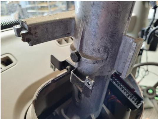
14. Rosqueie um dos parafusos M6 x 20 mm e a arruela no bloco antirrotação (código de peça 107-4050-163).
