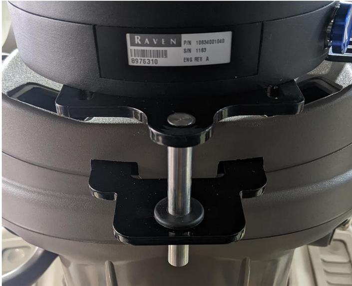
2. Insira a arruela M18 (código de peça 313-6000-028K) e a porca da coluna (código de peça 107-4001-111) no adaptador estriado e aperte com um soquete de 22 mm de profundidade.
