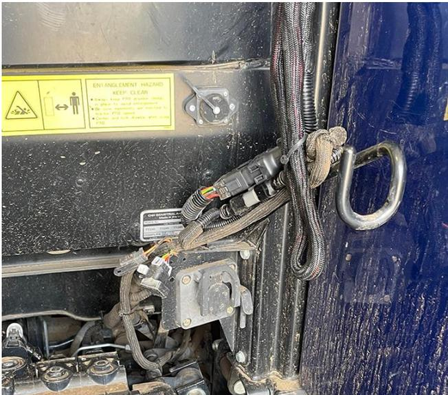
3. Conecte o cabo em T do receptor (código de peça 115-7325-041) ao conector de 18 pinos previamente passado no cabo da bateria (código de peça 115-7325-001/012).
