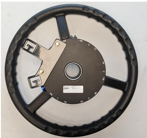
3. Prenda a haste antirrotação (N/P 063-4001-075) ao conjunto do DirecSteer na posição de 6 horas com dois dos parafusos fornecidos (N/P 311-4035-002K), mas não aperte.
