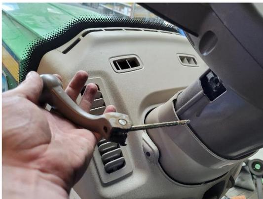
4. Incline a coluna de direção totalmente para cima.
