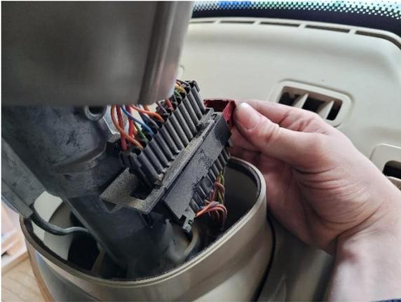
8. Deslize a parte montada restante do conector para fora de seu suporte.
