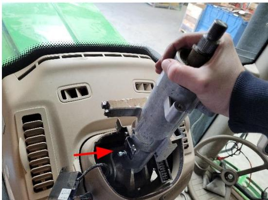
18. Insira o parafuso M6x20mm fornecido no furo rosqueado da coluna e aperte-o, prendendo o tensionador de mola na parte superior da coluna de direção.
