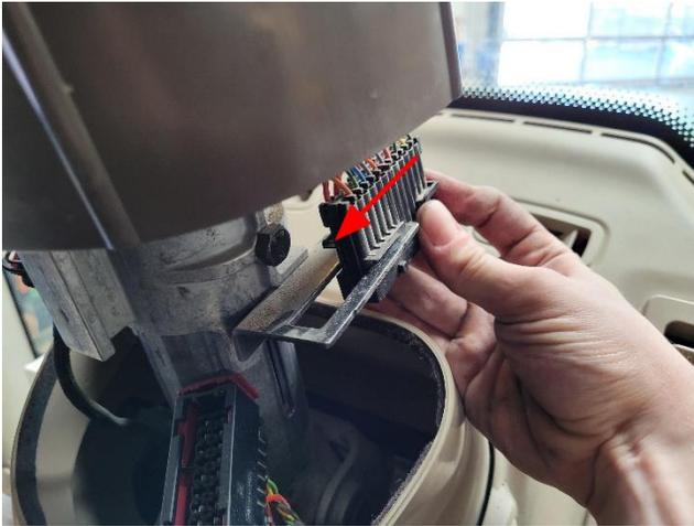
**Observação:** Algumas máquinas John Deere podem ter esse mesmo tipo de conector no lado esquerdo da coluna de direção. Recoloque aquele conector da mesma forma que este conector.
