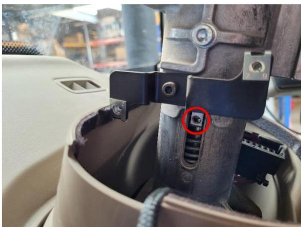
20. Se aplicável, monte novamente o suporte do conector no lado esquerdo da coluna usando uma chave Philips.
