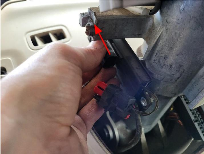
11. Levante o painel de instrumentos da coluna de direção.
