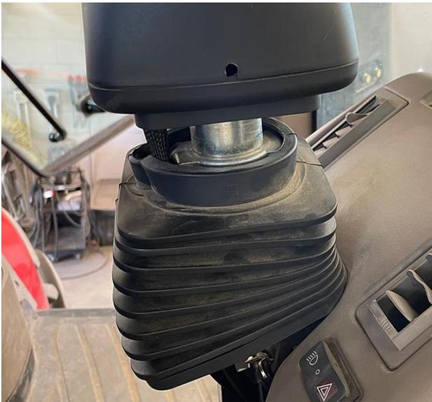
5. Prenda com folga o grampo da coluna (código de peça 116-4050-051) à coluna interna com o flange mais próximo da parte superior. Prenda com os elementos de fixação fornecidos, mas não aperte.
