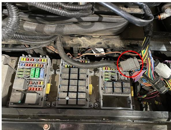
12. Conecte o cabo do motor (código de peça 115-4001-258) à porta elétrica no conjunto da DirecSteer.
