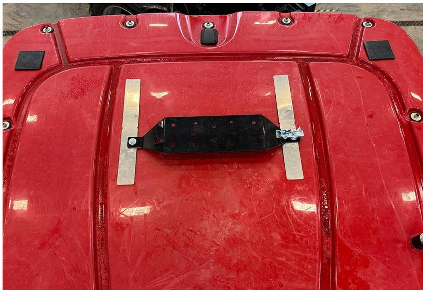
6. Prenda e fixe o receptor da antena no suporte do receptor de modo que o receptor da antena fique voltado para a frente da máquina.
