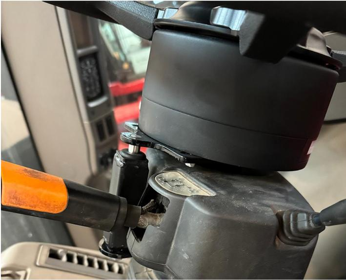
2. Coloque a porca removida anteriormente que estava prendendo o volante original e as três arruelas incluídas (código de peça 313-6000-025K) na extremidade rosqueada da coluna de direção. Torqueie a porca com 50 N·m.
