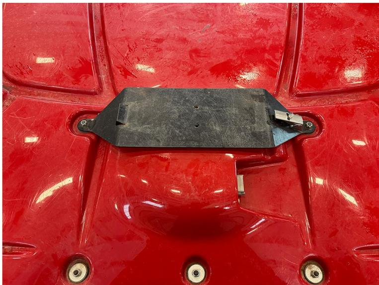
2. Fixe o receptor da antena no suporte de montagem de modo que a parte frontal da antena esteja apontando para a parte frontal da máquina. Prenda a antena no suporte com a trava.
