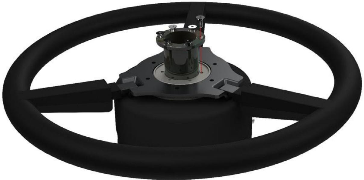
2. Instale o botão azul de desengate do motor auxiliar (código de peça 107-0172-837) pressionando-o firmemente na porta de encaixe na lateral do conjunto da DirecSteer.
