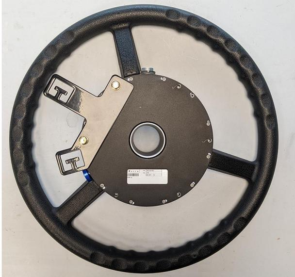
3. Prenda a haste antirrotação (código de peça 063-4001-098) ao conjunto da DirecSteer na posição de 2 horas com dois dos parafusos fornecidos (código de peça 311-4035-002K), mas não aperte.
