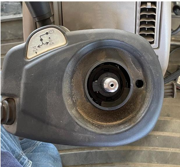
**Observação:** O volante e os componentes de fábrica não serão usados com o sistema DirecSteer. Recomenda-se manter esses componentes para o caso de o sistema DirecSteer ser desinstalado ou movido para outra máquina.
