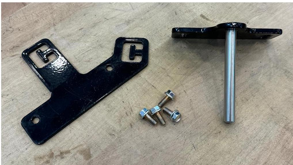
2. Fixe o suporte de passagem de cabos (código de peça 107-4001-093) ao conjunto da DirecSteer na posição de 10 horas e aperte-o com os dois parafusos M5 x 12 fornecidos (código de peça 311-4035-002K).
