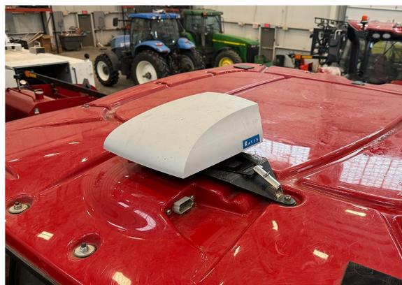
3. Se aplicável, monte a placa adesiva redonda para a antena de celular LAIRD (código de peça 121-0000-042) a 50 cm [20 pol.] do suporte do receptor da antena.
