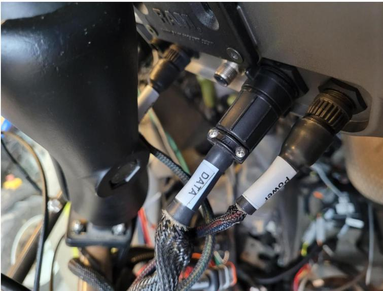
17. Depois que tudo estiver instalado e conectado, esconda o cabeamento atrás do forro sempre que possível e amarre o cabeamento onde for apropriado para evitar que ele fique solto.
