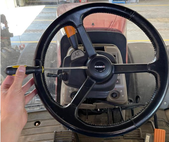
2. Remova a porca usada para prender o volante à coluna com um soquete de 22 mm.
