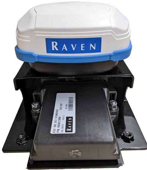
7. Prenda o suporte de teto (código de peça 116-4001-001) ao suporte de montagem fixo RS1™ (código de peça 107-0172-498) com os quatro parafusos escareados M6 x 16 (código de peça 311-4073-134) fornecidos, usando uma chave sextavada de 4 mm.
