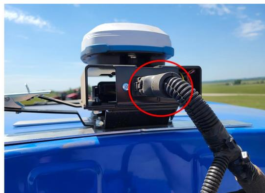
6. Na cabine, acople o conector de 18 pinos do T do receptor (código de peça 115-7325-041) ao conector correspondente do chicote da cabine da DirecSteer (código de peça 115-7325-021).
