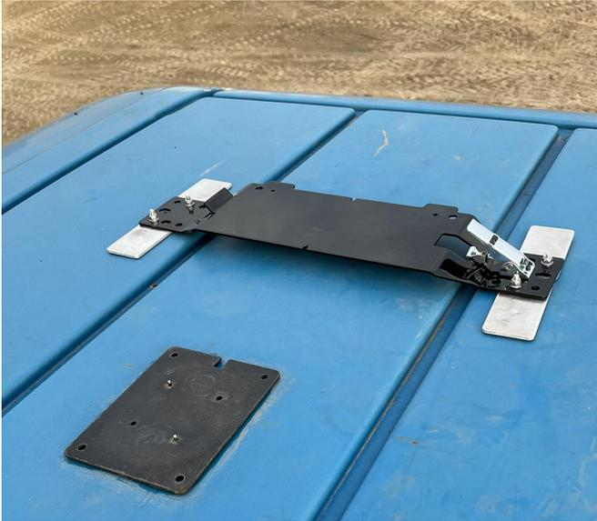
6. Fissare e fissare il ricevitore dell'antenna sulla staffa del ricevitore in modo che sia rivolto verso la parte anteriore della macchina.
