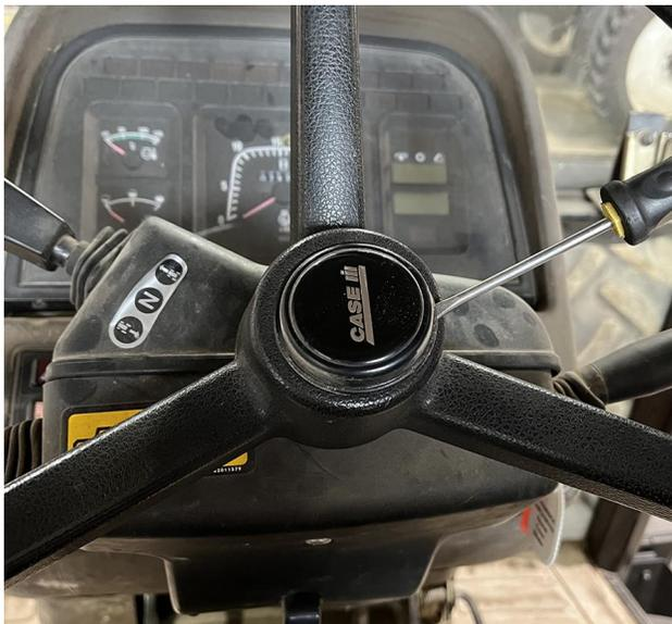
2. Rimuovere il dado da 22 mm di fissaggio del volante.
