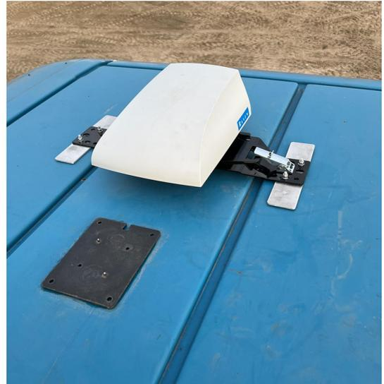
7. Se necessario, montare la piastra adesiva rotonda per l'antenna cellulare LAIRD (P/N 121-0000-042) entro 50 cm [20"] dalla staffa del ricevitore dell'antenna.
