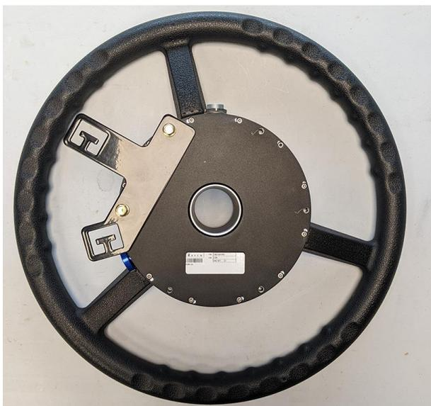
3. Fissare lo stelo antirotazione (P/N 063-4001-051) all'unità DirecSteer nella posizione a ore 2 con due bulloni tra quelli in dotazione (P/N 311-4035-002K), senza serrare.
