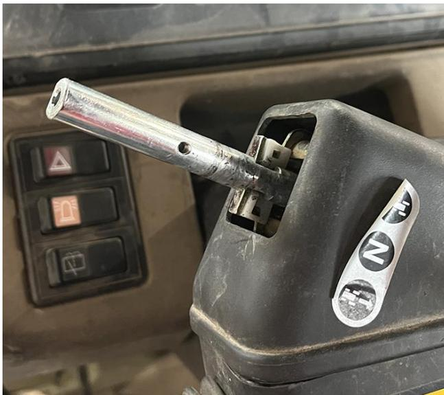
4. Sollevare con cautela la copertura dal piantone dello sterzo. Spostare con cautela il cambio attraverso il foro nell'elemento di rifinitura.
