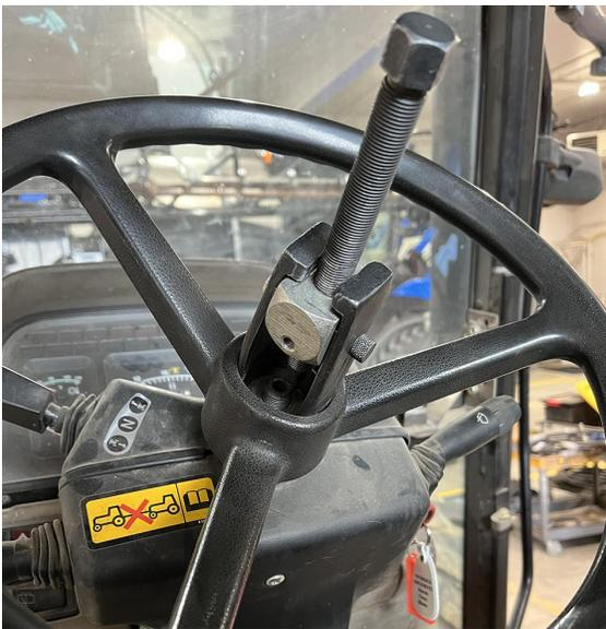
4. Utilizzare l'estrattore per rimuovere il volante dal piantone dello sterzo.
