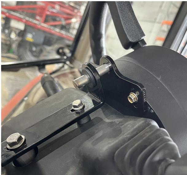
2. Posizionare il dado precedentemente rimosso che fissava il volante originale. Serrare il dado a 50 Nm.
