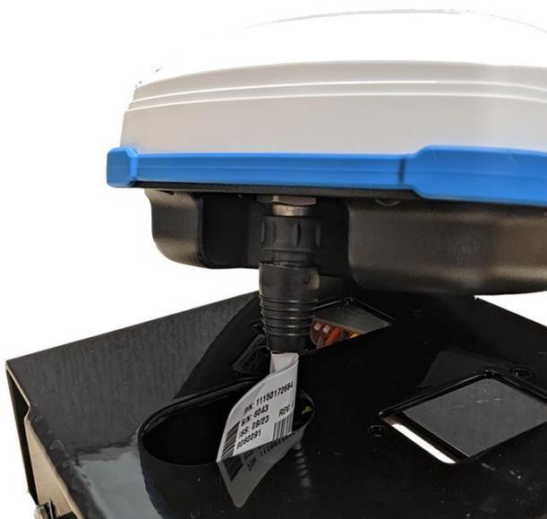
**Nota:** È più facile collegare il connettore prima che l'antenna sia fissata alla staffa sul tetto.
