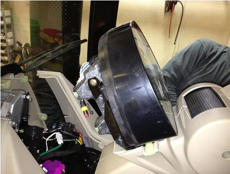
9. Rimuovere le sei viti di fissaggio delle coperture del piantone dello sterzo.
