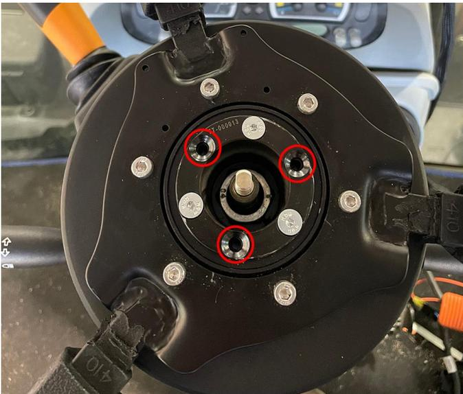
4. Fissare un estrattore del volante OTC 7403 con bulloni M5 x 0,8 x 100+ mm all'unità DirecSteer. Utilizzare il distanziatore fornito (P/N 305-1001-011) per proteggere lo stelo telescopico, se necessario.
