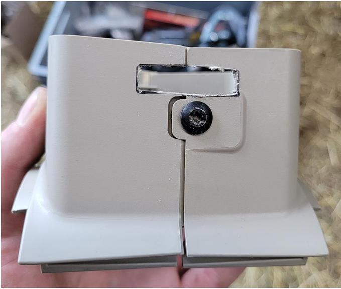
14. Applicare il morsetto della staffa antirotazione (P/N 107-4050-135) sulla parte superiore del piantone dello sterzo.
