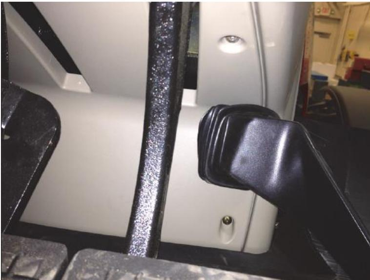
19. Rimontare le sei viti precedentemente rimosse sulla parte superiore e sui lati delle coperture del quadro strumenti posteriore.
