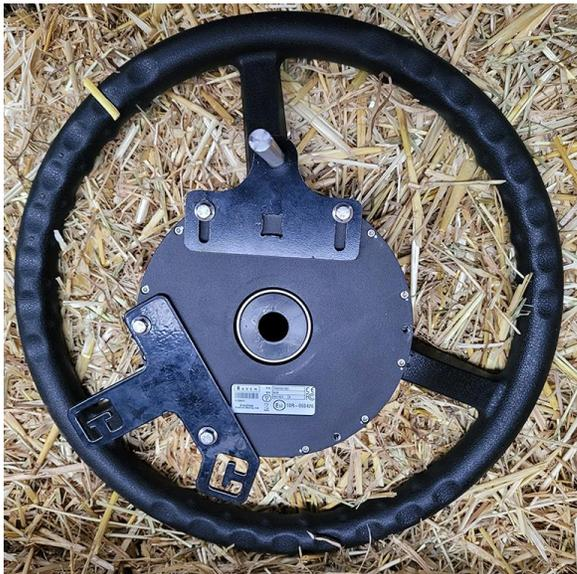
**Nota:** La posizione dello stelo antirotazione può essere ulteriormente regolata durante il montaggio. Si raccomanda di **non** serrare i bulloni in questo momento.
