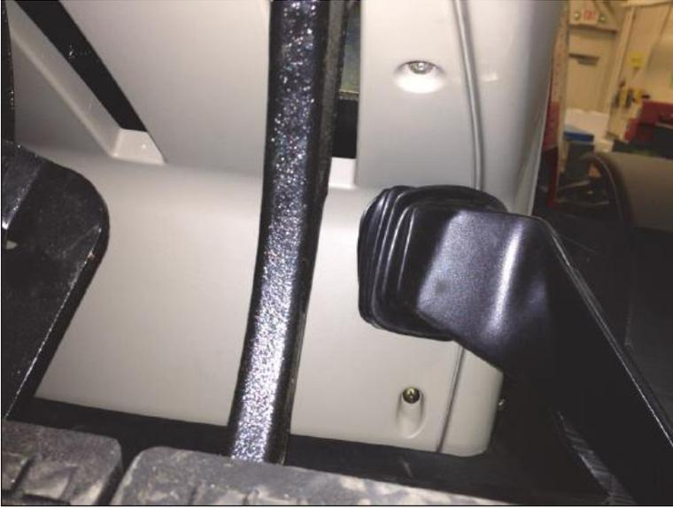
7. Rimuovere le quattro viti dietro il quadro strumenti con un cacciavite Torx T20.
