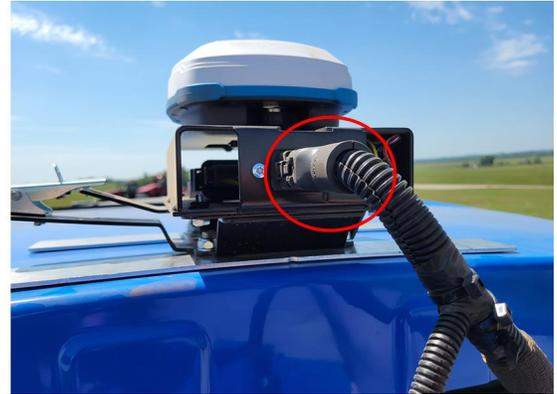
6. Nella cabina, collegare il connettore a 18 poli del ricevitore a T (P/N 115-7325-041) al connettore di accoppiamento del cablaggio della cabina DirecSteer (P/N 115-7325-021).
