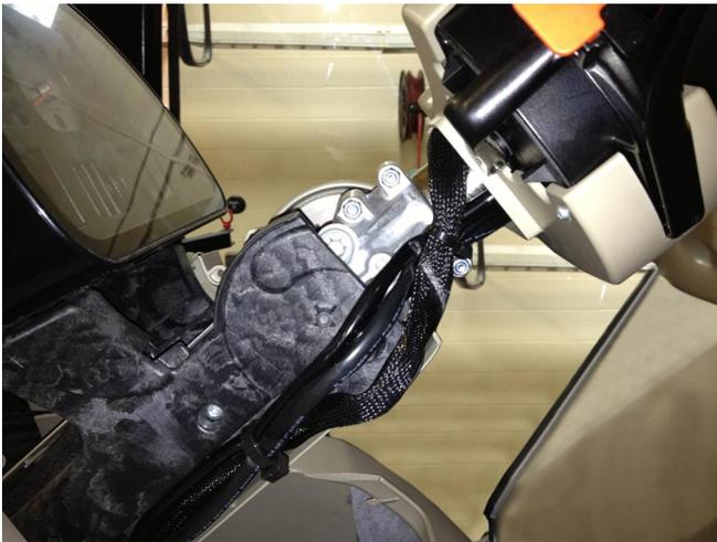
11. Utilizzare le viti precedentemente rimosse per fissare insieme le due coperture in plastica dell'angolo di sterzata e allineare il bordo superiore delle coperture montate con il bordo superiore della dima di taglio (P/N 107-4001-196).
