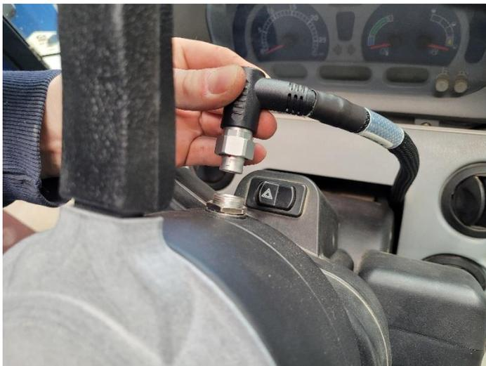
13. Far passare il cavo del motore DirecSteer (P/N 115-4001-258) lungo la staffa di posa dei cavi. Legare il cavo con una fascetta, come richiesto.
