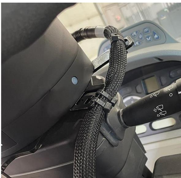
14. Far passare il connettore a 8 poli del cavo motore DirecSteer (P/N 115-4001-258) al connettore di accoppiamento con la dicitura "DirecSteer Motor Cable" ("Cavo del Motore DirecSteer") sul cavo principale DirecSteer (P/N 115-7325-021).
