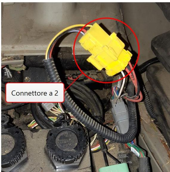
12. Collegare il cavo del motore (P/N 115-4001-258) alla porta elettrica dell'unità DirecSteer.
