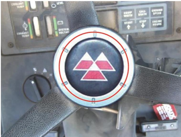
2. Rimuovere il dado utilizzato per fissare il volante originale al piantone con una bussola da 22 mm.
