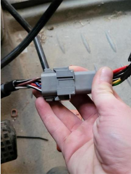
15. Collegare il connettore a 18 poli del cablaggio del computer di campo (P/N 115-7325-051/052) al connettore di accoppiamento del cavo a T del ricevitore (P/N 115-7325-021).
