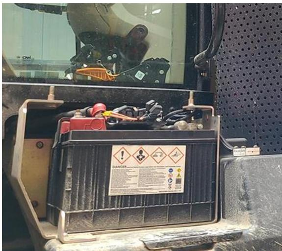
**Nota:** In genere, il vano batteria si trova sul lato destro del trattore, davanti alla ruota posteriore e sotto alla cabina o accanto a essa.
