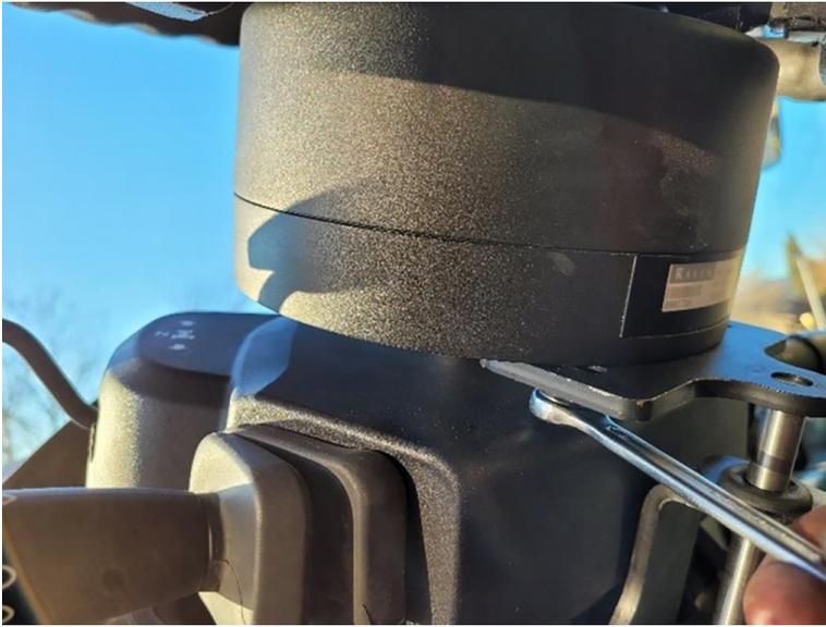
4. Montare la copertura sul volante.
