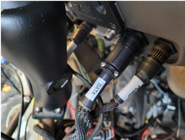
17. Una volta completata l'installazione, nonché il collegamento, nascondere il cablaggio dietro il rivestimento, ove possibile, e fissare il cablaggio, ove necessario, per evitare che si allenti.
