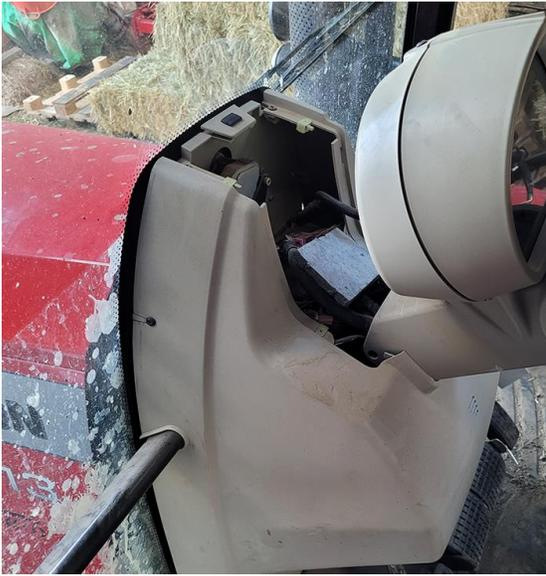
5. Rimuovere le due viti sulla parte superiore, le due viti sul lato sinistro e le due viti sul lato destro della copertura del quadro strumenti utilizzando un cacciavite Torx T20.
