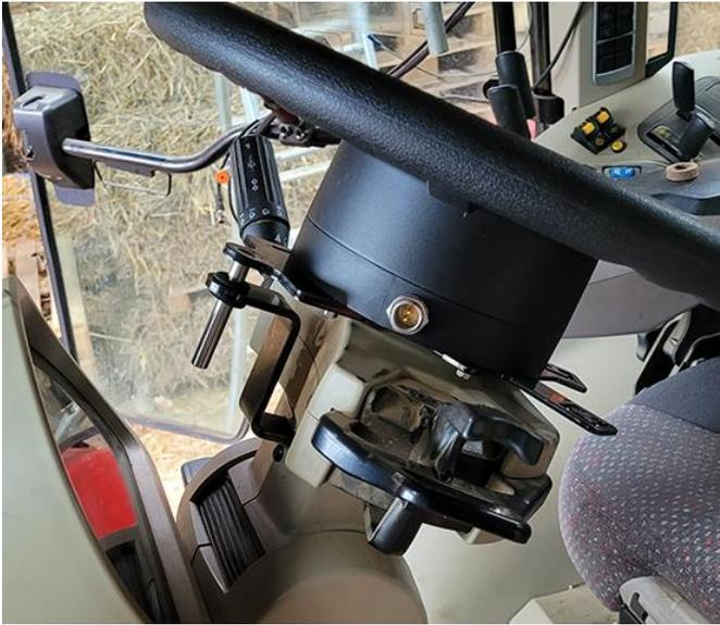
2. Inserire il dado del piantone originale, la rondella e le due rondelle aggiuntive nell'adattatore scanalato e serrare.
