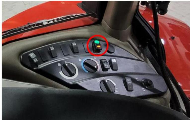
**Remarque :** Si nécessaire, utilisez l'adaptateur de l'interrupteur fourni (réf. 412-8000-037) lors de l'installation dans une cavité de plus grande taille.
