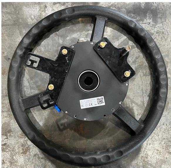
**Remarque :** La position de la tige anti-rotation peut être ajustée au cours de l'installation. Il est recommandé ne **pas** serrer les vis à ce stade.
