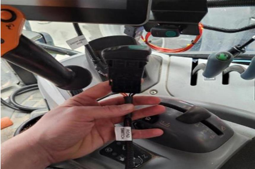
9. Pressez l'ensemble de l'interrupteur dans la cavité pour le mettre en place.
