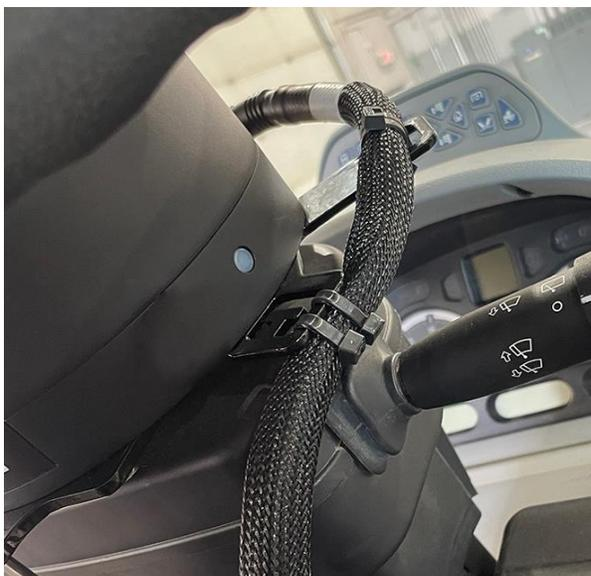
14. Acheminer le connecteur à 8 broches du câble moteur du DirecSteer (réf. 115-4001-258) vers le connecteur homologue étiqueté « Câble moteur DirecSteer » sur le câble principal du DirecSteer (réf. 115-7325-021).
