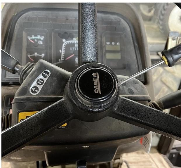
2. Retirer l'écrou de 22 mm qui fixe le volant.
