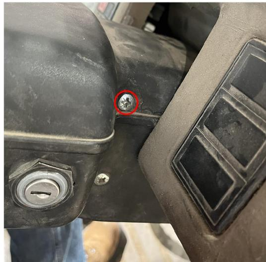
2. Utiliser une clé hexagonale pour retirer la poignée du levier de vitesse.
