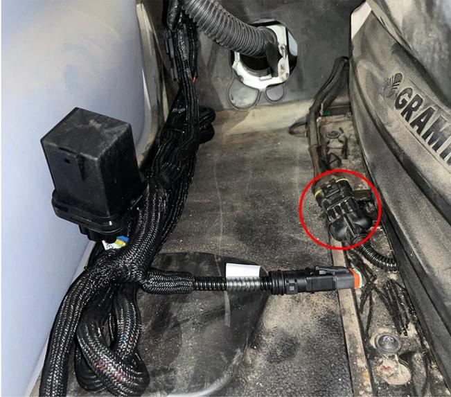
12. Connecter le câble du moteur (réf. 115-4001-258) au port électrique de l'ensemble DirecSteer.
