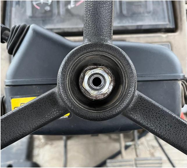
3. Insérer l'extracteur de volant PT W80653 au centre du volant.
