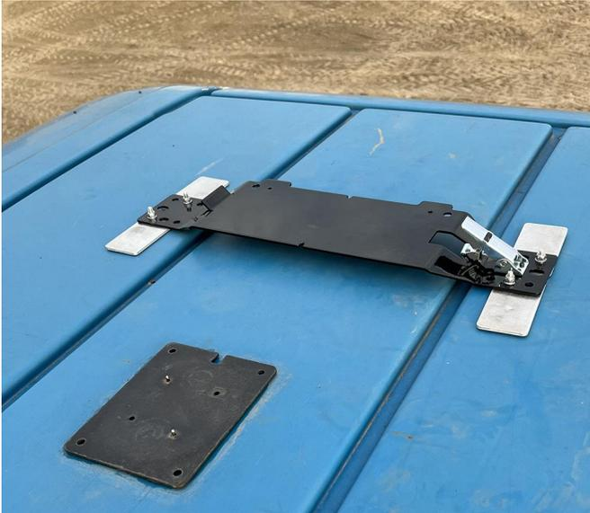
6. Fixer le récepteur d'antenne sur son support de manière à ce qu'il soit orienté vers l'avant de la machine.
