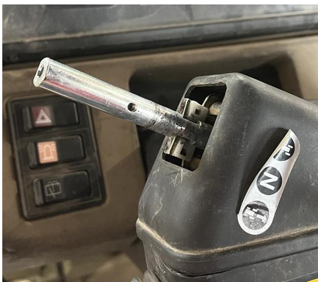
4. Soulever délicatement le couvercle de la colonne de direction. Déplacer avec précaution le levier de vitesse à travers le trou de la garniture.
