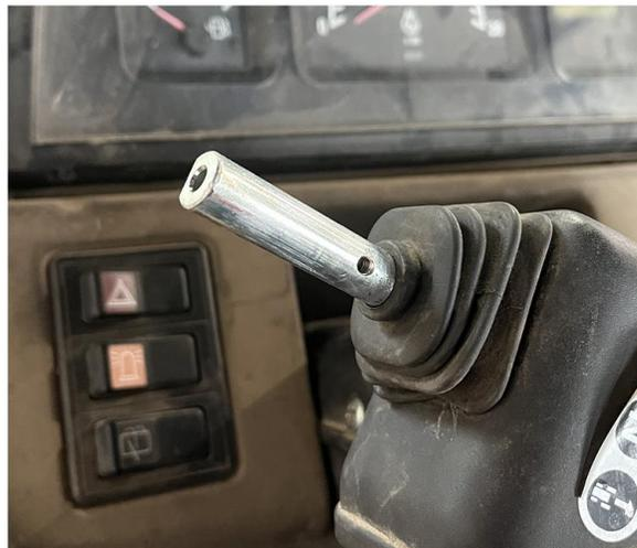
3. Retirer le couvercle en caoutchouc de la tige du levier de vitesse.
