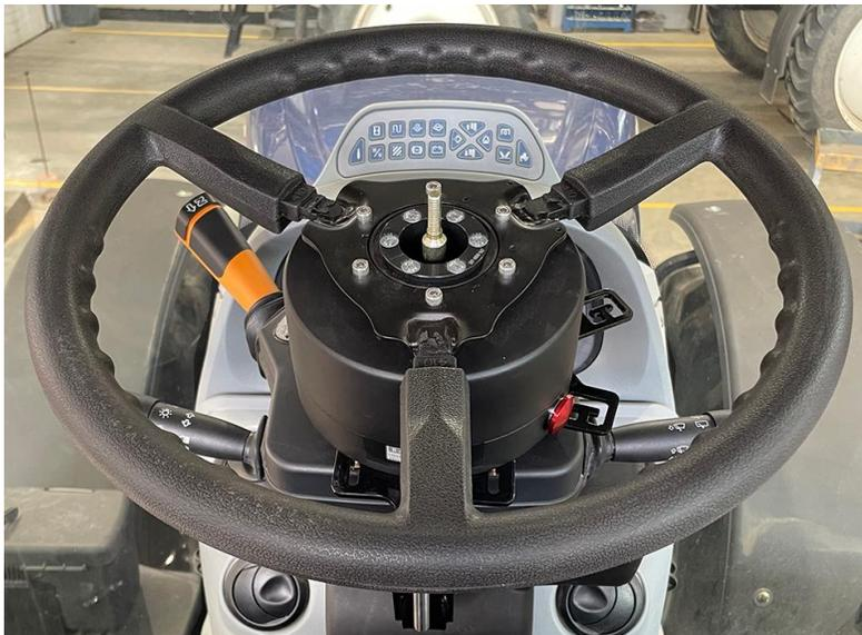
2. Retirer l'écrou et la rondelle de la colonne.
