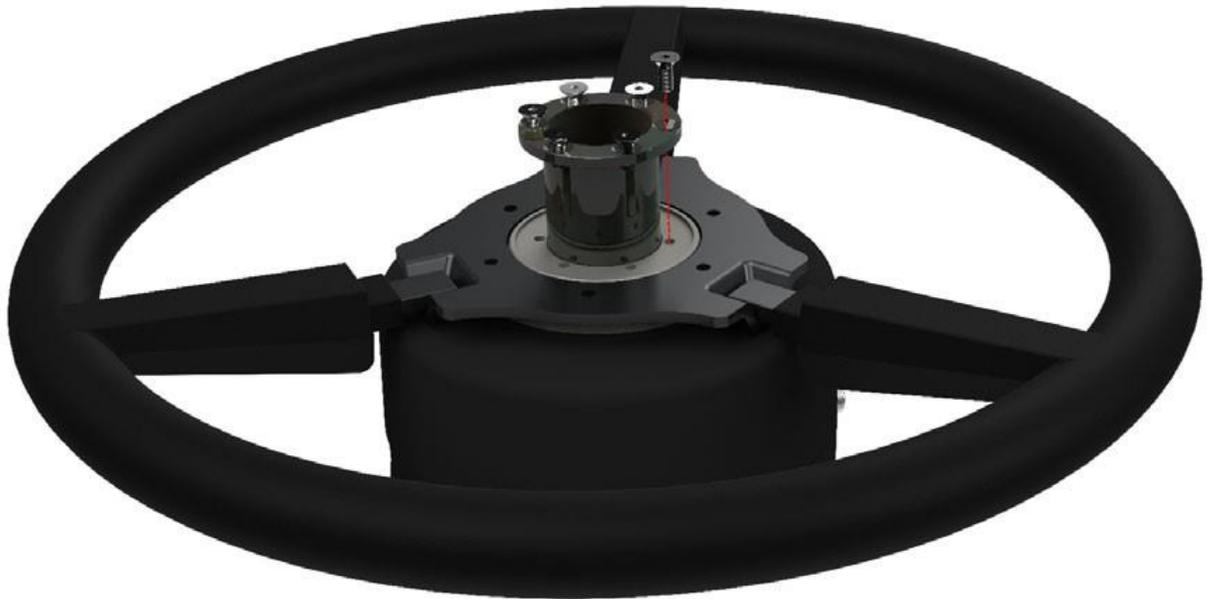
2. Installer la vis bleue de débrayage du moteur auxiliaire (réf. 107-0172-837) en l'enfonçant fermement dans l'orifice correspondant sur le côté de l'ensemble DirecSteer.
