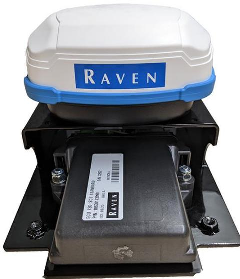
7. Fixer le support de pavillon (réf. 116-4001-001) au support de montage fixe RS1™ (réf. 107-0172-498) avec les quatre vis à tête fraisée M6 x 16 fournies (réf. 311-4073-134) à l'aide d'une clé hexagonale de 4 mm.
