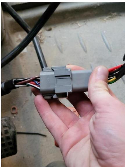
15. Brancher le connecteur à 18 broches du faisceau de l'ordinateur de terrain (réf. 115-7325-051/052) sur le connecteur correspondant du câble en té du récepteur (réf. 115-7325-021).
