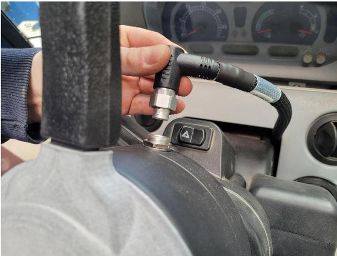
13. Acheminer le câble du moteur DirecSteer (réf. 115-4001-258) le long du support d'acheminement des câbles. Attacher le câblage à l'aide d'une fermeture éclair, selon les besoins.
