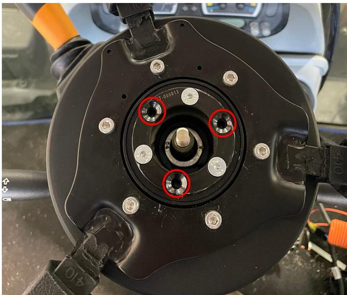
4. Fixer un extracteur de volant OTC 7403 avec des boulons M5 x 0,8 x 100+ mm à l'ensemble DirecSteer. Utiliser l'entretoise fournie (réf. 305-1001-011) pour protéger la tige télescopique le cas échéant.
