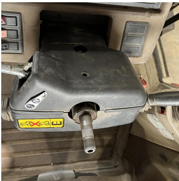
10. Fixer le support du passe-fil à la colonne de direction en installant l'entretoise de 3/4" de long (réf. 305-1001-012) et la vis M8 x 40 mm dans le trou le plus proche du tableau de bord.
