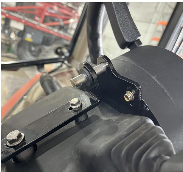
2. Placer l'écrou précédemment retiré qui fixait le volant d'origine. Serrer l'écrou à 50 N-m.
