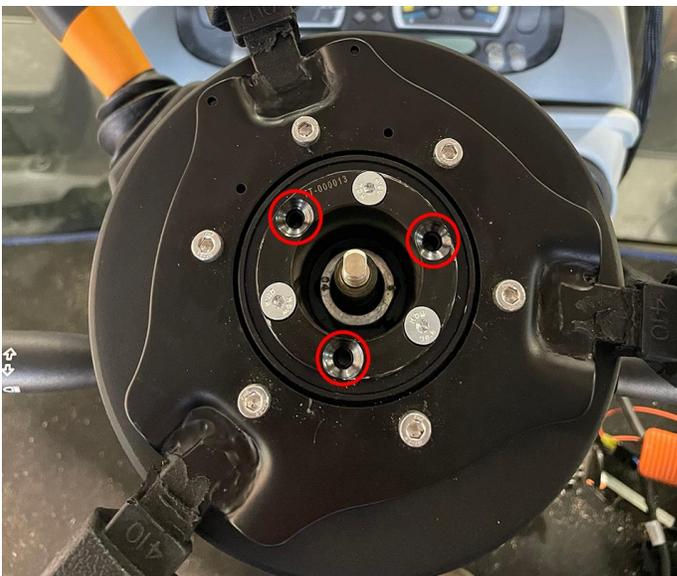
4. Coloque el extractor del volante de la dirección OTC 7403 con pernos M5 × 0,8 × +100 mm en el conjunto DirecSteer. Cuando sea necesario, use el espaciador incluido (número de pieza: 305-1001-011) a fin de proteger el vástago telescópico.
