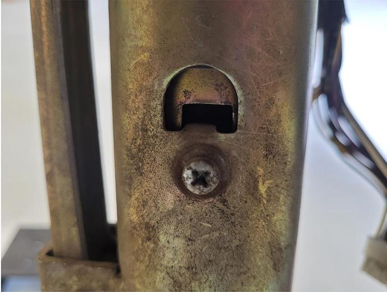
13. Si la columna de dirección aún se puede mover con libertad, use una llave tubo de 10 mm para aflojar la contratuerca de abajo y una llave Allen de 3 mm para rotar el perno en sentido horario  $\frac{1}{8}$  de vuelta. Ajuste la contratuerca.
