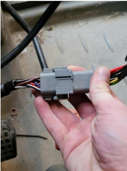
15. Conecte el conector de 18 clavijas del mazo de cables de la computadora de campo (pieza número 115-7325-051/052) al conector de acoplamiento del cable en T del receptor (pieza número 115-7325-021).
