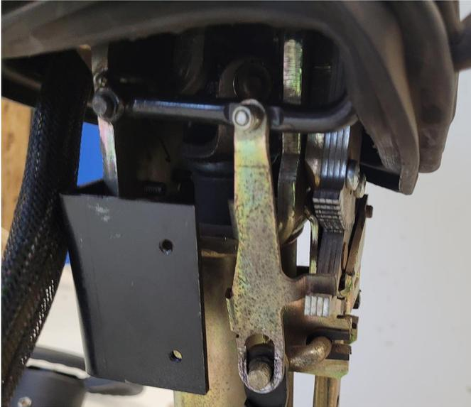
33. Vuelva a colocar los fijadores en los pernos con un destornillador de punta plana pequeño.
