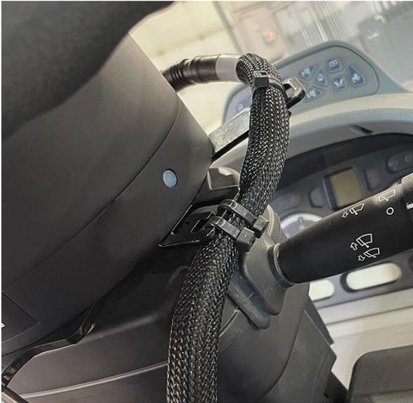
14. Conecte el conector de 8 clavijas en el cable de motor de DirecSteer (pieza número 115-4001-258) al conector de acoplamiento etiquetado como "Cable del motor de DirecSteer" en el cable principal de DirecSteer (pieza número 115-7325-021).
