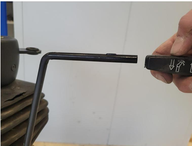
23. Tire de la palanca de bloqueo de la columna de dirección y empuje el borde para quitarlo de la traba.
