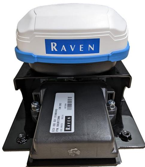
7. Fije el soporte del techo (pieza número 116-4001-001) al soporte fijo de la unidad RS1™ (pieza número 107-0172-498) con los 4 tornillos avellanados M6 × 16 (pieza número 311-4073-134) y una llave hexagonal de 4 mm.
