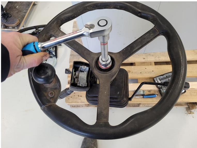
8. Use un extractor del volante de la dirección para desmontar el volante de la dirección del eje de la ranura.
