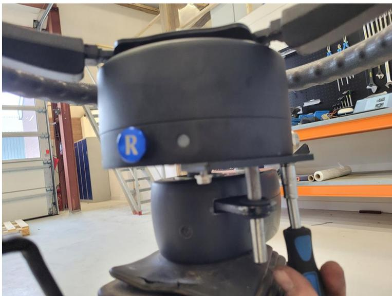
3. Instale la tuerca original de la columna en el centro del conjunto con una llave tubo de 27 mm.
