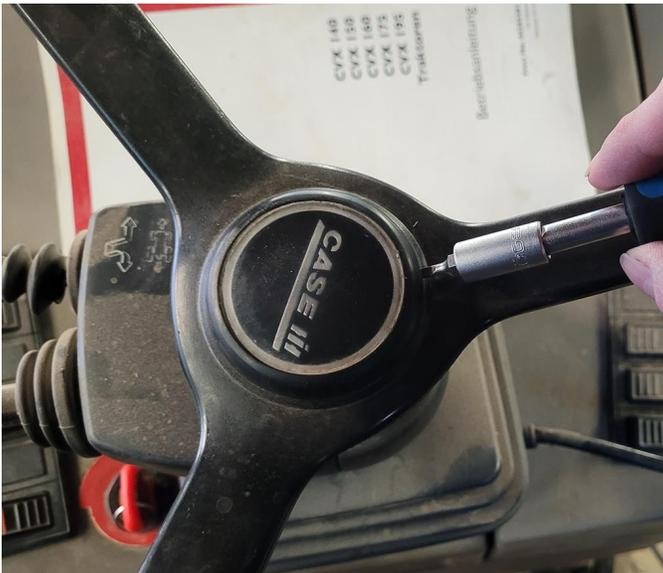
7. Desinstale la tuerca que fija el volante de la dirección a la columna de dirección con una llave tubo de 27 mm.
