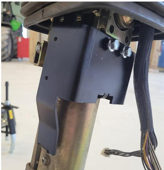
**Nota:** La posición del soporte antirotación se puede acomodar más durante la instalación. **No** se recomienda ajustar los pernos en esta instancia.
