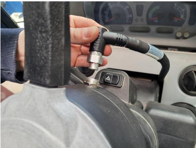
13. Pase el cable del motor de DirecSteer (pieza número 115-4001-258) a lo largo del soporte de cableado. Ate los cables con bridas.
