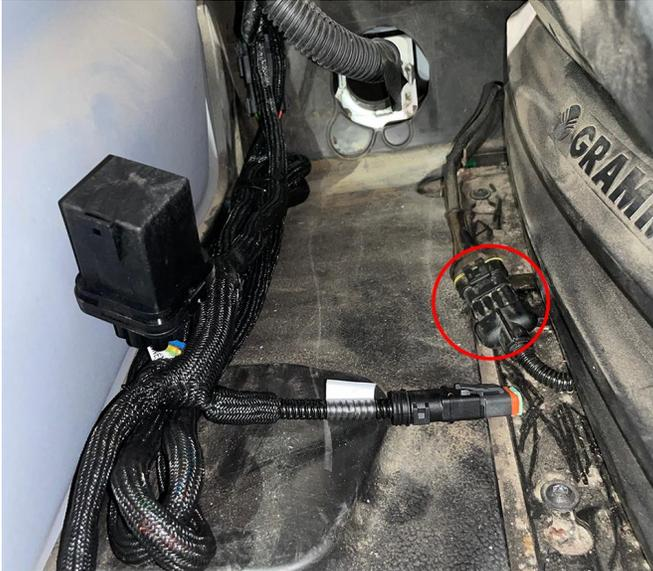
12. Conecte el cable del motor (pieza número 115-4001-258) al puerto eléctrico en el conjunto de DirecSteer.
