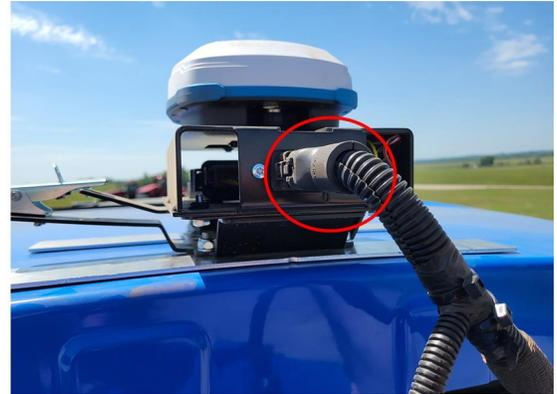
6. En la cabina, conecte el conector de 18 clavijas del cable en T del receptor (pieza número 115-7325-041) al conector de acoplamiento del mazo de cables de la cabina de DirecSteer (pieza número 115-7325-021).
