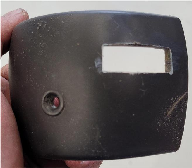
6. Introduzca el anillo protector en la ranura y fije la cubierta a la columna. Use un destornillador Phillips n.º 2 para atornillar el tornillo de 4 mm que quitó antes.
