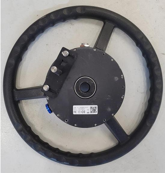
**Nota:** Puede acomodar aún más la posición del vástago antirotación durante la instalación. Se recomienda **no** ajustar los pernos en esta parte de la colocación.
