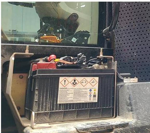
**Nota:** Por lo general, el compartimiento de la batería se encuentra en el lado derecho del tractor, frente al neumático trasero y debajo o al lado de la cabina.
