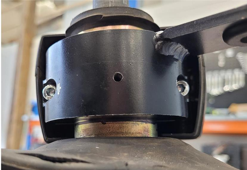
2. Coloque la plantilla de corte (número de pieza: 107-4001-192) en el exterior de la cubierta plástica y fíjela en el exterior con el tornillo que quitó antes y en el interior de la cubierta con la abrazadera que quitó antes.
