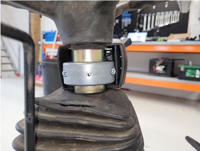
3. Marque la posición actual de la abrazadera del conjunto del interruptor en la columna de dirección.
