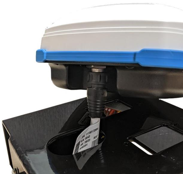
**Nota:** Es más fácil fijar el conector antes de que la antena esté fijada al soporte del techo.
