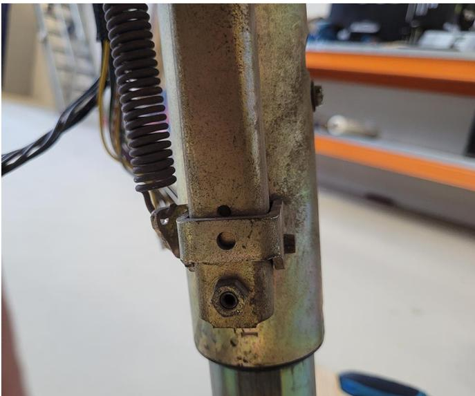
14. Rosque el orificio existente en la columna de dirección para que tenga roscas de 5 mm × 0,8 mm.
