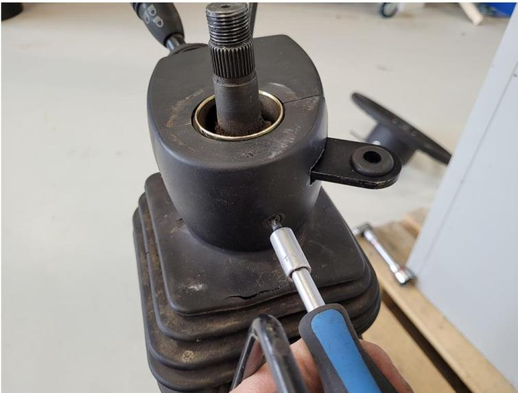
7. Levante la columna de dirección para despegarla del panel y dejar expuestas las cubiertas plásticas de abajo.
