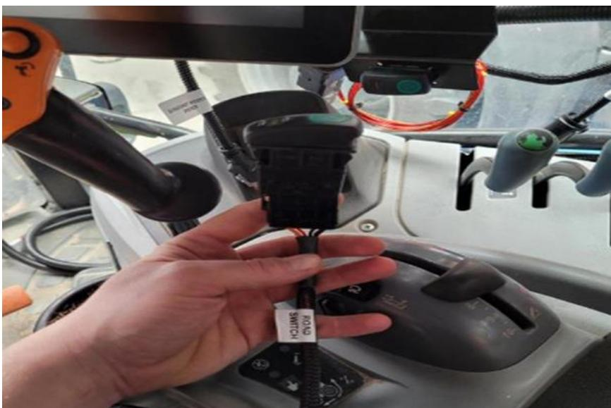
9. Tryk kontaktenheden ind i hullet for at anbringe kontakten
