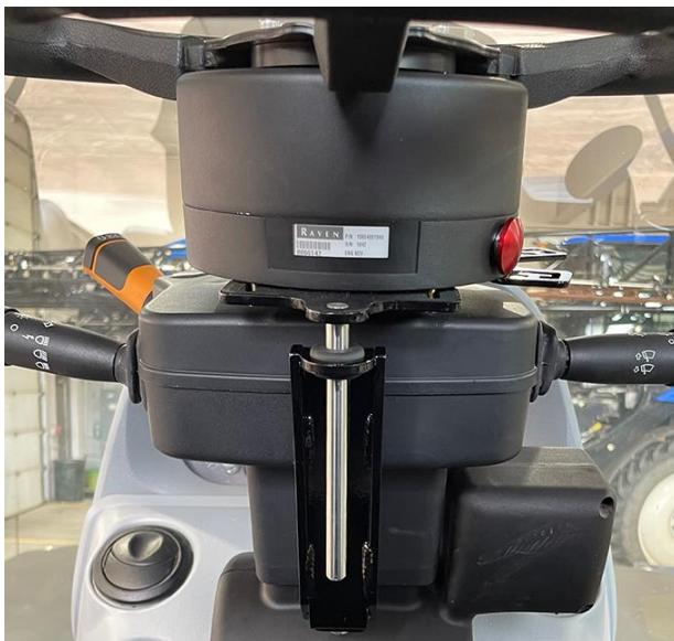
**Bemærk:** Antirotationsbeslag skal på dette tidspunkt være løst monteret.
