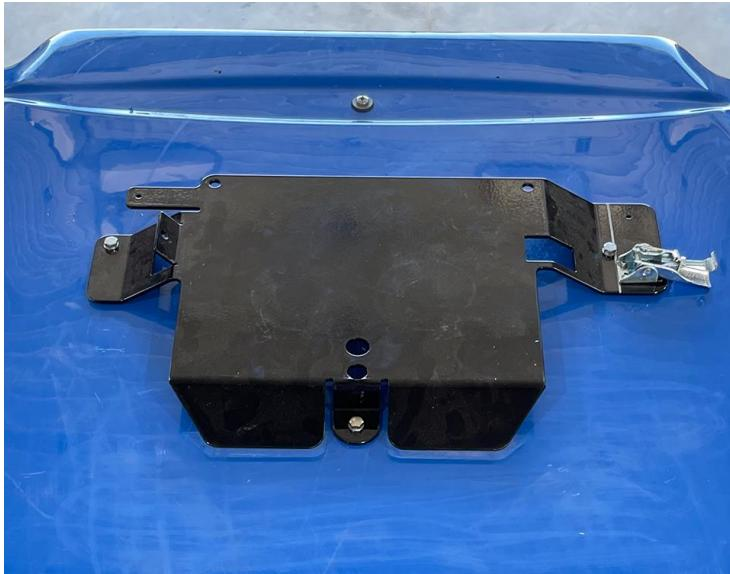
7. Fastgør låsepladen til monteringsbeslaget
