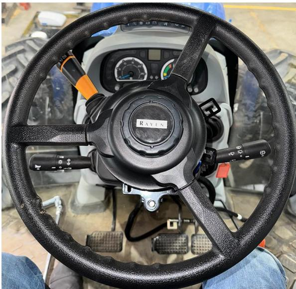
11. Kontrollér, at alle monteringsdele er korrekt tilspændt, og at DirecSteer er sikker.
