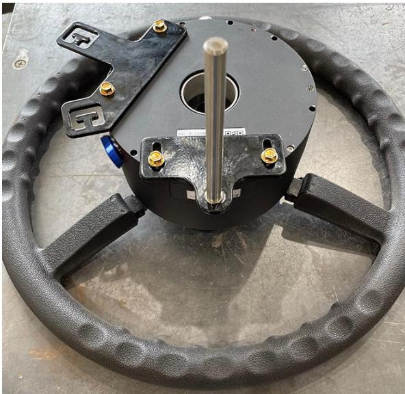
**Bemærk:** Antirotationsspindlens position kan justeres yderligere under montering.
