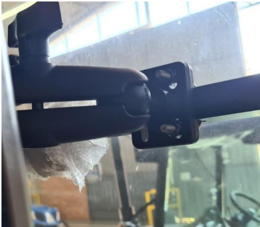
Figura 26 - Fijación de CR7 a la cabina
