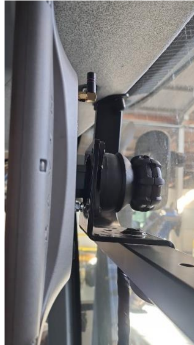
Figura 30 - Fijación del monitor
