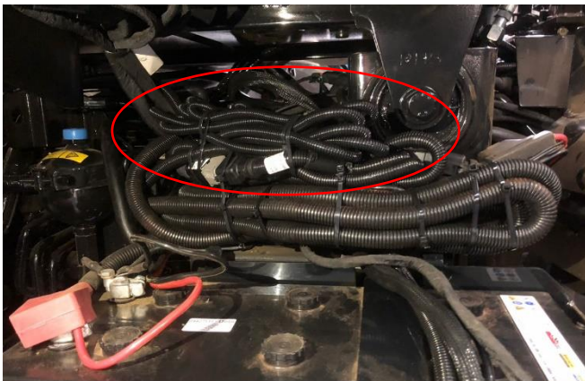
Figura 14 – Fijación del arnés adaptador del sensor de ángulo de rueda
