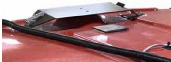
Figura 25 – RS1 fijada al techo de la cabina
