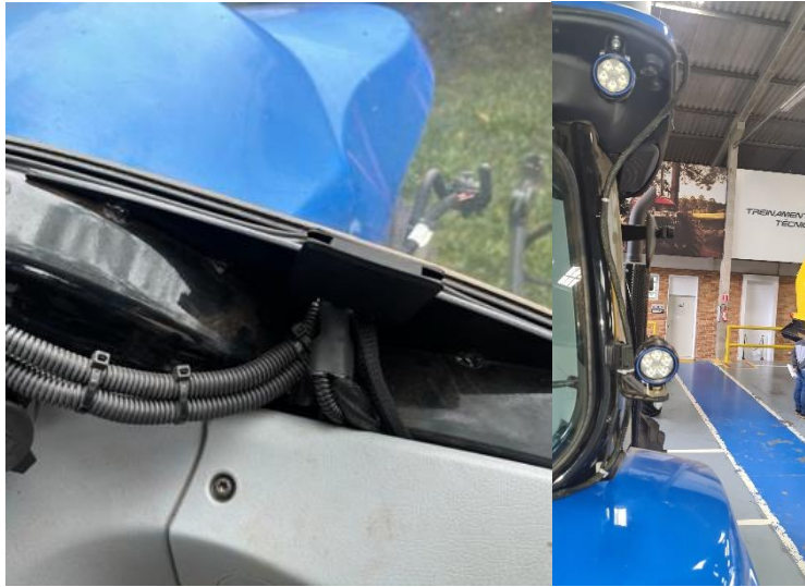
Figura 18 - Fijación de Arnés de RS1
