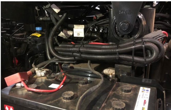
Figura 3 – Fijación del arnés.
