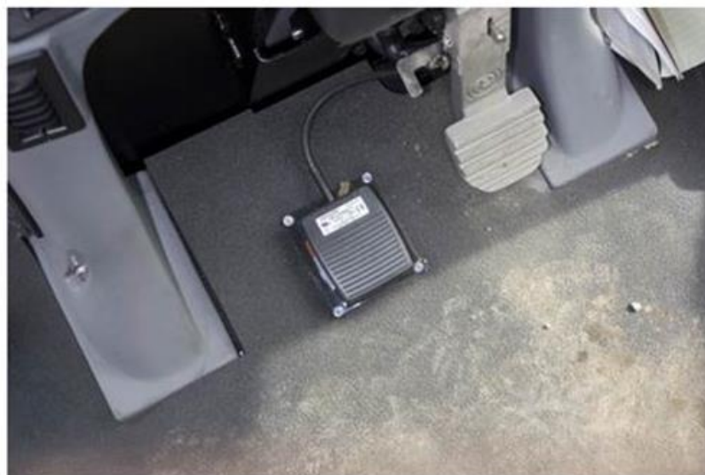
Figura 21 – Fijación del pedal de accionamiento del Piloto automático
