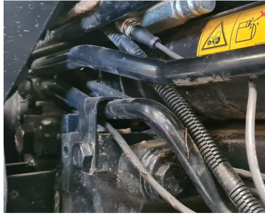
Figura 13 – Espacio de paso del arnés con aislamiento térmico.
