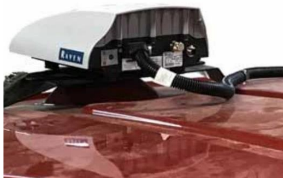
Figura 24 – Soporte de montaje de receptor
