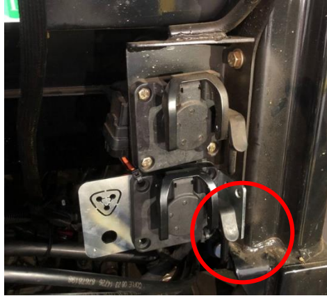
Figura 5 – Fijación de toma IBBC anexo a original del tractor
