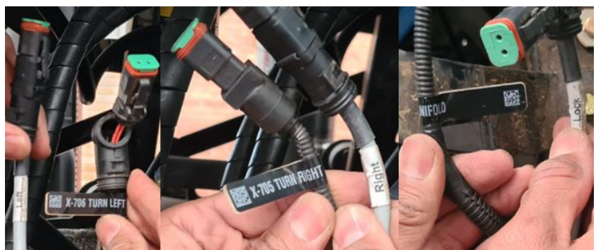
Figura 7 – Conectores CNH DT y conectores de Arnés de bloque
