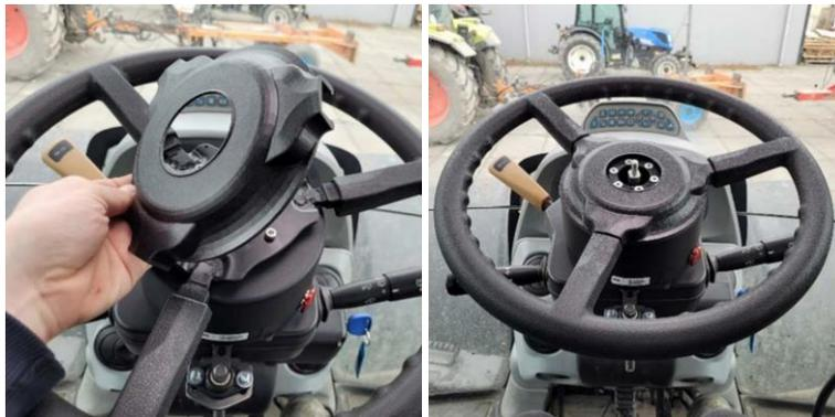
Coloque la tapa en el adaptador telescópico y asegure el conjunto con la tuerca con una llave de 13mm. Termine la instalación colocando la terminación de plástico y asegurándose de que todas las piezas estén bien atornilladas.
