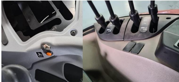
Figure 1 - Ubicaciones recomendadas para conectar el interruptor de activación del piloto
