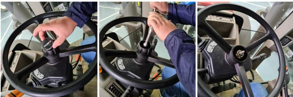
Después de quitar la tuerca del volante, retire el volante de la columna de dirección. Puede ser necesario utilizar una herramienta para ayudar en la extracción del volante.
