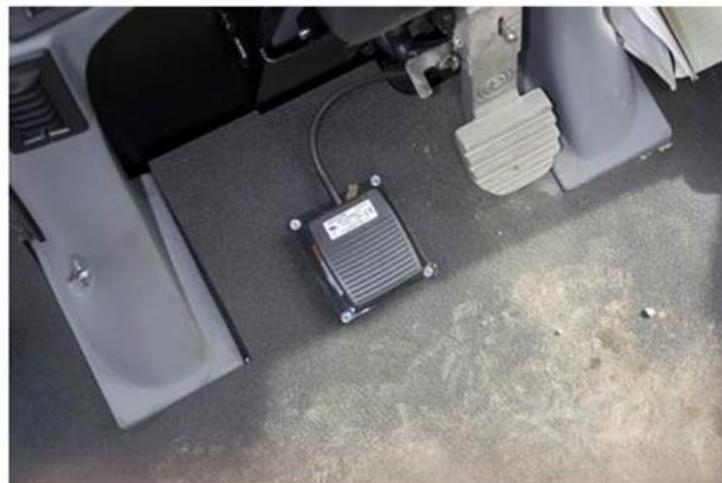
Figure 2 - Colocación del pedal de conducción del piloto automático
