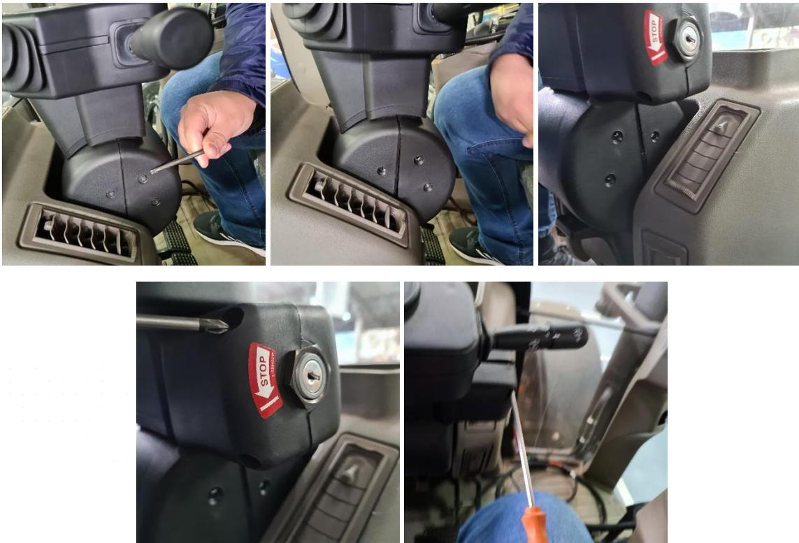
Después de retirar todos los tornillos, retire el carenado delantero y termine el desmontaje desenroscando la tuerca que fija el interruptor de encendido del carenado delantero. Esta tuerca se puede quitar usando solo las manos, también recuerde guardar esta tuerca para su uso futuro.
