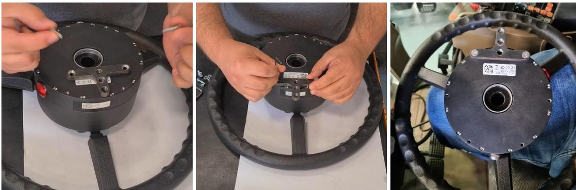
Además, fije el adaptador de la columna de dirección al DirecSteer con los 6 tornillos Allen, recordando apretar bien los tornillos.
