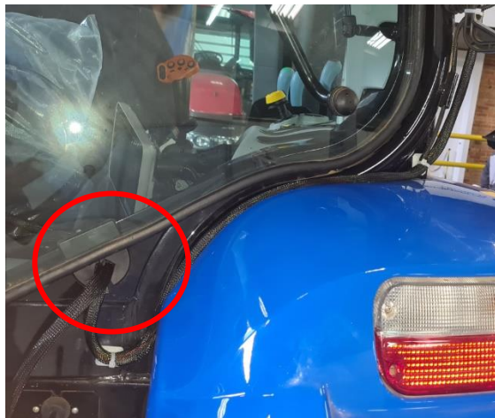
Figura 17 - Ponto de acesso dos cabos à cabine do trator
