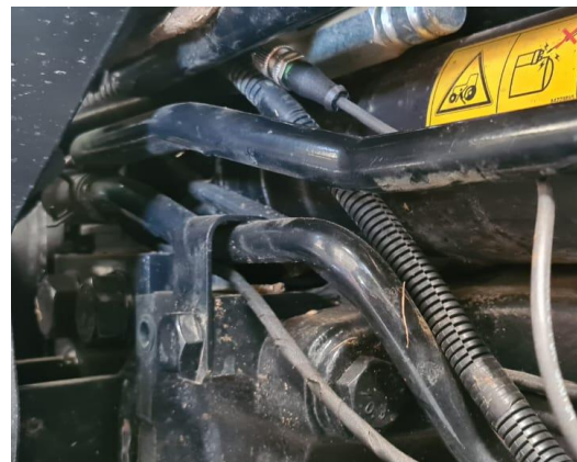
Figura 13 – Local de passagem do chicote utilizando o isolamento térmico
