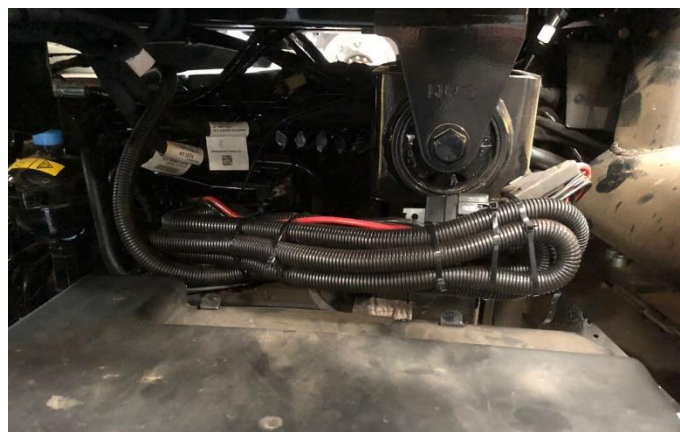
Figura 4 – Fixação sobre a caixa de bateria
