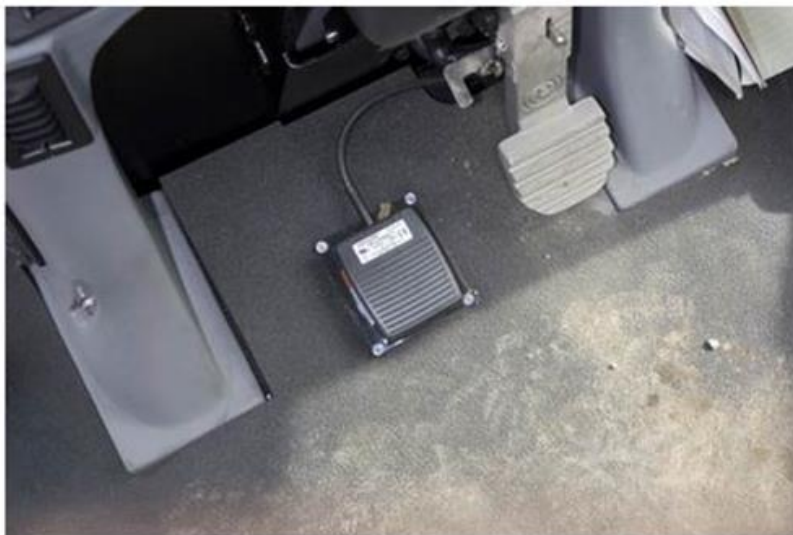
Figura 21 – Fixação do pedal de acionamento do Piloto automático
