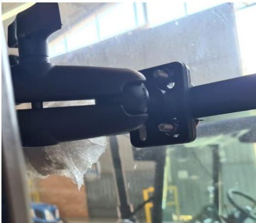
Figura 26 - Fixação do CR7 à cabine
