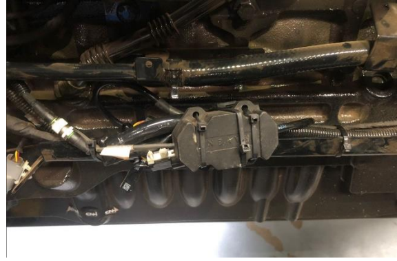
Figura 12 – Fixação do chicote trator short
