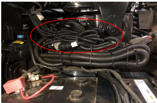
Figura 14 – Fixação do chicote adaptador do sensor de ângulo de roda
