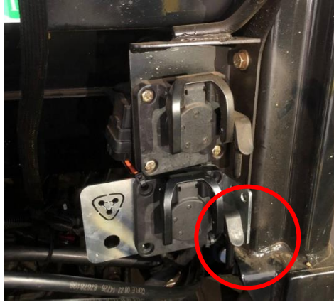
Figura 5 – Fixação da tomada IBBC anexo a original do trator
