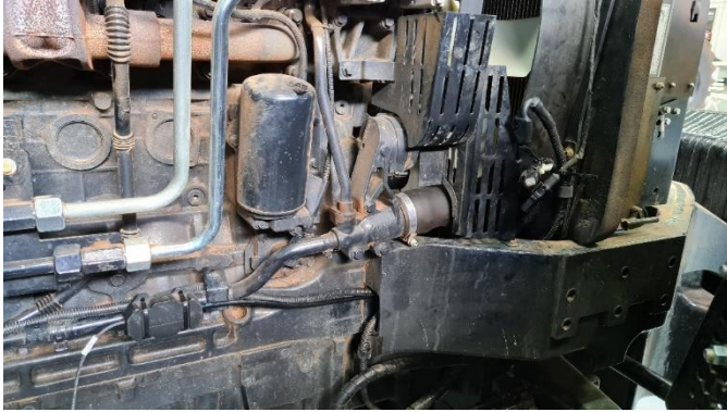
Figura 11 – Fixação do chicote no trator long.
