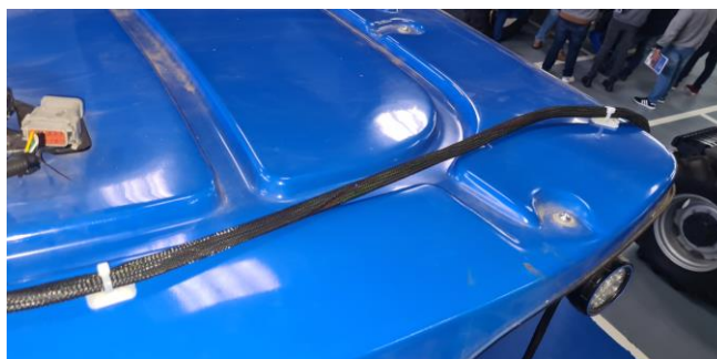
Figura 19 – Fixação do chicote RS1 no teto da cabine
