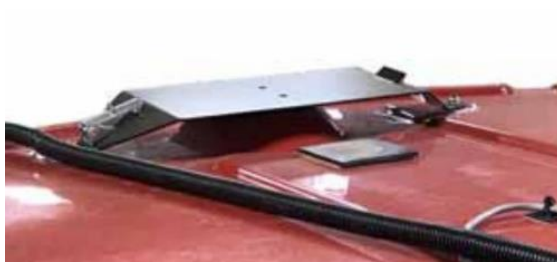
Figura 25 – RS1 fixada no teto da cabine
