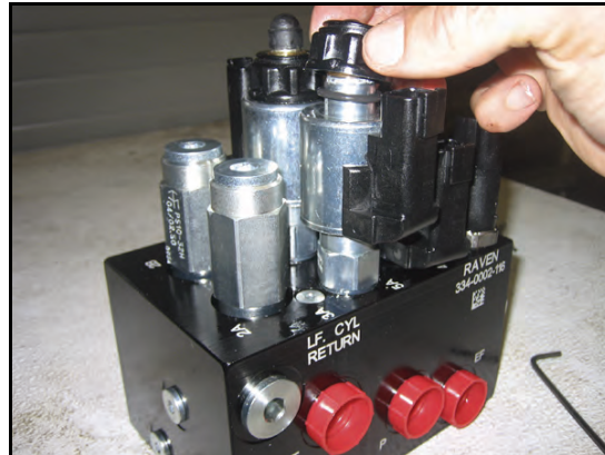
FIGURA 7. Mola Reinstalada na Válvula AutoBoom
