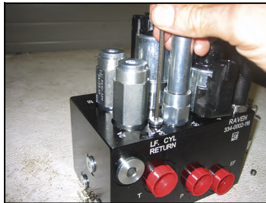
FIGURA 19. Plugs de Porta Reinstalados na Válvula AutoBoom
