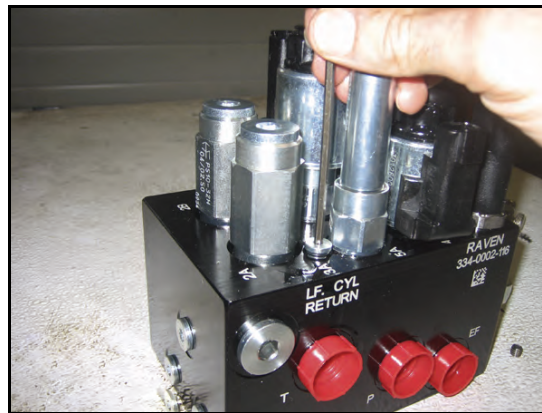
FIGURE 19. Ficha de puerto reinstalada en la válvula AutoBoom
