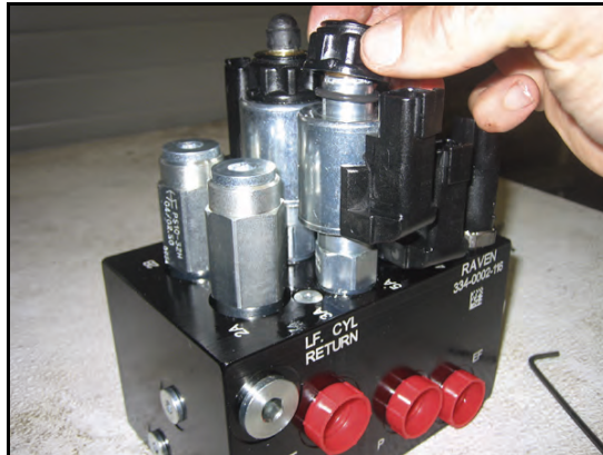
FIGURE 7. Bobina reinstalada en la válvula AutoBoom
