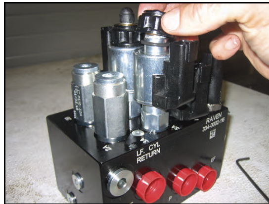
FIGURE 19. Bobina reinstalada en la válvula AutoBoom
