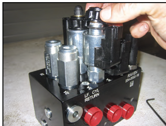
FIGURE 20. Bobina reinstalada en la válvula AutoBoom
