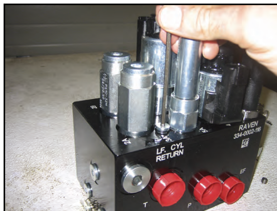
FIGURA 7. Plugs de Porta Reinstalados na Válvula AutoBoom
