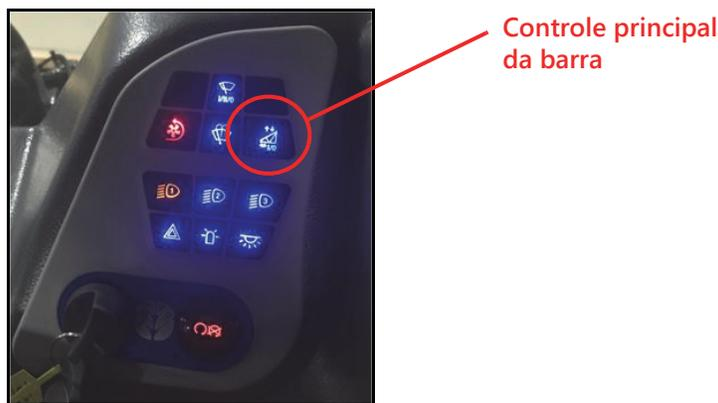
**OBSERVAÇÃO:** O status da Chave principal vai alternar automaticamente para Ligado depois de completar o ciclo AutoFold Out para a posição de pulverização. O status vai alternar automaticamente para Desligado quando o AutoFold começar a dobrar as barras para a posição de transporte. Sem o AutoFold, o status vai alternar automaticamente para Desligado quando as barras estiverem perto da posição dobrada.
