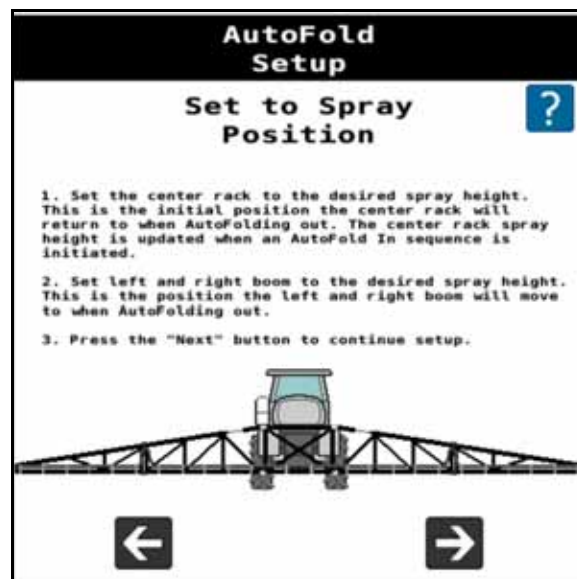
FIGURA 34. Colocar las plumas y el bastidor central en la posición de pulverización
