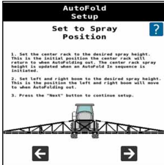
FIGURA 6. Calibración del sensor central vertical: Configuración a posición de pulverización
