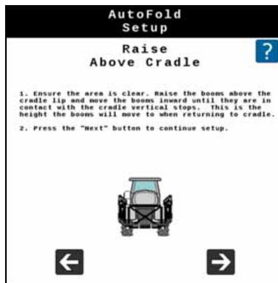
FIGURA 5. Configuración de plegado de IntelliHeight: Elevar por encima de la plataforma
