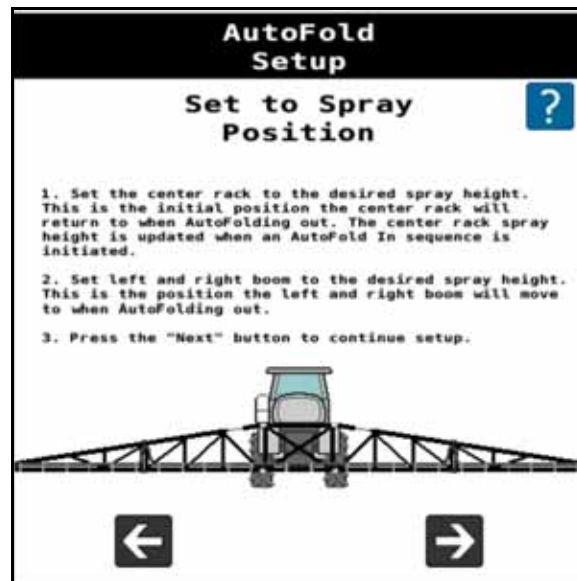
FIGURA 33. Colocar las plumas y el bastidor central en la posición de pulverización
