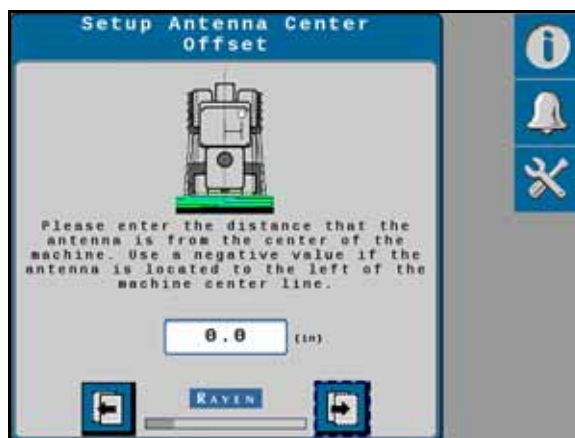
FIGURA 25. Tela de deslocamento do centro da antena
