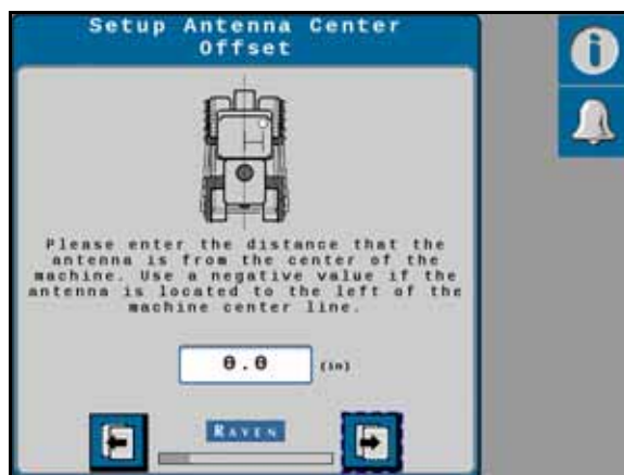
FIGURA 7. Tela de deslocamento do centro da antena
