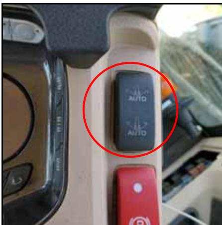
2. Отпустите переключатель AutoFold после того, как штанга достигнет положения для опрыскивания.
