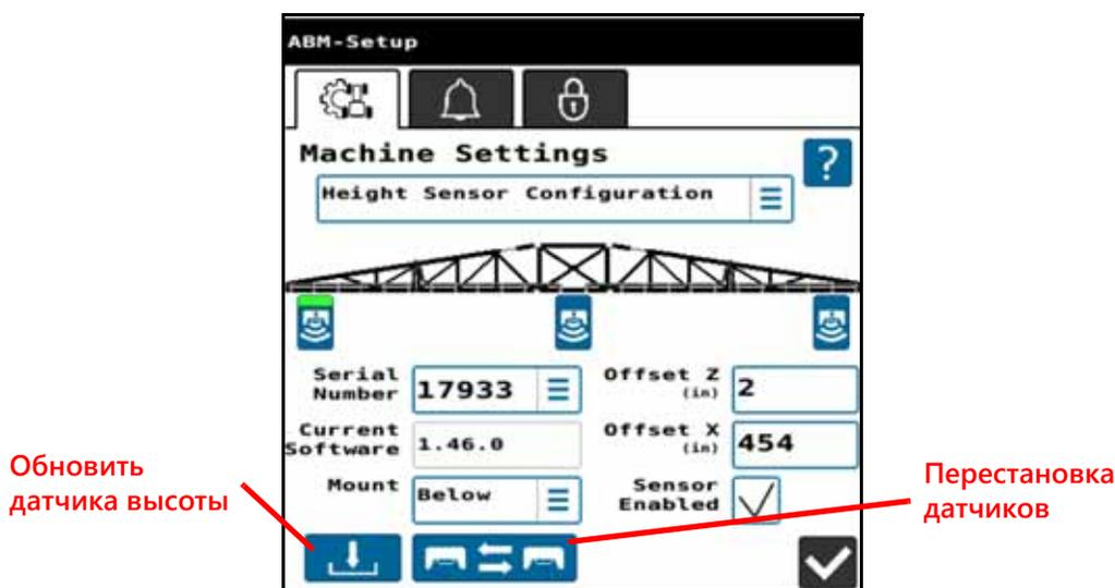
Выберите различные датчики, показанные на штанге для опрыскивания, чтобы изменить конфигурацию этих датчиков.
