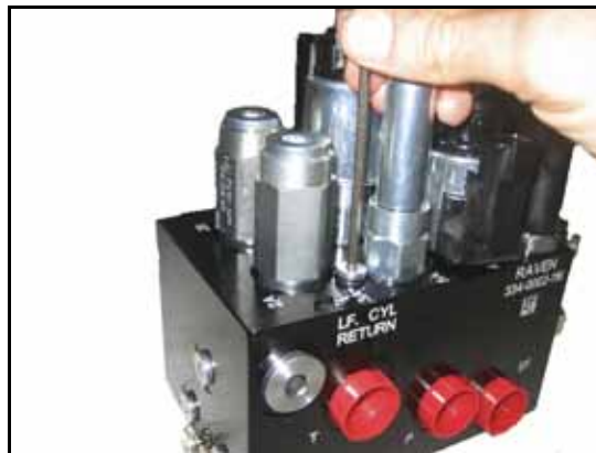
РИСУНОК 16. Перевстановлення заглушки порту на клапані AutoBoom
