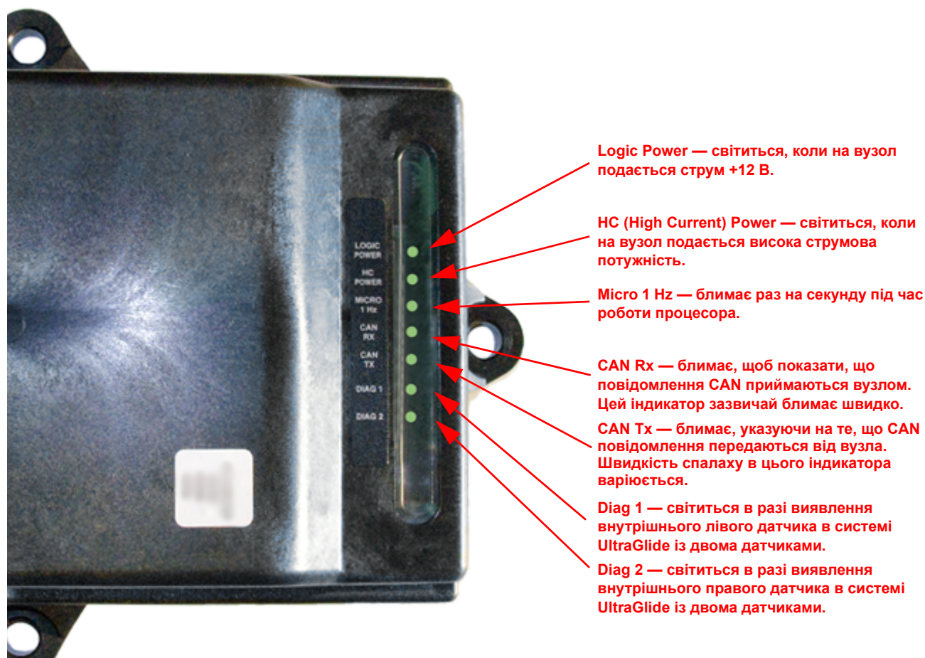
РИСУНОК 1. Світлодіоди вузла керування AutoBoom CAN
