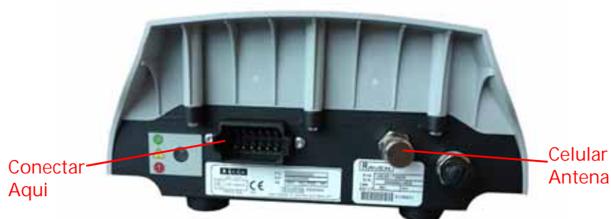
FIGURAS 6. Conexão do Chicote no RS1
