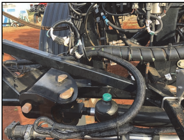
FIGURA 5. Recomendación de Ruteo Cable Interfaz de Sección
