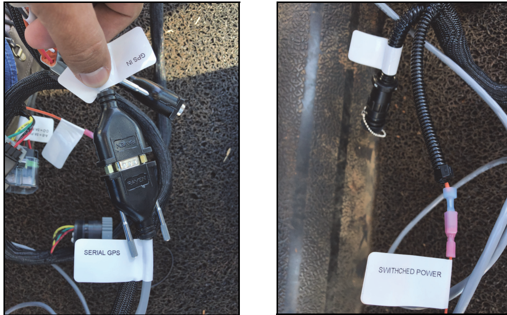
FIGURA 4. Conexión del DB9 y el Cable Naranja de Ignición
