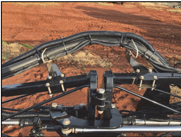
FIGURA 5. Conexión de los cables primarios y secundarios en el punto de pliegue del medio de la barra
