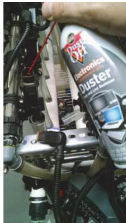
FIGURA 3. Utilice un limpiador de contacto para componentes electrónicos
