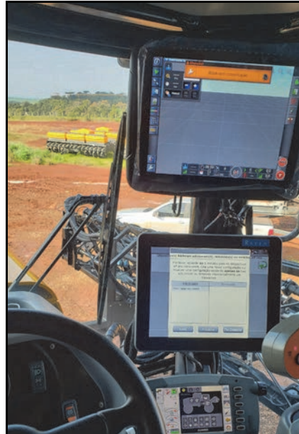
Display Viper 4 Instalado
