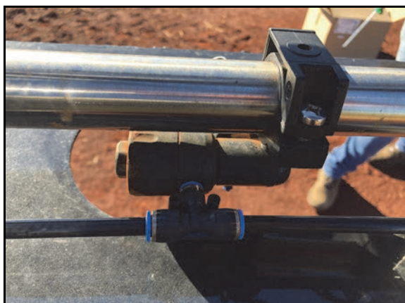
FIGURA 3. Cómo quitar las válvulas neumáticas del sistema
