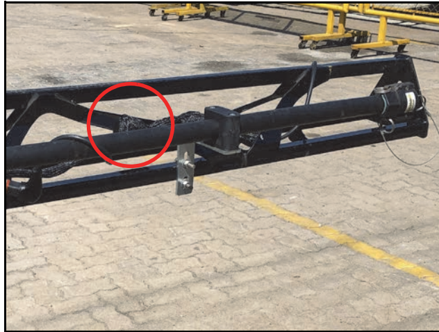
FIGURA 3. Terminador ISOBUS de los cables secundarios de la barra
