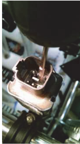
FIGURA 2. Cómo eliminar residuos con un cepillo metálico
