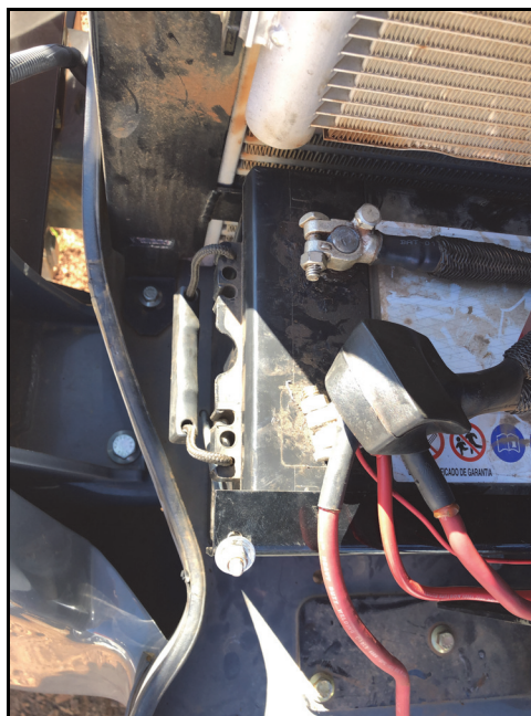
FIGURA 3. Cables POWER del Chasis y de Hawkeye Conectados a la Batería
