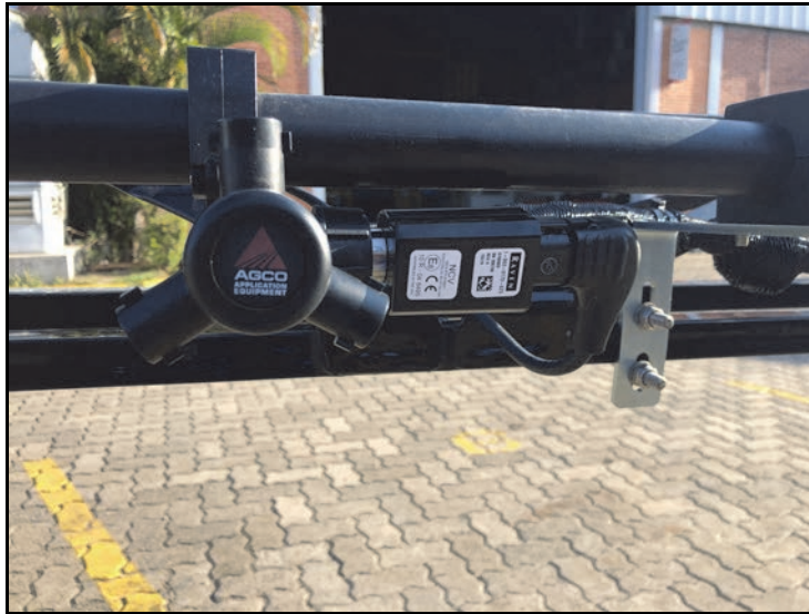
FIGURA 2. VÁLVULA DE BOQUILLA INSTALADA
