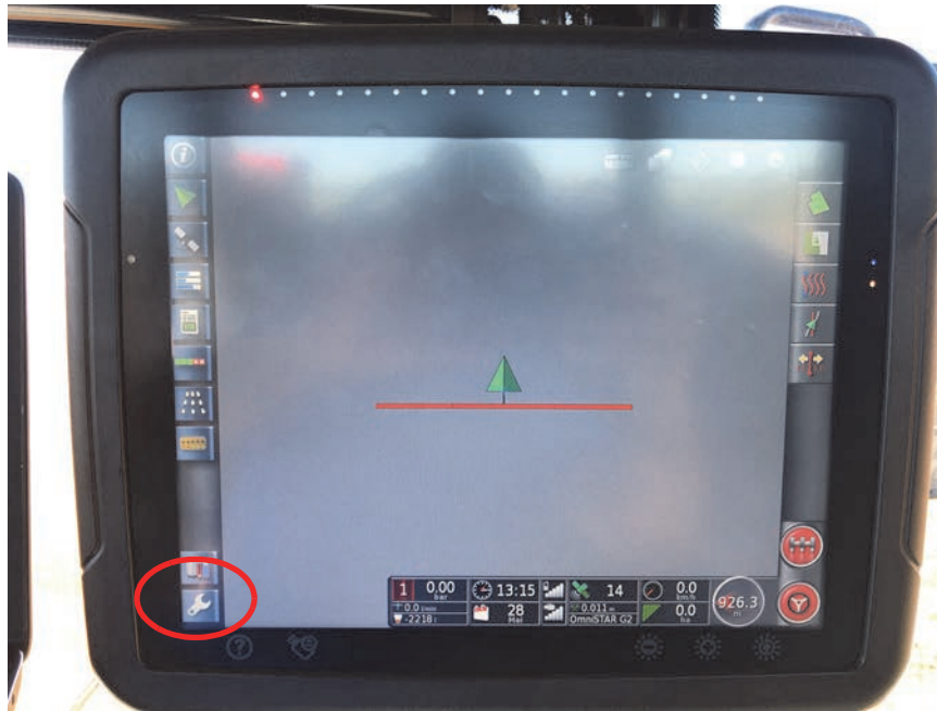
FIGURA 5. Cómo ingresar a las Configuraciones de Barra del Pulverizador
