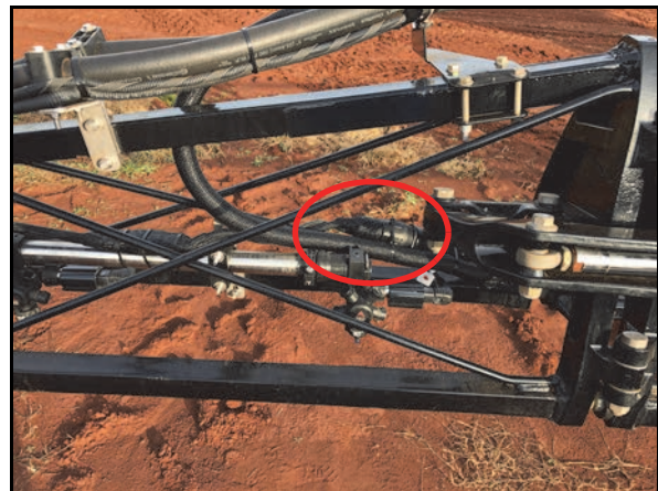
FIGURA 5. Conexión de los cables primarios y secundarios en el punto de pliegue del medio de la barra
