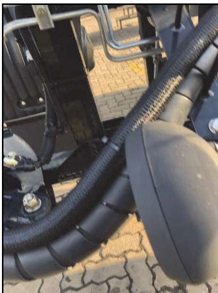
FIGURA 5. Recomendación de Ruteo Cable Interfaz de Sección
