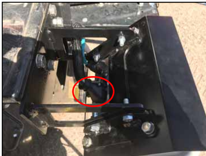
РИСУНОК 10. Подключение камеры VSN
