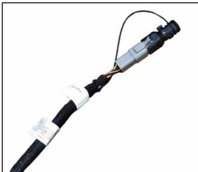
РИСУНОК 11. 6-контактный разъем кабина/видео на кабеле VSN навесного оборудования
