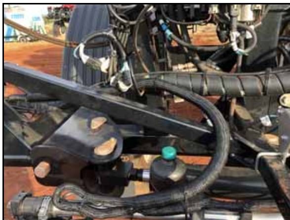
FIGURA 5. Recomendação de Roteamento Cabo Interface de Seção
