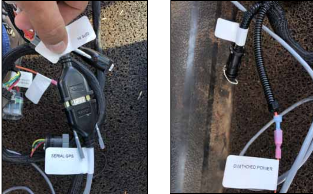
FIGURA 4. Conexão do DB9 e o Fio Laranja de Ignição
