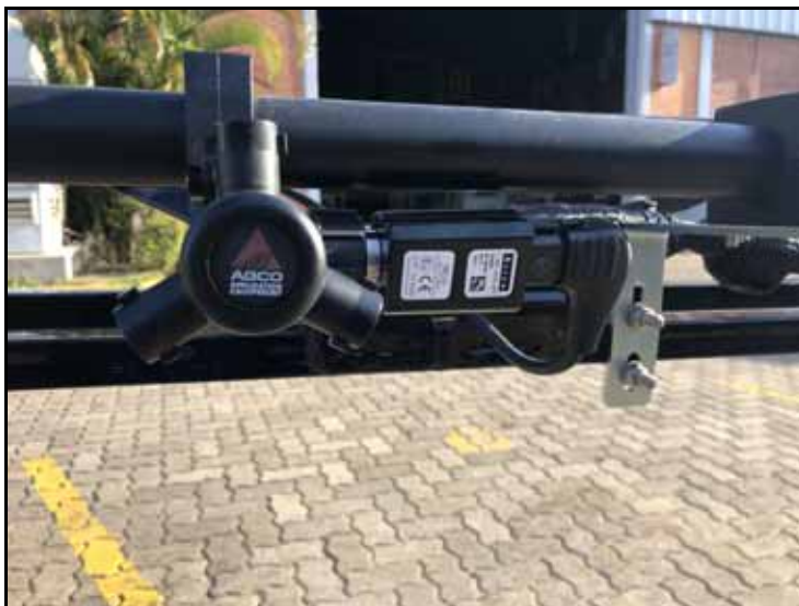
FIGURA 2. VÁLVULA DE BICO INSTALADA
