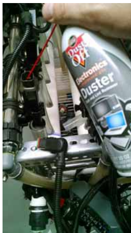
FIGURA 3. Utilize limpa contato para componentes eletrônicos
