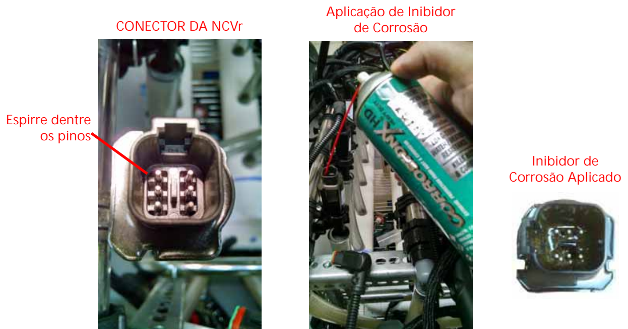
FIGURA 4. Aplicando CorrosionX após a limpeza
