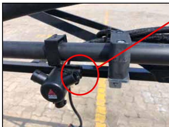
FIGURA 1. Tampa e diafragma removidos do corpo de bico
