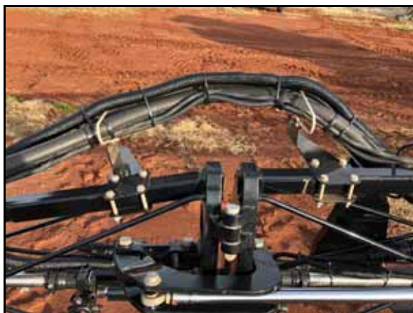
FIGURA 5. Conexão dos cabos primários e secundários no ponto de dobra do meio da barra
