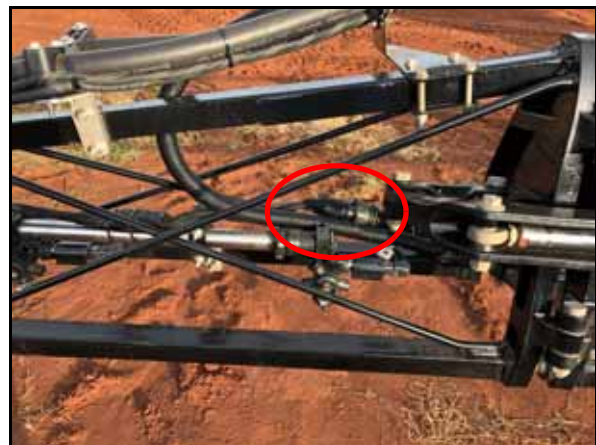
FIGURA 5. Conexão dos cabos primários e secundários no ponto de dobra do meio da barra
