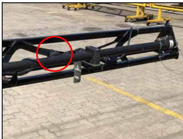
FIGURA 3. Terminador ISOBUS dos cabos secundários de barra
