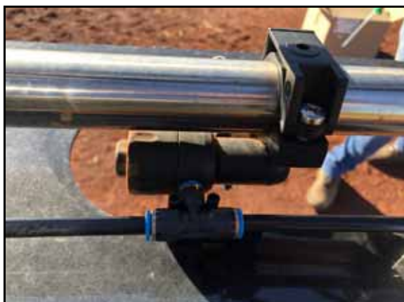
FIGURA 3. Removendo as válvulas pneumáticas do sistema
