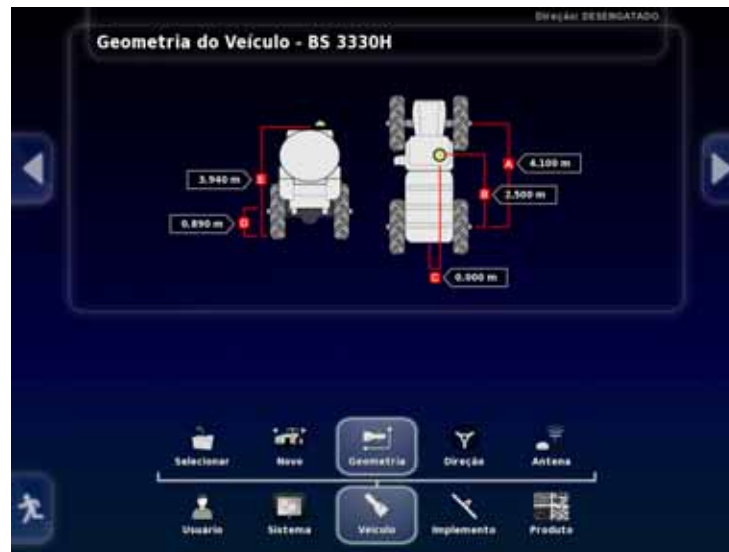
FIGURA 7. Verificando os Offsets de posicionamento da antena de GPS
