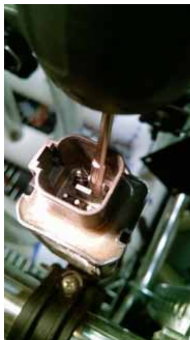
FIGURA 2. Removendo resíduos com escova metálica
