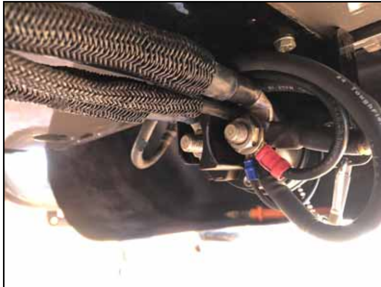
FIGURA 2. Cabos GND do Chassis e do Hawkeye Conectados a Chave Geral
