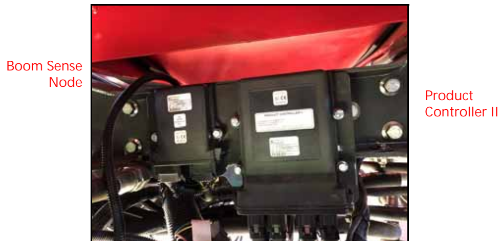
FIGURA 3. Módulos PCII e Boom Sense Instalados
