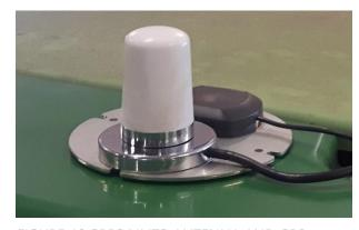
FIGURE 46 GPRS/UMTS-ANTENNA AND GPS PATCH ANTENNA ON A METAL BRACKET.
