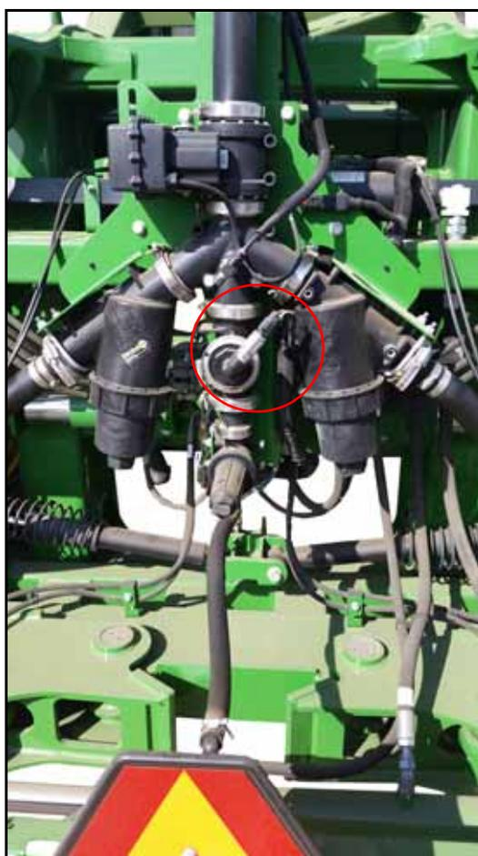
9. Use os acessórios de polipropileno NPT fornecidos para adicionar o sensor de pressão fornecido ao sistema.
