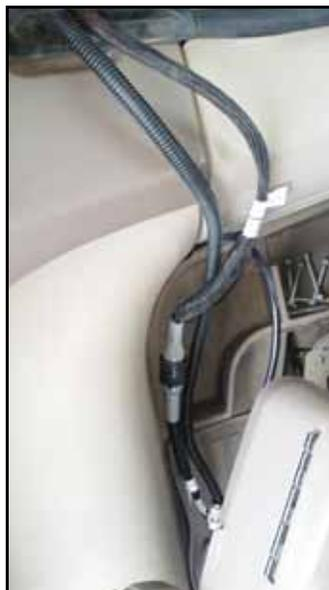
4. Direcione a extremidade do cabo com os terminais positivo e negativo em direção ao compartimento da bateria, próximo ao lado esquerdo dianteiro do pulverizador.
