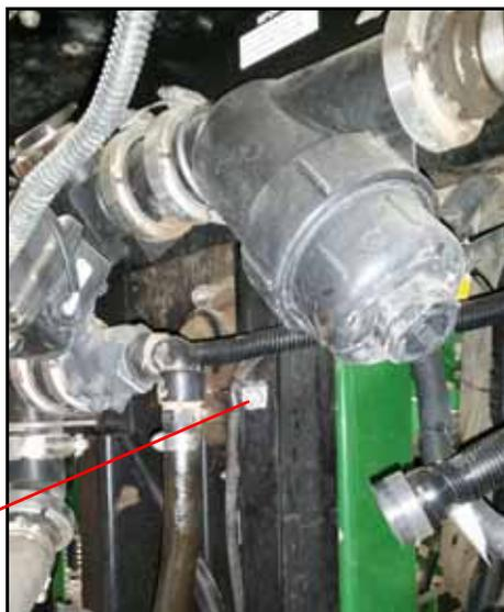
**NOTA:** Nas máquinas da série 40, use o orifício indicado para conectar a ECU e o suporte à máquina.
