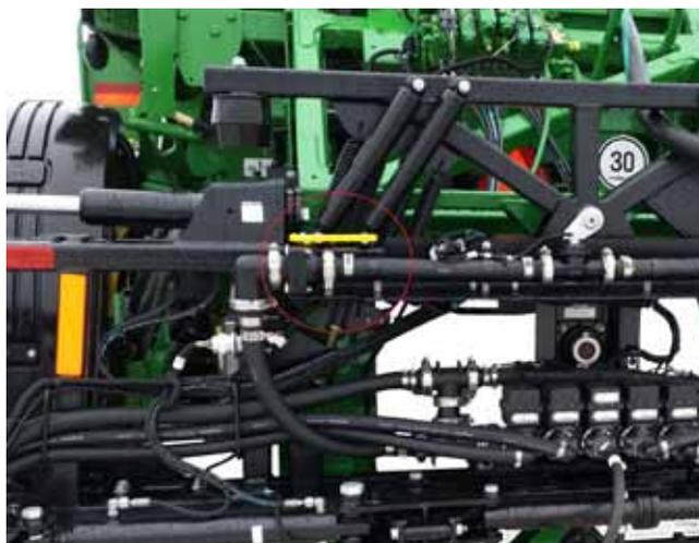
FIGURA 4. Válvula de estrangulamiento 4940
