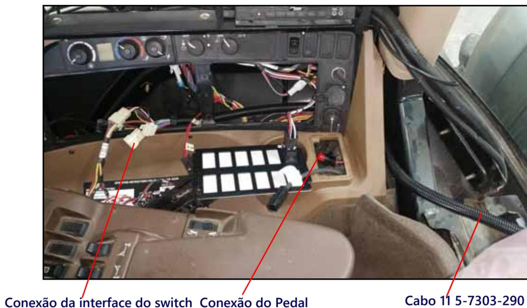
7. Conecte o cabo do interruptor de pedal ao cabo 115-7303-290.
