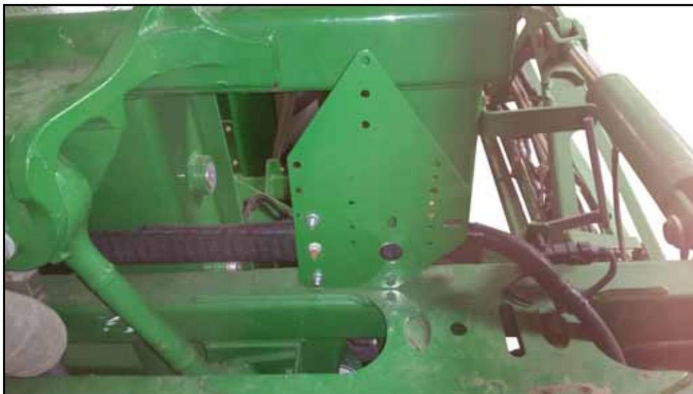
**NOTA:** Monte o controlador para que as conexões elétricas estejam voltadas para baixo.
