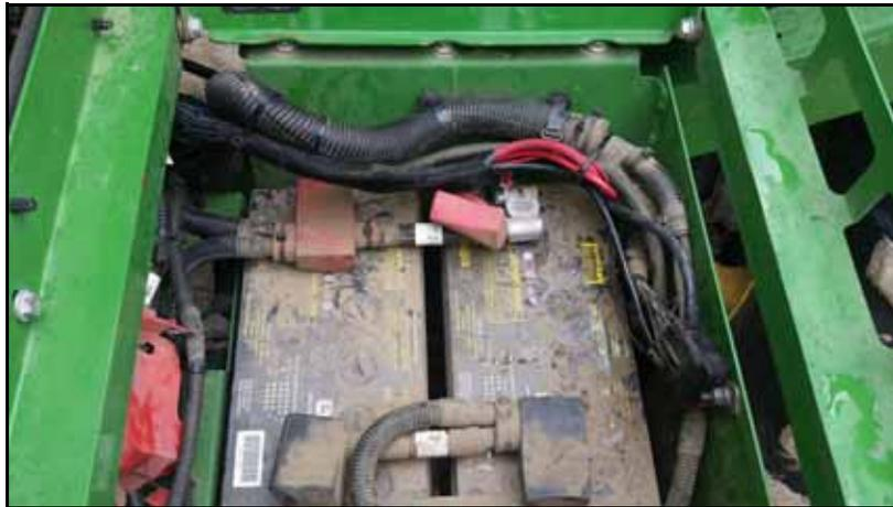
9. Encaminhe as extremidades restante do Cabo de Energia do Hawkeye e do Cabo do Chassis para o Product Controller II instalado anteriormente.
