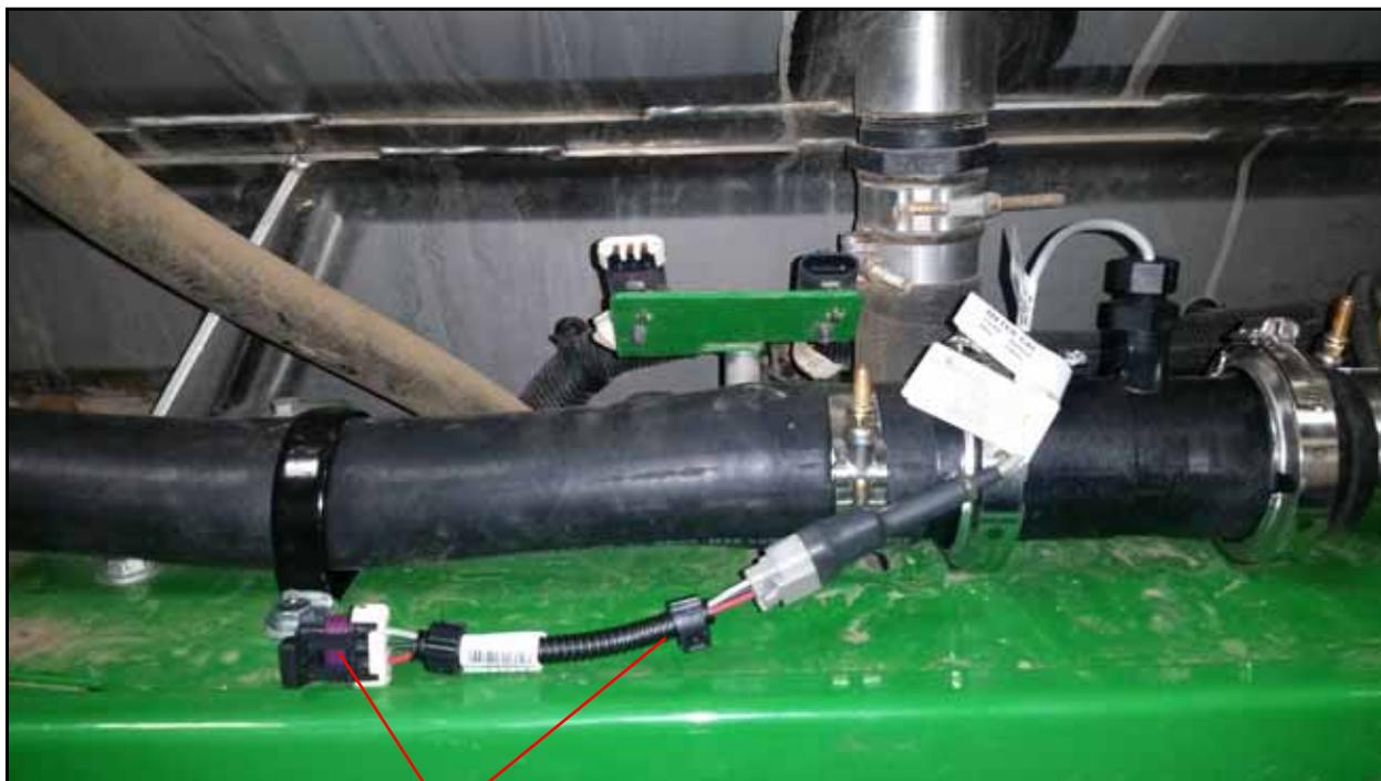
Cabo adaptador do fluxômetro
