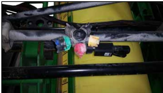
**NOTA:** Pode ser necessário realocar os suportes de suspensão da lança de fábrica para fornecer folga adequada. Suportes e hardware são fornecidos para realocar os suportes de suspensão da lança se eles não puderem deslizar para um novo local.
