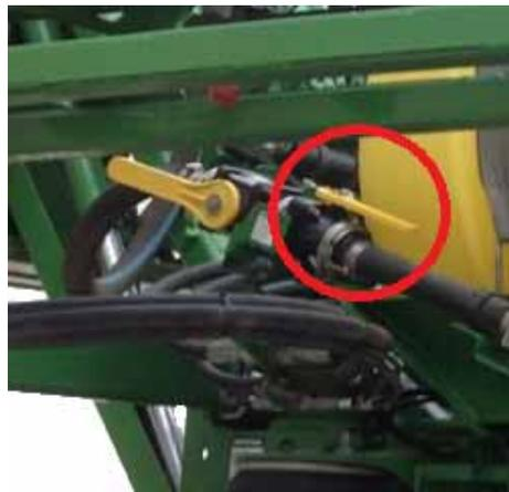
FIGURA 3. Válvula de estrangulamiento 4730-4830
