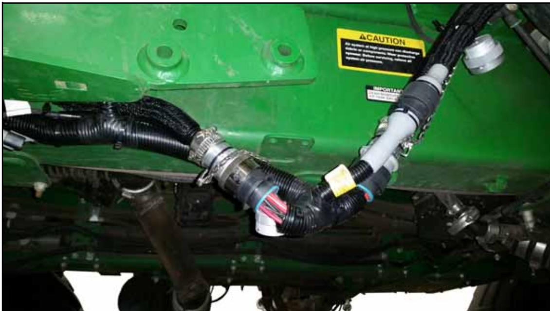
8. Conecte novamente o terminador CANbus à outra extremidade do cabo de extensão de injeção Hawkeye.
