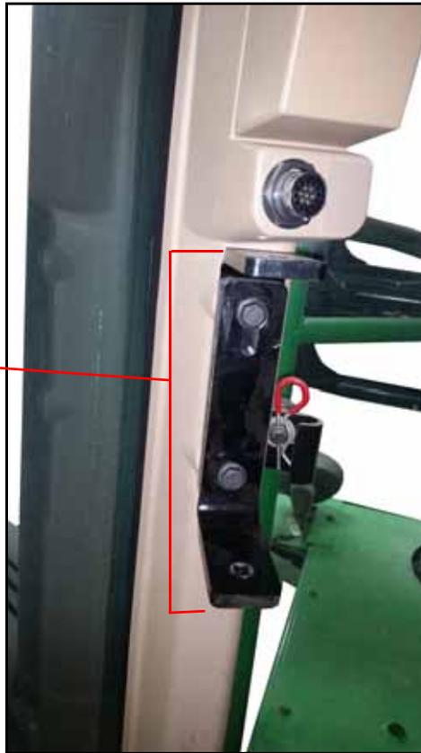
4. Use o hardware original para reinstalar o monitor primário no suporte inferior.
