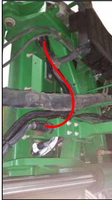
FIGURA 5. Recomendação de Roteamento para as máquinas série 40.
