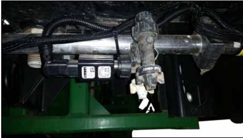
6. Em cada ramificação de válvula, ajuste o cabo conforme necessário para fornecer folga entre as conexões da válvula de controle dos bicos. O conector redondo grande no cabo secundário deve atingir o ponto de dobra da lança intermediária após a conexão das válvulas de controle dos bicos.
