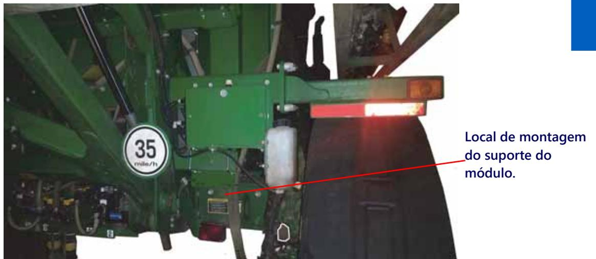
5. Monte o suporte dos módulos com estes voltados para a frente da máquina. Use os parafusos em U fornecidos e as porcas de flange 3/8" - 16.
