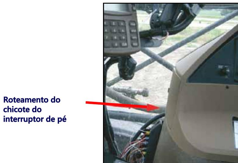
6. Encaminhe o cabo 115-7303-290 para a cabine pela entrada da janela traseira. Passe o cabo atrás da caixa do painel de controle.
