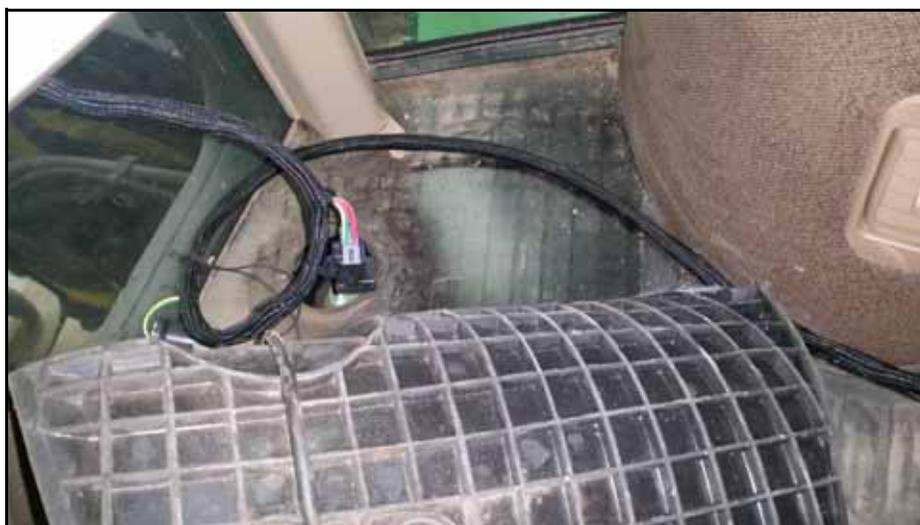
16. Conecte o cabo do monitor ao cabo vindo da StarFire. Use a tabela abaixo para corretamente acoplar cada conector.
