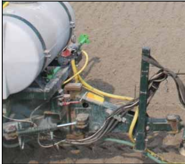
ABBILDUNG 5. Winkelsensor-Montage am Seitenschieber-Adapterrahmen
