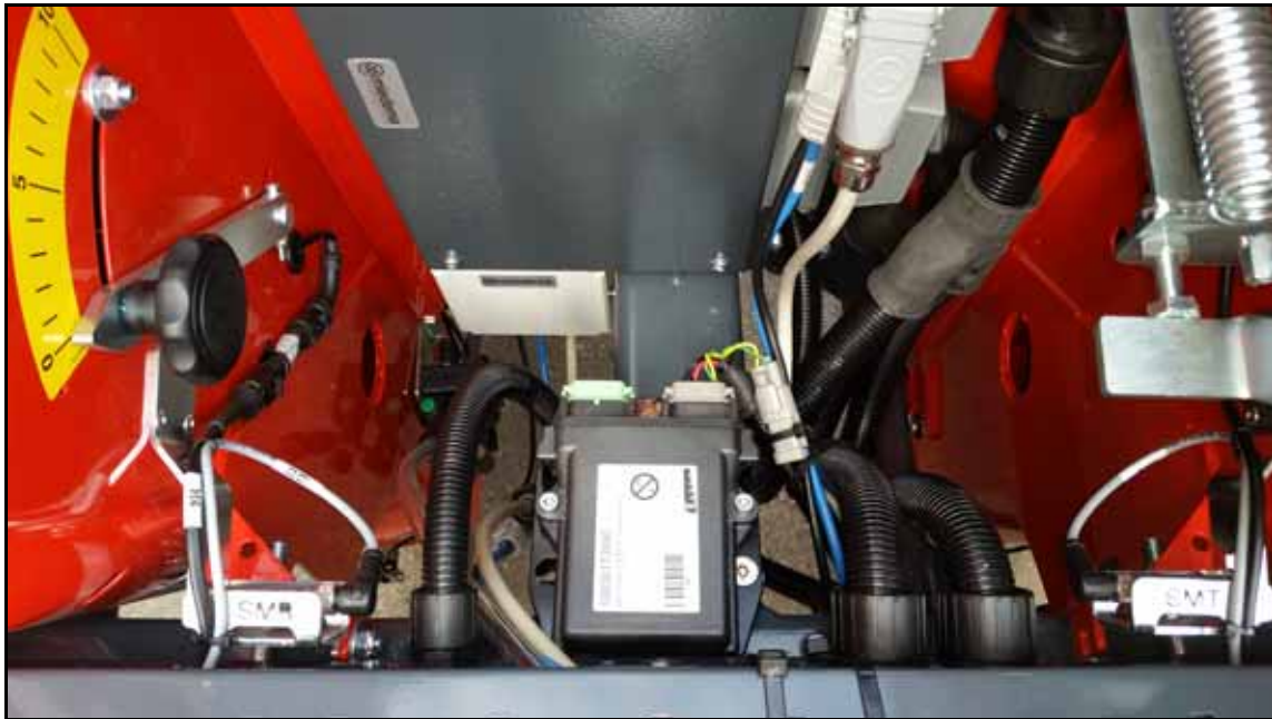
ABBILDUNG 10. Montierte SC1 ECU
