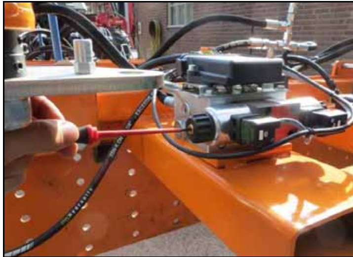
ABBILDUNG 8. Stift des Proportionalventils für manuelle Lenkung
