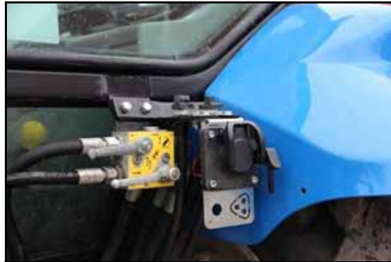
ABBILDUNG 12. IBBC und IBBC-Halterung mit Antennenanschluss
