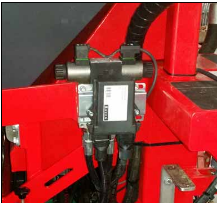
ABBILDUNG 9. Montierte Geräteantriebseinheit (IDU)
