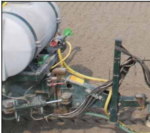
AFBEELDING 5. Montage van hoeksensor op side-shift adapterframe
