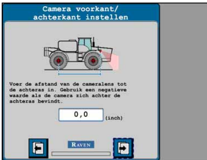
AFBEELDING 2. Positie VSN-camera voorkant/achterkant
