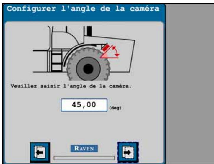
FIGURE 3. Inclinaison de la caméra VSN
