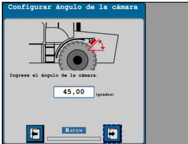
FIGURA 3. Inclinación de la cámara VSN
