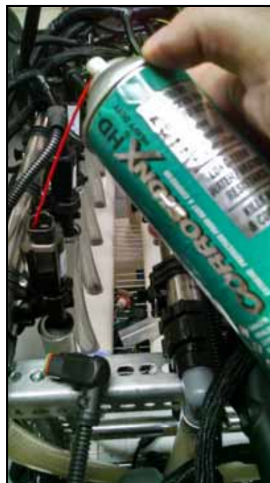
Aplicación del inhibidor de corrosión
