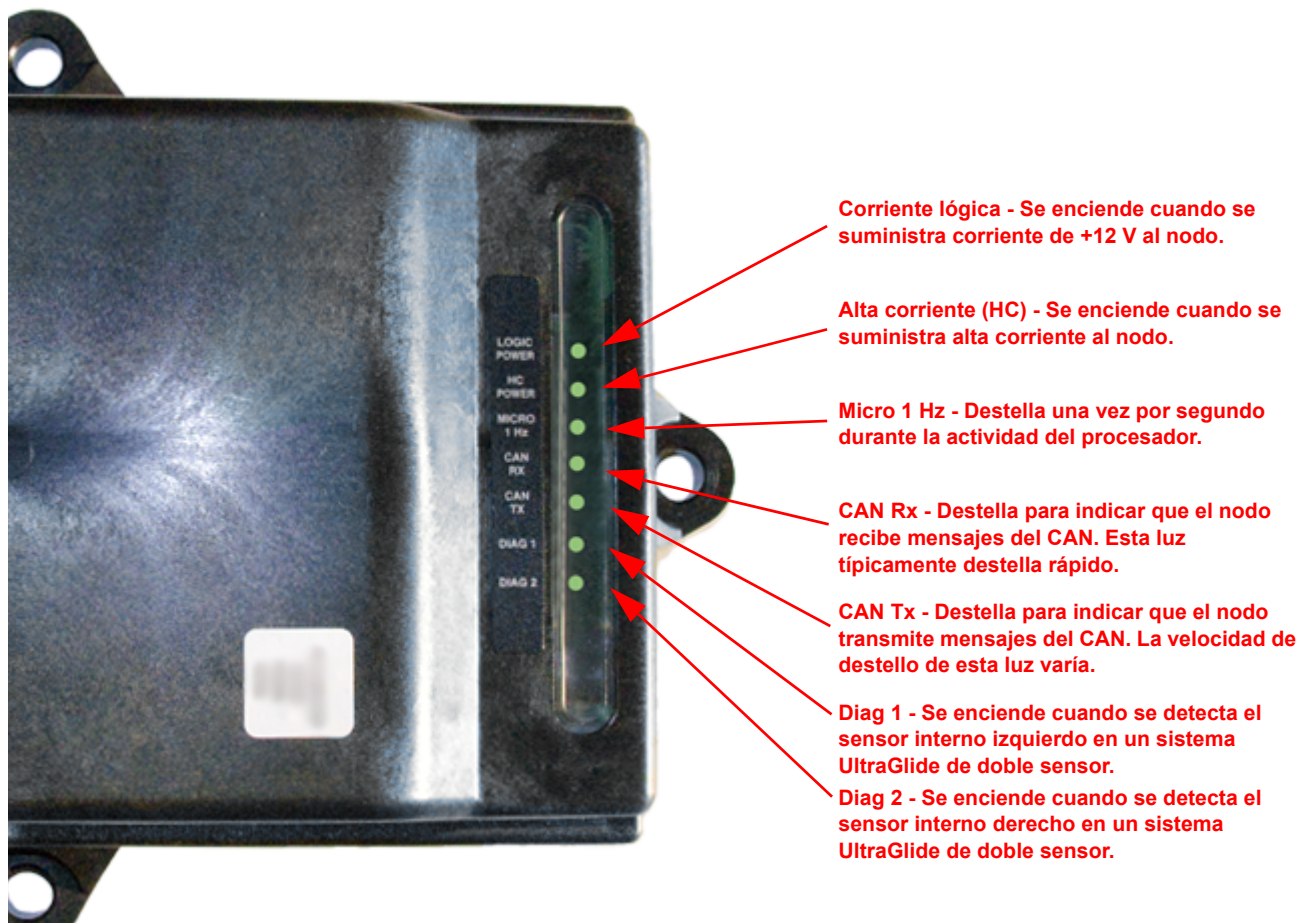
FIGURA 1. LED del nodo de control CAN del AutoBoom
