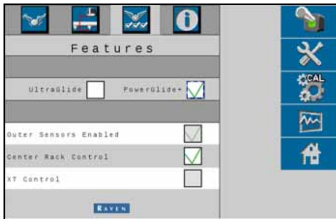
FIGURA 18. Terminal ISO programado para funcionar en el modo PowerGlide Plus
