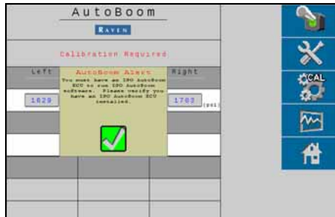
FIGURA 5. Indicación de nodo incorrecto
