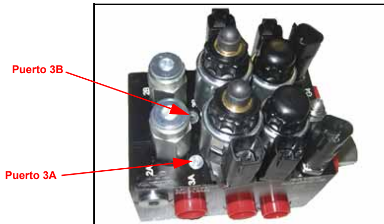
FIGURA 12. Ubicación del Puerto 3A y 3B
