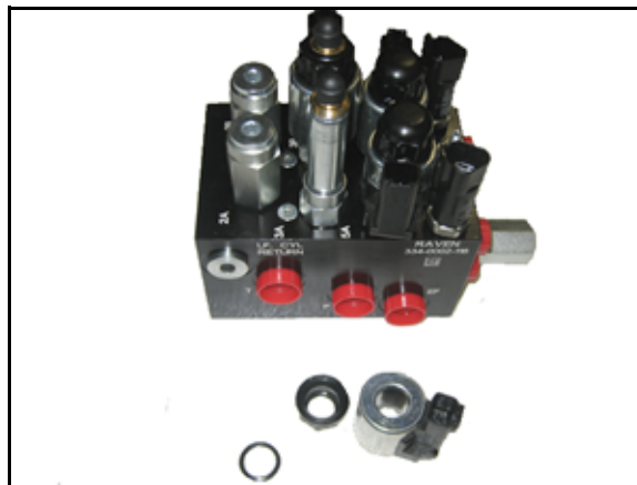
FIGURA 13. Bobina removida de la válvula del AutoBoom
