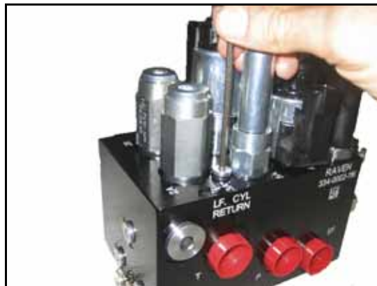
FIGURA 16. Tapón del puerto colocado nuevamente en la válvula del AutoBoom
