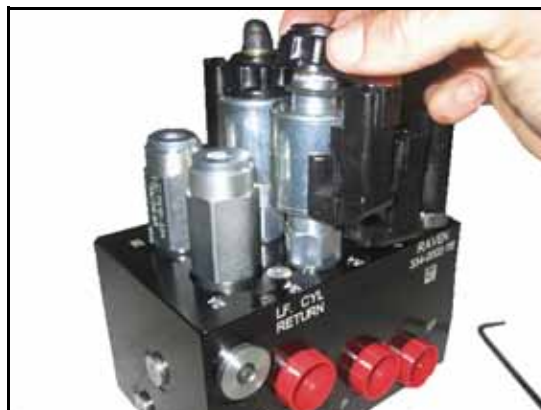
FIGURA 17. Bobina nuevamente instalada de la válvula del AutoBoom
