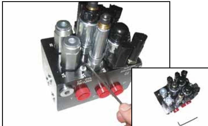
FIGURA 14. Tapones del puerto removidos de la válvula del AutoBoom
