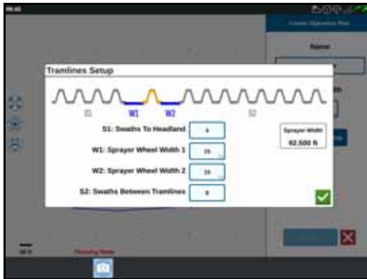
ABBILDUNG 15. Fahrgasse einrichten
