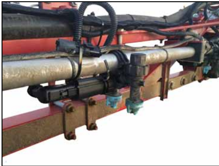
FIGURA 2. Instalação da Válvula de Controle de Bicos Modificados
