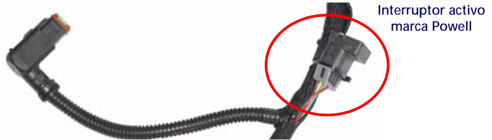
FIGURA 3. Interruptor ISOBUS Powell del cable secundario
