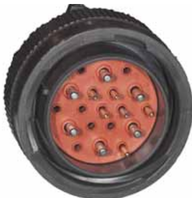
Conexión del conector macho a la rejilla central o al conector en el chasis
