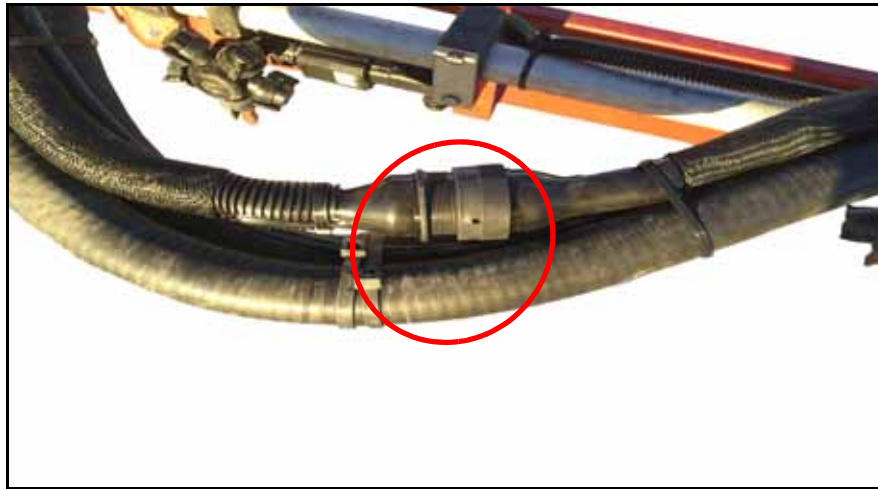
FIGURA 5. Conexión del cable de la botalón de pulverización en los puntos de doblamiento
