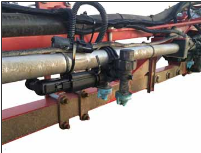
FIGURA 2. Instalación modificada de la válvula de control de la tobera
