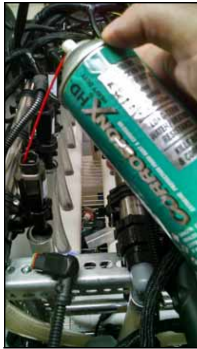
Aplicación del inhibidor de corrosión
