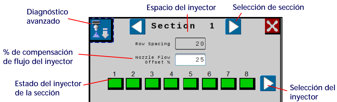
FIGURA 1. Diagnóstico avanzado del inyector
