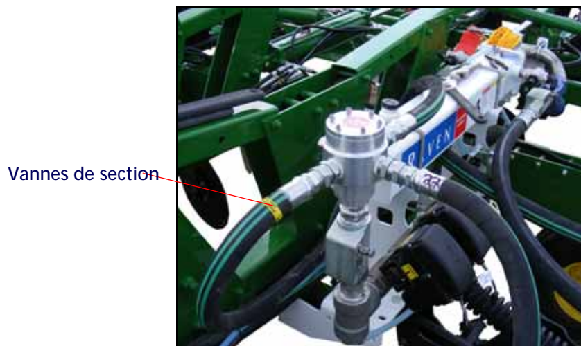
FIGURE 1. Conduites NH 3 installées
