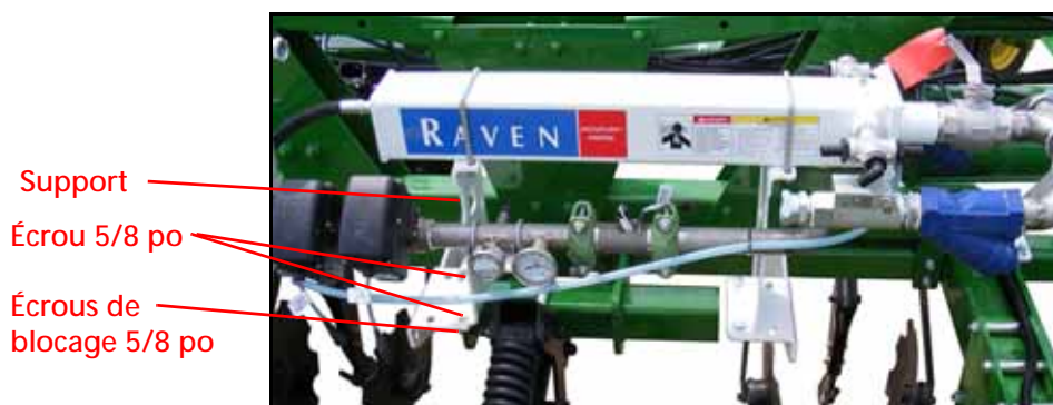
FIGURE 3. Assemblage du montage du refroidisseur
