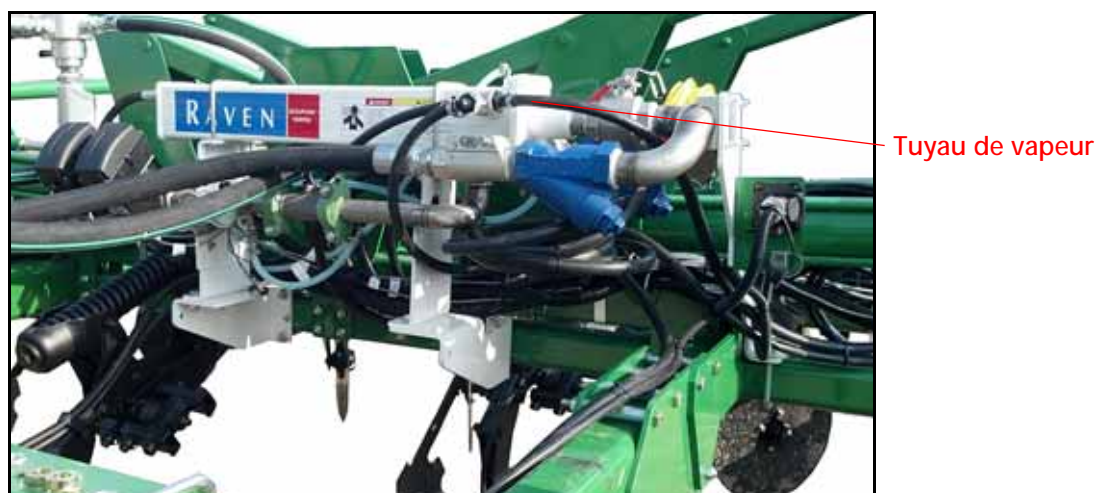
FIGURE 5. Installation du conduit de vapeur
