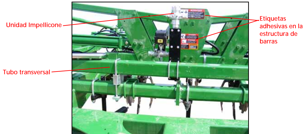
FIGURE 5. Unidad Impellicone instalada mostrando las etiquetas adhesivas
