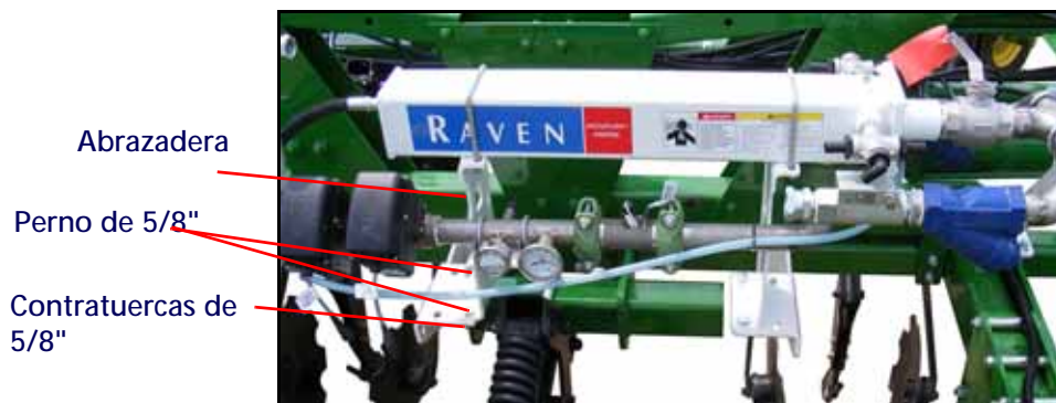
FIGURE 3. Unidad para instalación del enfriador
