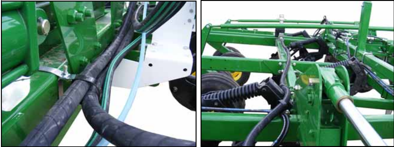
FIGURE 2. Tendido de mangueras conductoras de NH 3
