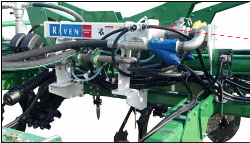
FIGURE 5. Instalación de la línea de gas.
