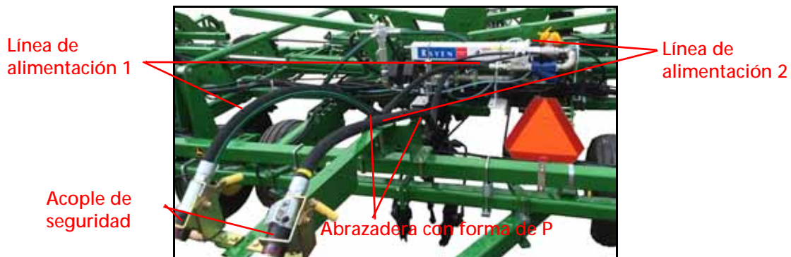
FIGURE 3. Instalación de la línea de alimentación
