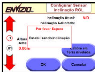
3. Depois que a mensagem desaparece, **ajuste a altura da antena** usando as **setas vermelhas para cima ou para baixo** para aumentar ou diminuir a posição da antena em incrementos de '0.1' ou '0'. Uma vez que você tem a altura da antena ajustada e você está na terra nivelada, toque '**Calibre em Terra nivelada**'.
