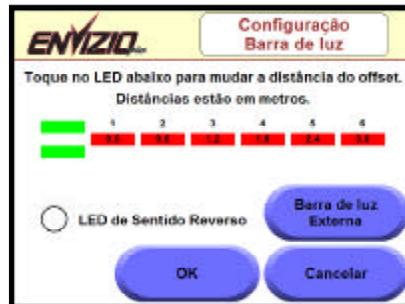
3. Para mudar a distância (offset) para um LED, toque no número do LED (ou na barra abaixo dele) e uma caixa aparecerá em torno deste número, junto com setas abaixo dela. Toque a seta direita ou esquerda para aumentar ou diminuir a distância do offset. Toque **OK** quando as distâncias dos offsets estão ajustados.
