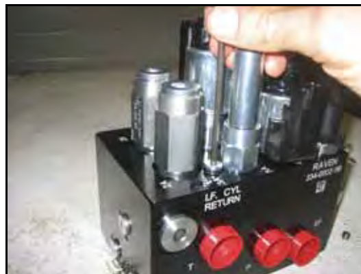
FIGURA 5. Tapoes Reinstalados na Válvula AutoBoom
