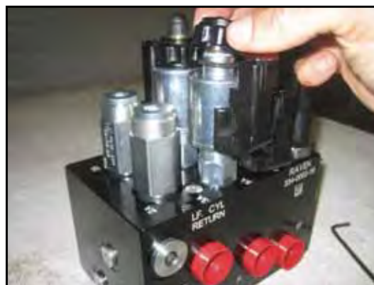
FIGURA 6. Bobina Reinstalado na Válvula AutoBoom
