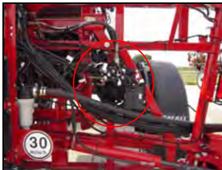
FIGURE 2. Válvula AutoBoom Montada na Máquina
