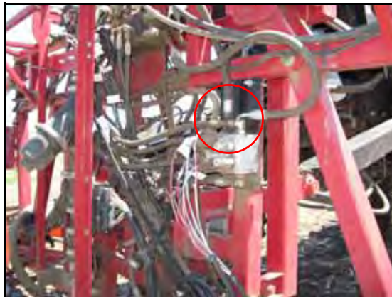
FIGURE 9. Mangueiras de Pressão e do Tanque Instaladas
