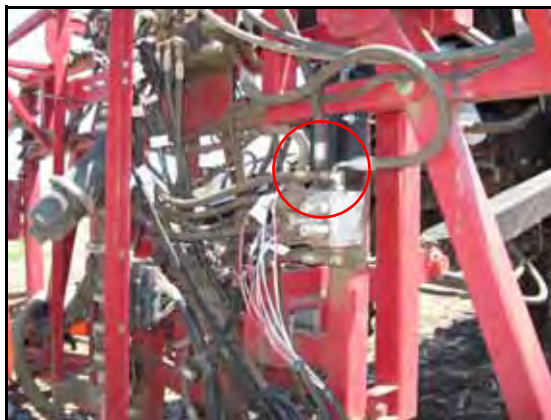
FIGURE 3. Mangueiras de Pressão e do Tanque Instaladas
