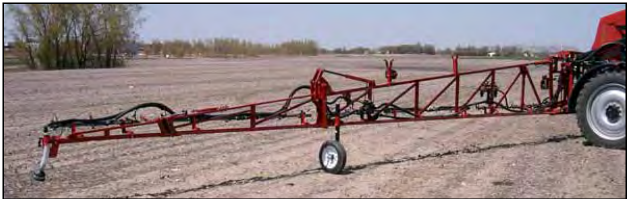
FIGURE 12. Roda Medidora Instalada
