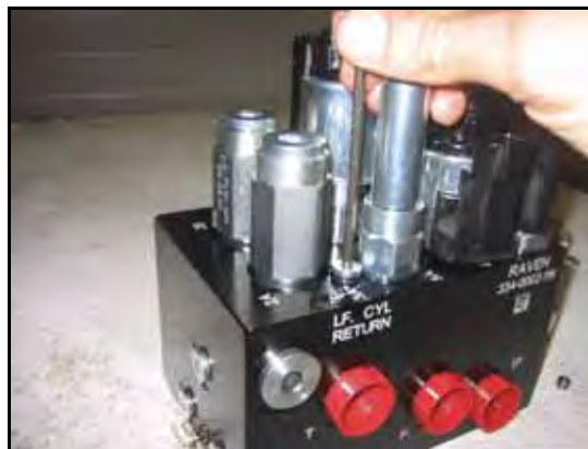
FIGURE 5. Plugs de Porta Reinstalados na Válvula AutoBoom
