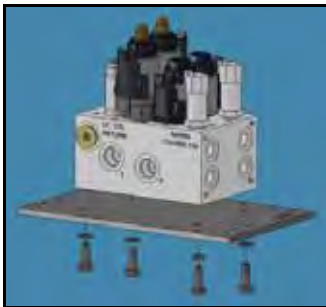
FIGURE 7. Válvula AutoBoom Montada na Placa de Montagem da Válvula
