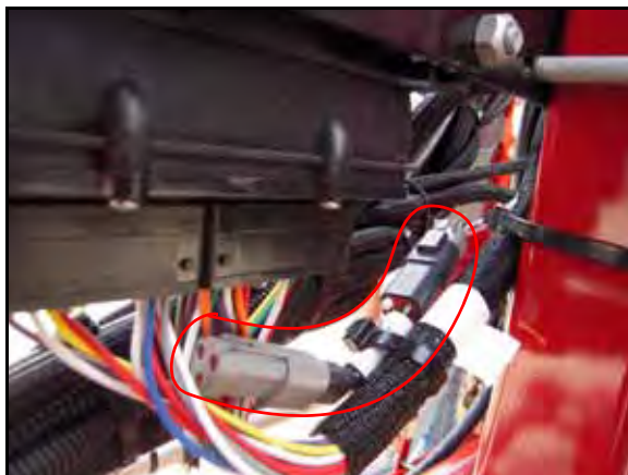
FIGURE 13. Terminador CAN da Máquina Conectado ao Cabo do chicote AutoBoom
