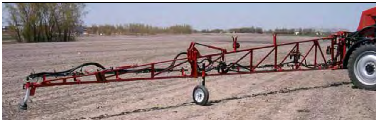
FIGURE 9. Roda Medidora Instalada
