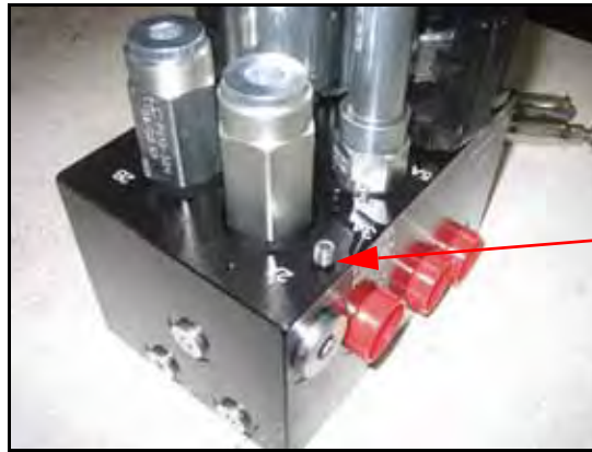
FIGURE 4. Encaixe de Orifício Removido da Válvula AutoBoom
