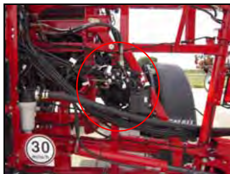
FIGURE 8. Válvula AutoBoom Montada na Máquina
