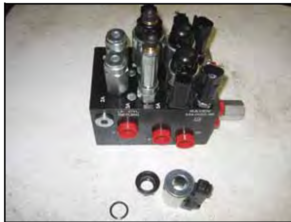
FIGURE 2. Mola Removida da Válvula AutoBoom
