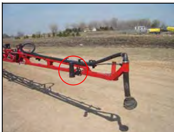
FIGURE 6. Localizações de Montagem do Sensor da Barra
