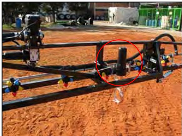
Local de montagem do sensor simples
