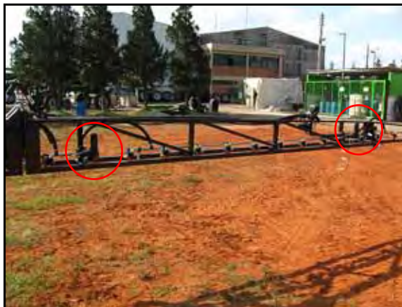
Locais de montagem do sensor duplo (Opcional)
