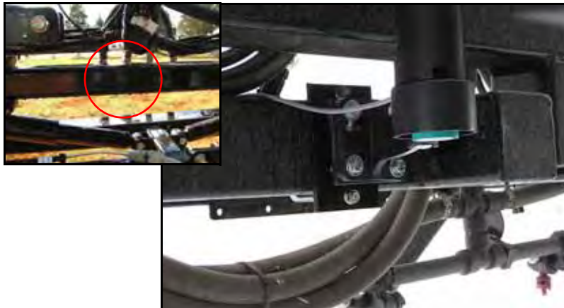
FIGURA 4. Sensor central instalado no suporte central da máquina
