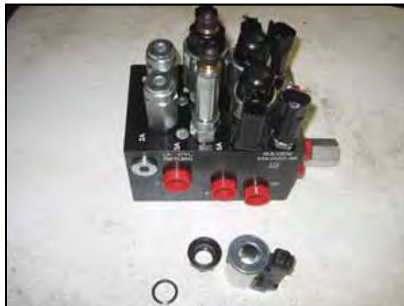
FIGURE 17. Bouchons de ports retirés de la valve de l'AutoBoom
