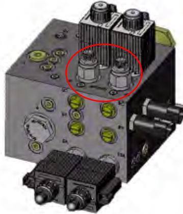
FIGURE 12. Soupapes à pointeau sur la valve d'AutoBoom UltraGlide
