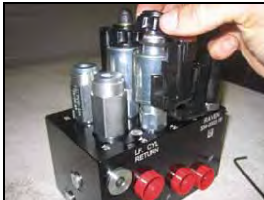
FIGURE 19. Bobine réinstallée sur la valve de l'AutoBoom
