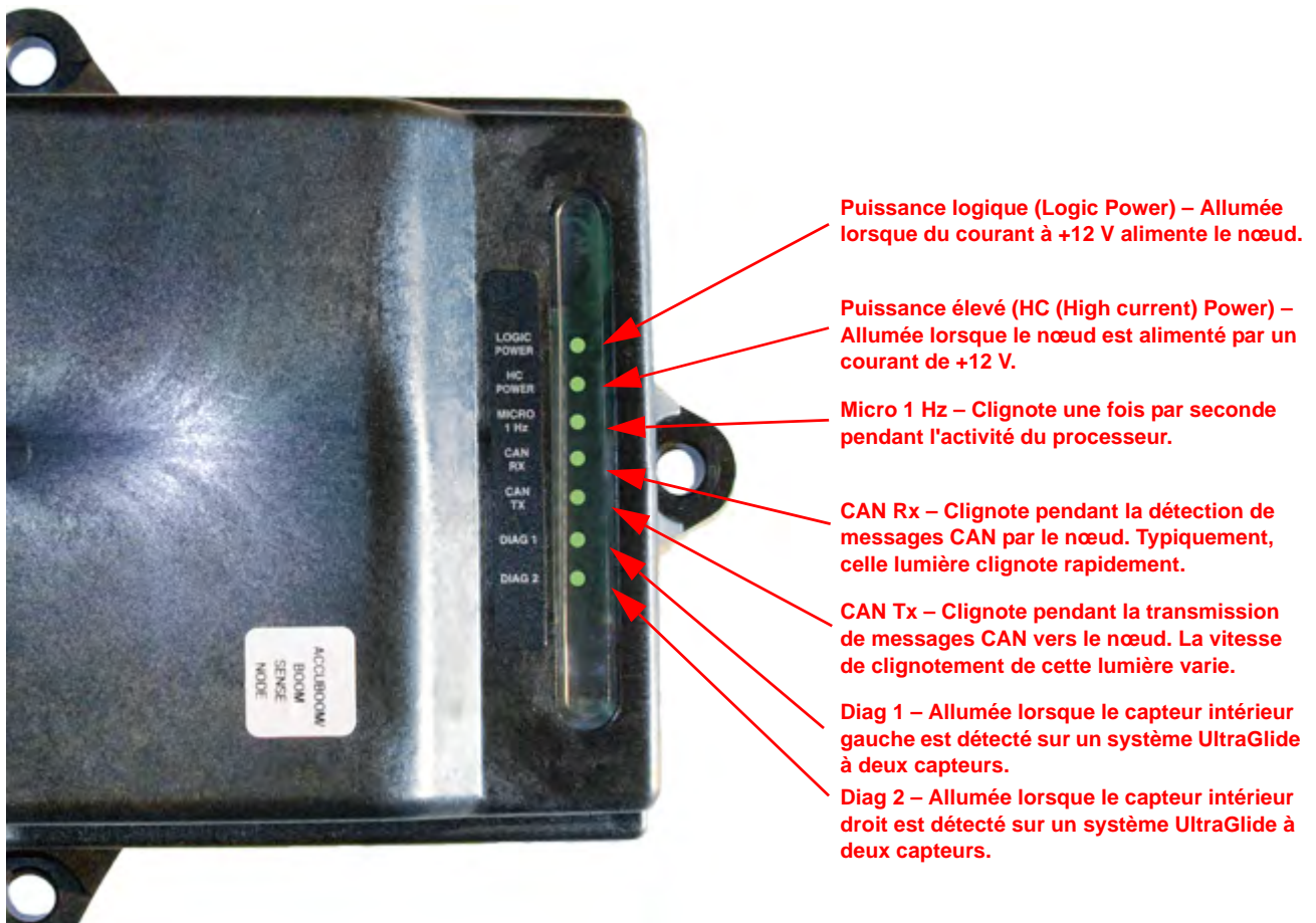
FIGURE 1. DELs du nœud de la commande CAN de l'AccuBoom
