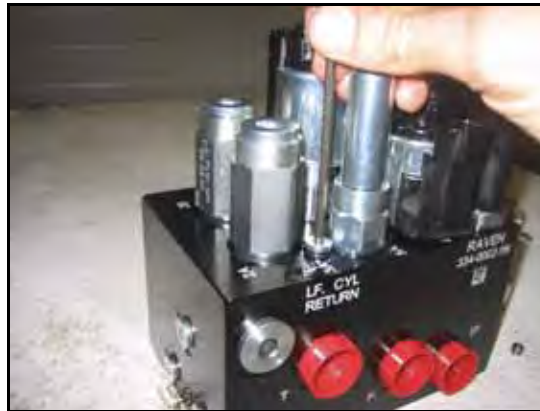
FIGURE 19. Bouchon de port réinstallé sur la valve de l'AutoBoom
