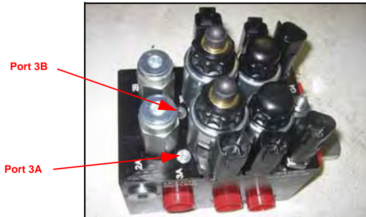
FIGURE 3. Emplacement des ports 3A et 3B
