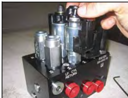
FIGURE 20. Bobine réinstallée sur la valve de l'AutoBoom
