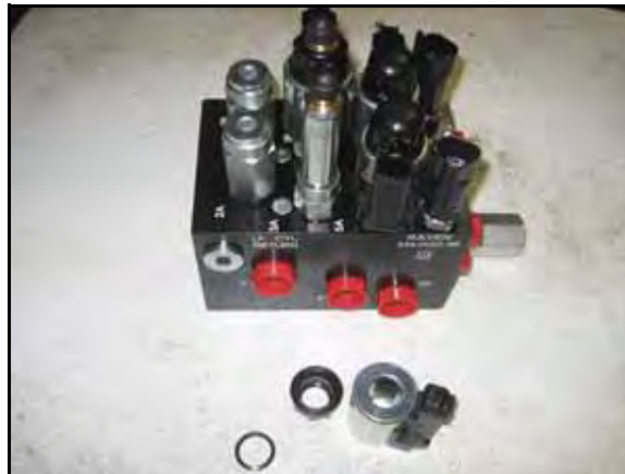
FIGURE 15. Bobine retirée de la valve de l'AutoBoom
