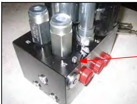
FIGURE 5. Orifices retirés de la valve de l'AutoBoom
