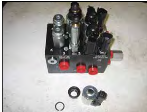
FIGURE 3. Bobine retirée de la valve de l'AutoBoom
