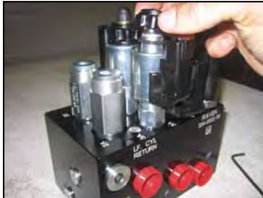
FIGURE 7. Bobine réinstallée sur la valve de l'AutoBoom
