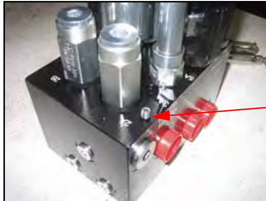
FIGURE 17. Orifices retirés de la valve de l'AutoBoom
