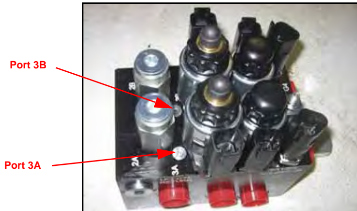
FIGURE 15. Emplacement des ports 3A et 3B
