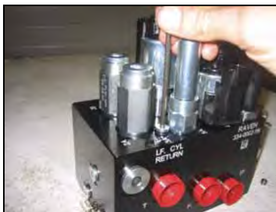
FIGURE 6. Bouchon de port réinstallé sur la valve de l'AutoBoom
