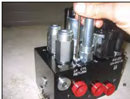
FIGURE 7. Bouchon de port réinstallé sur la valve de l'AutoBoom
