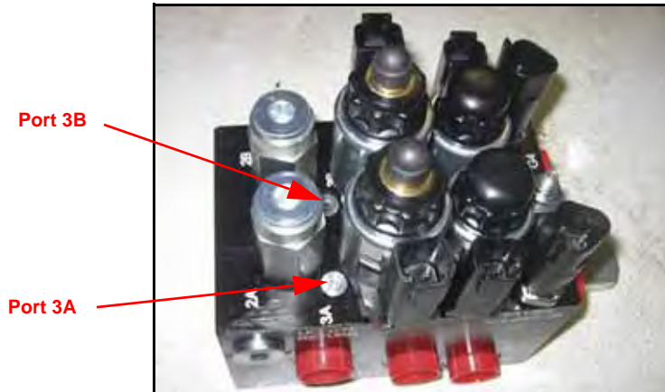
FIGURE 14. Emplacement des ports 3A et 3B
