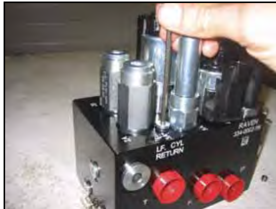
FIGURE 18. Bouchon de port réinstallé sur la valve de l'AutoBoom
