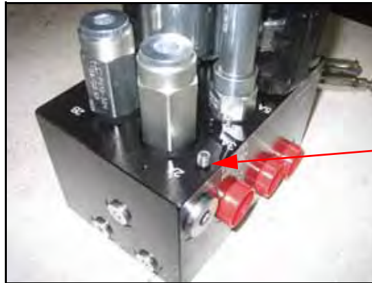
FIGURE 5. Accesorios de orificios removidos de la válvula AutoBoom
