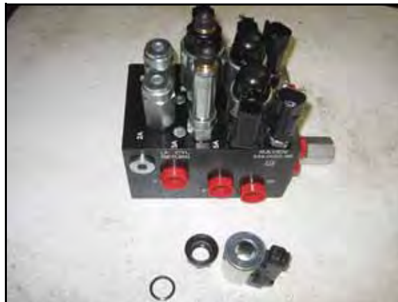
FIGURE 4. Bobina retirada de la válvula AutoBoom
