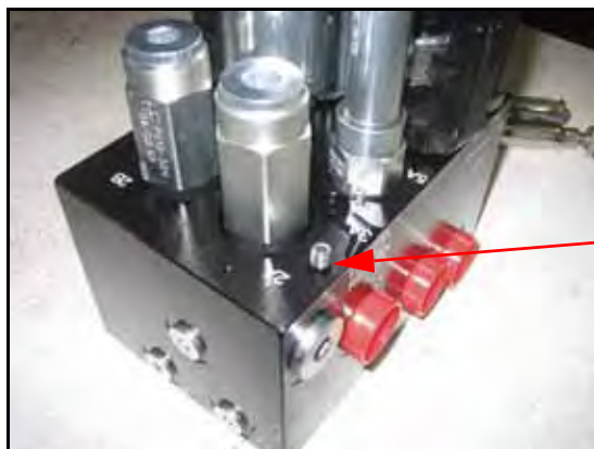
FIGURE 18. Accesorios de orificios removidos de la válvula AutoBoom
