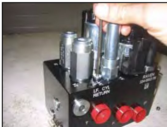
FIGURE 19. Ficha de puerto reinstalada en la válvula AutoBoom
