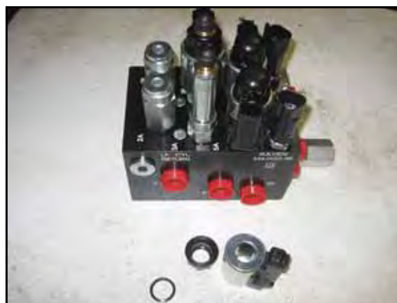
FIGURE 3. Bobina retirada de la válvula AutoBoom
