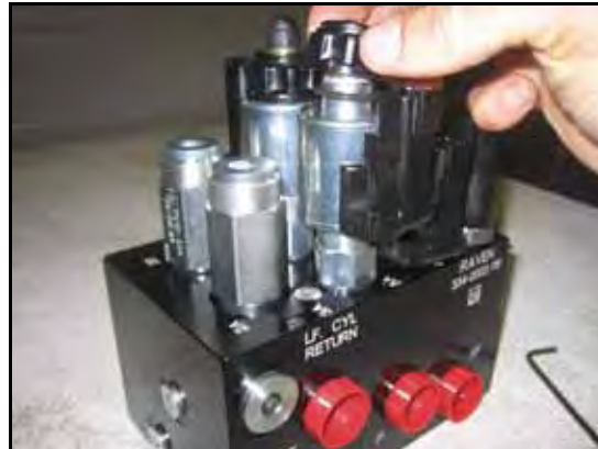
FIGURE 7. Bobina reinstalada en la válvula AutoBoom
