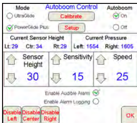
FIGURE 9. Viper Pro programado para funcionar en modo PowerGlide Plus
