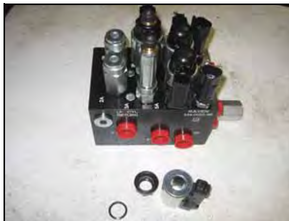
FIGURE 15. Bobina retirada de la válvula AutoBoom
