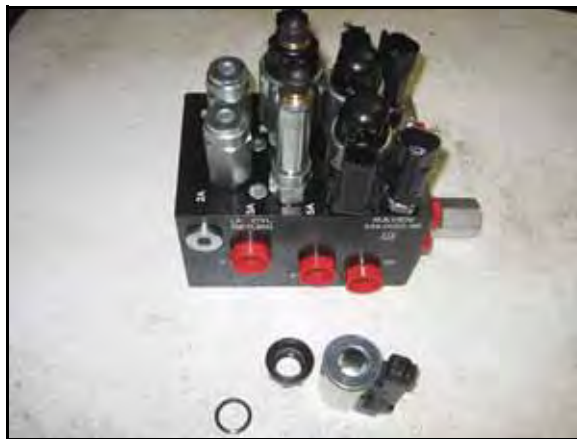
FIGURE 16. Bobina retirada de la válvula AutoBoom
