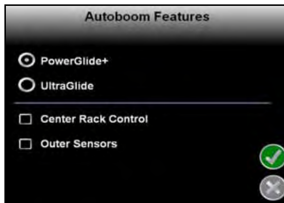
FIGURE 20. Envizio Pro programado para funcionar en modo PowerGlide Plus
