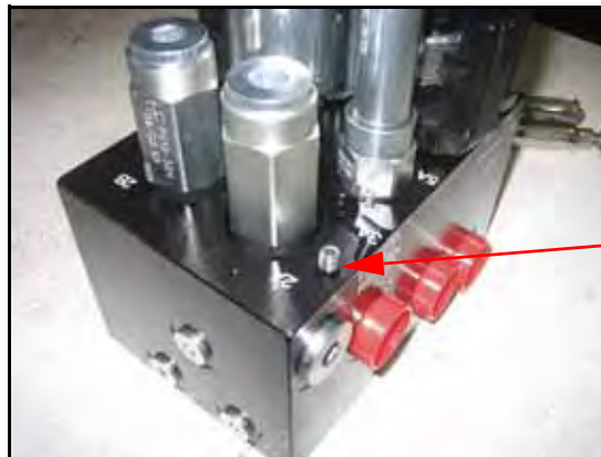
FIGURE 6. Accesorios de orificios removidos de la válvula AutoBoom
