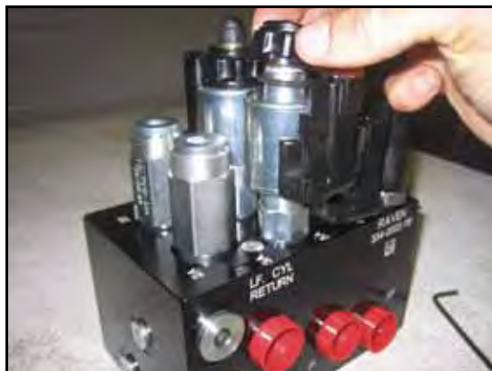
FIGURE 8. Bobina reinstalada en la válvula AutoBoom
