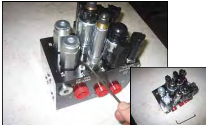
FIGURE 17. Fichas de puertos removidas de la válvula AutoBoom
