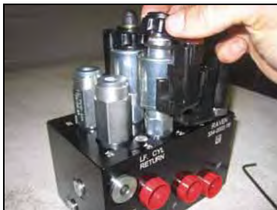
FIGURE 20. Bobina reinstalada en la válvula AutoBoom
