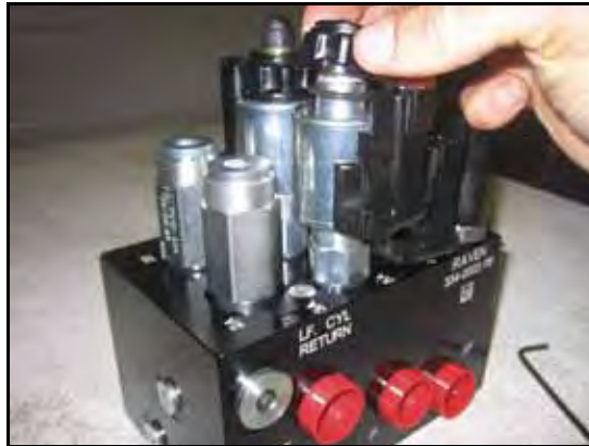
FIGURE 19. Bobina reinstalada en la válvula AutoBoom
